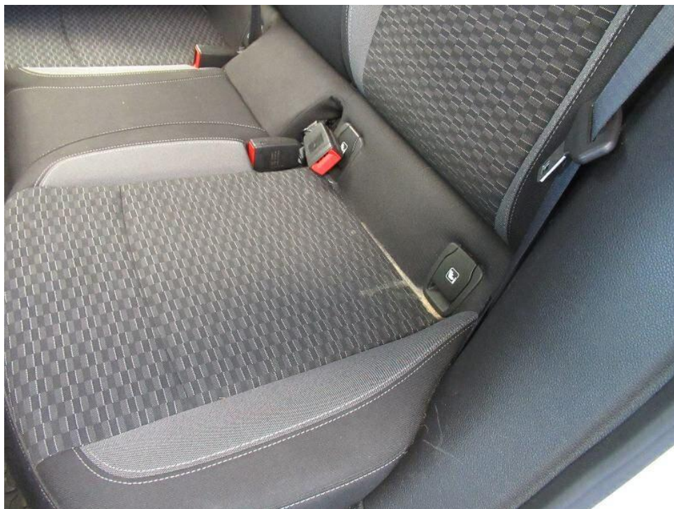
Bild 31 : Polster, Teppiche, Verkleidungen, ..... stark verschmutzt. Geruch im Fahrzeug: Desinfektion und Ozonbehandlung.
