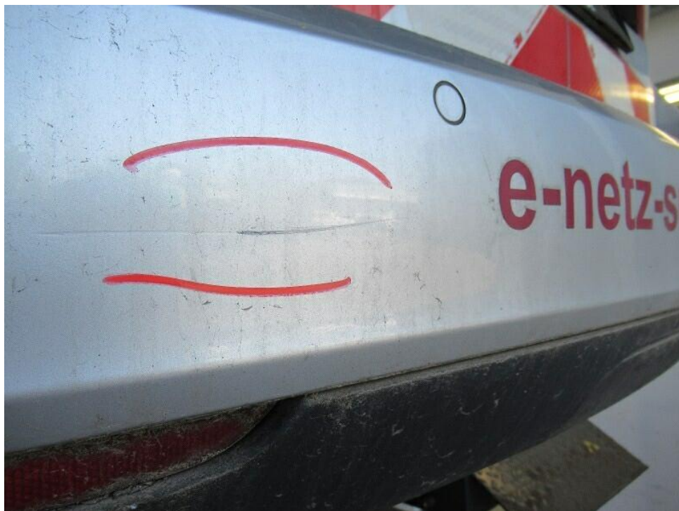
Bild 18 : Stoßfänger hinten Lackierung, zerkratzt, lackieren mit Lackaufbau
