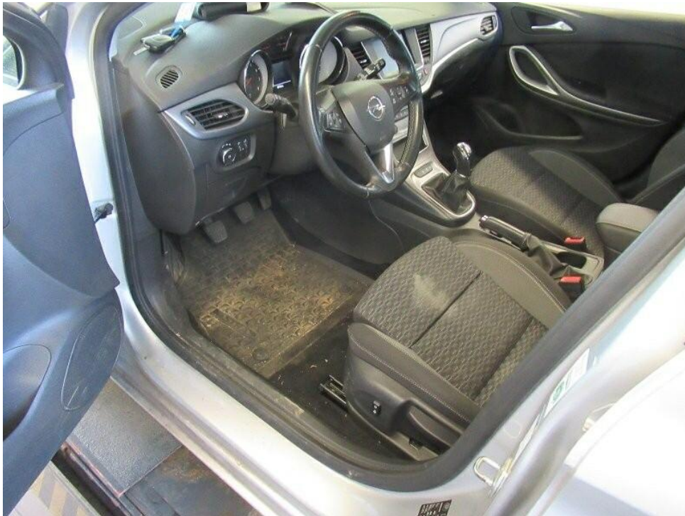
Bild 27 : Polster, Teppiche, Verkleidungen, ..... stark verschmutzt. Geruch im Fahrzeug: Desinfektion und Ozonbehandlung.
