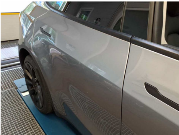
Beschädigung #5: Tür hinten rechts: Tür (Lackeinschlüsse) - nicht fachgerecht instandgesetzt - instandsetzen und lackieren
