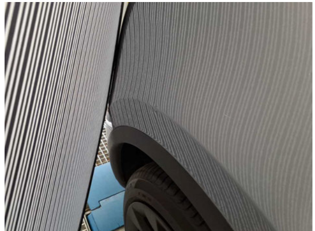
Beschädigung #4: Seitenwand rechts: Seitenwand - Delle / Lackschaden - instandsetzen und lackieren
