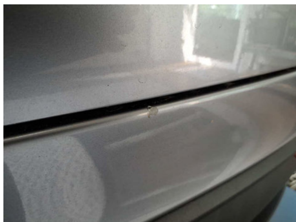
Beschädigung #2: Stossfänger hinten: Stossfänger hinten - Kratzer - lackieren
