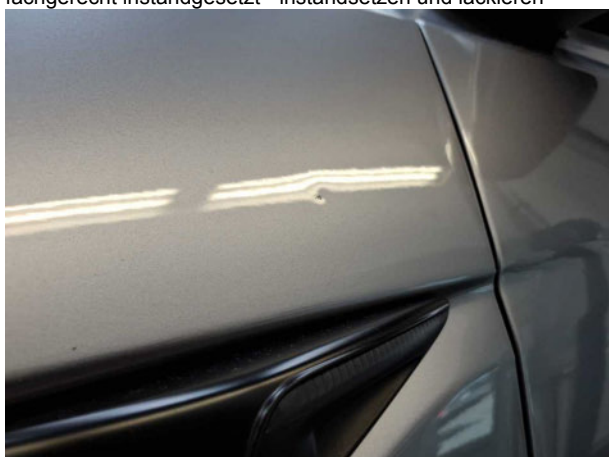
Beschädigung #6: Kotflügel links: Kotflügel links - Delle / Lackschaden... - instandsetzen und lackieren
