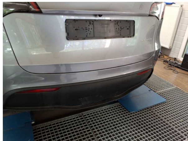
Beschädigung #2: Stossfänger hinten: Stossfänger hinten - Kratzer - lackieren
