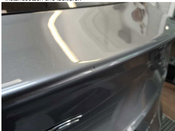
Beschädigung #7: Heckklappe/-tür: Heckklappe - Delle / Lackschaden - instandsetzen und lackieren
