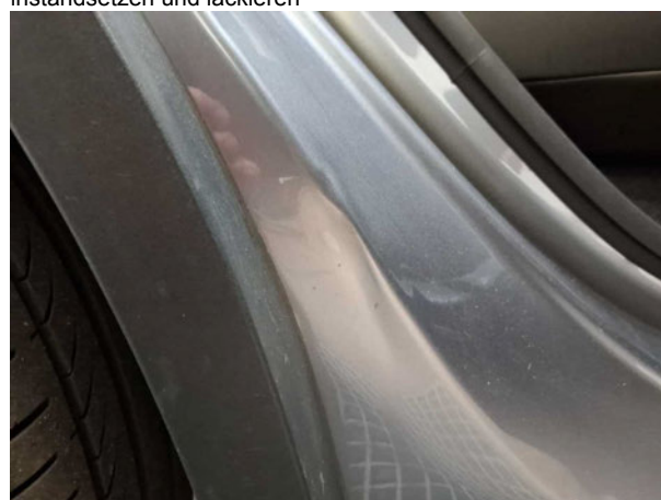
Beschädigung #3: Seitenwand rechts: Einstieg - beschädigt - instandsetzen und lackieren
