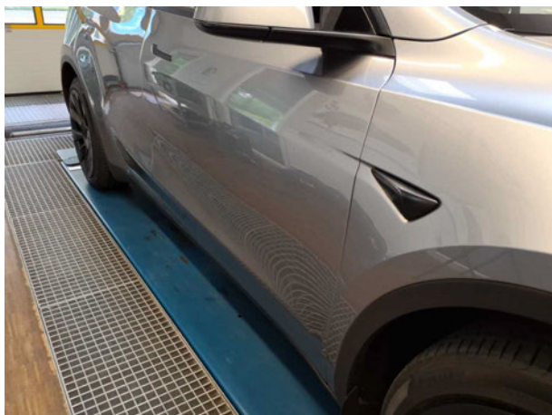
Beschädigung #8: Tür vorn rechts: Tür (Orangenhaut) - nicht fachgerecht instandgesetzt - instandsetzen und lackieren
