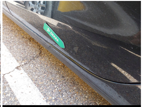
Puerta / Trasero Izquierdo / Abolladura
