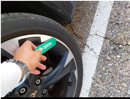
Llanta / Delantero Izquierdo / Ralladura
