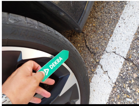
Neumático / Delantero Izquierdo / Desgarro
