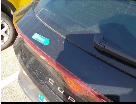
Portón trasero / puerta del maletero / - / Abolladura
