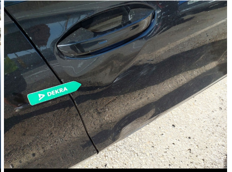
Puerta / Delantero Derecho / Abolladura
