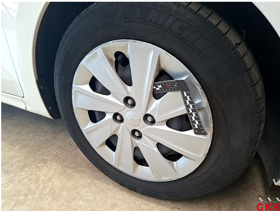
Bild 36. Radkappe(n), vorne rechts, verkratzt, ersetzen
