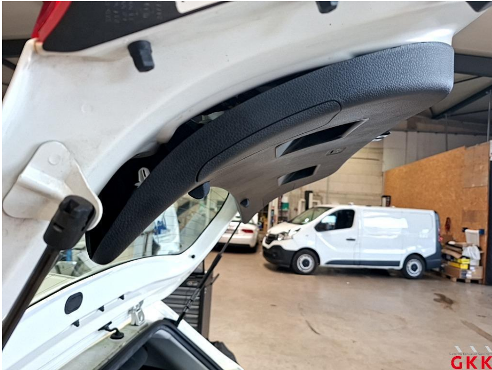
Bild 13. Heckklappe, Innenverkleidung, lose, instand setzen
