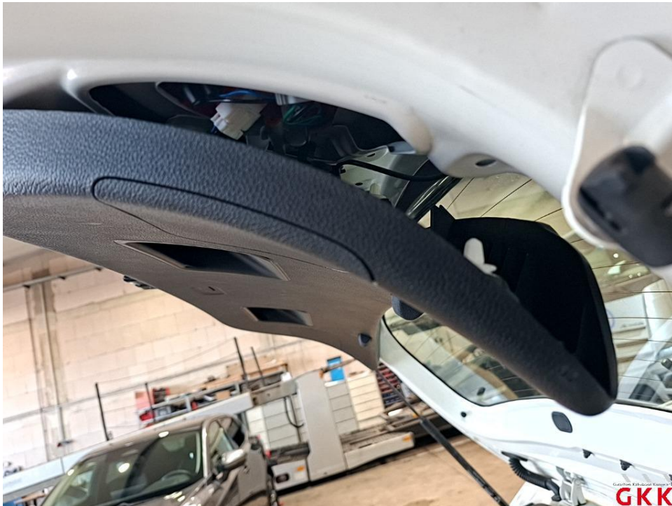
Bild 14. Heckklappe, Innenverkleidung, lose, instand setzen
