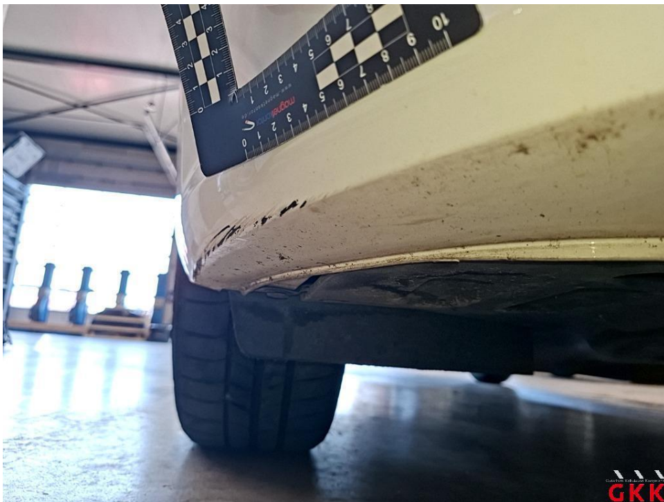
Bild 18. Stoßfänger vorne, Verkleidung -lackiert-, verkratzt, lackieren
