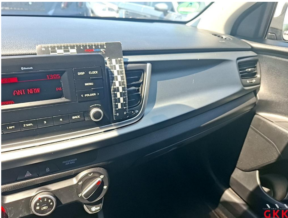
Bild 40. Armaturenbrett, Blende, verkratzt, Smartrepair
