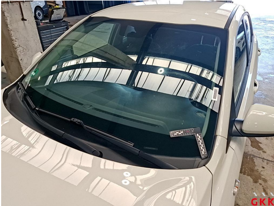
Bild 15. Frontscheibe, Steinschlag mit Rissbildung, ersetzen
