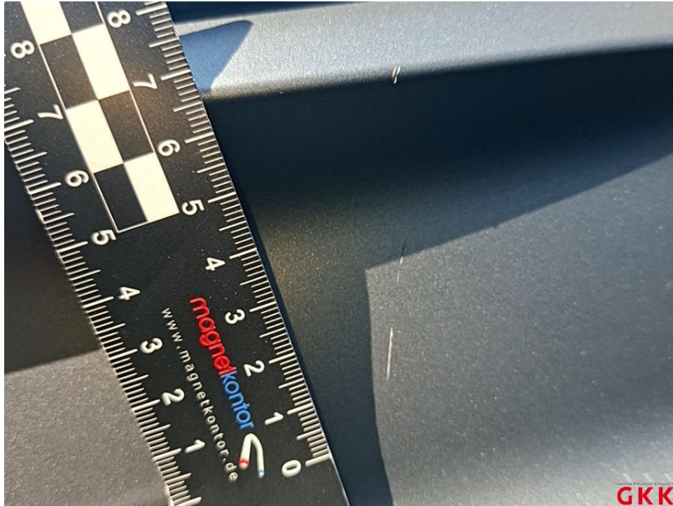
Bild 41. Armaturenbrett, Blende, verkratzt, Smartrepair
