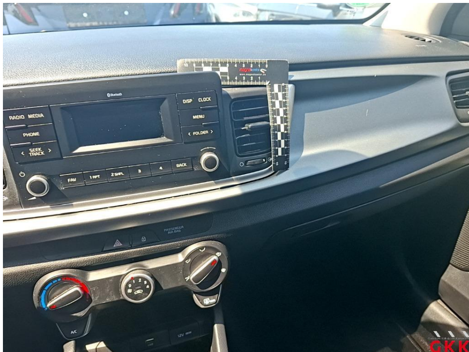
Bild 42. Armaturenbrett, Blende, verkratzt, Smartrepair
