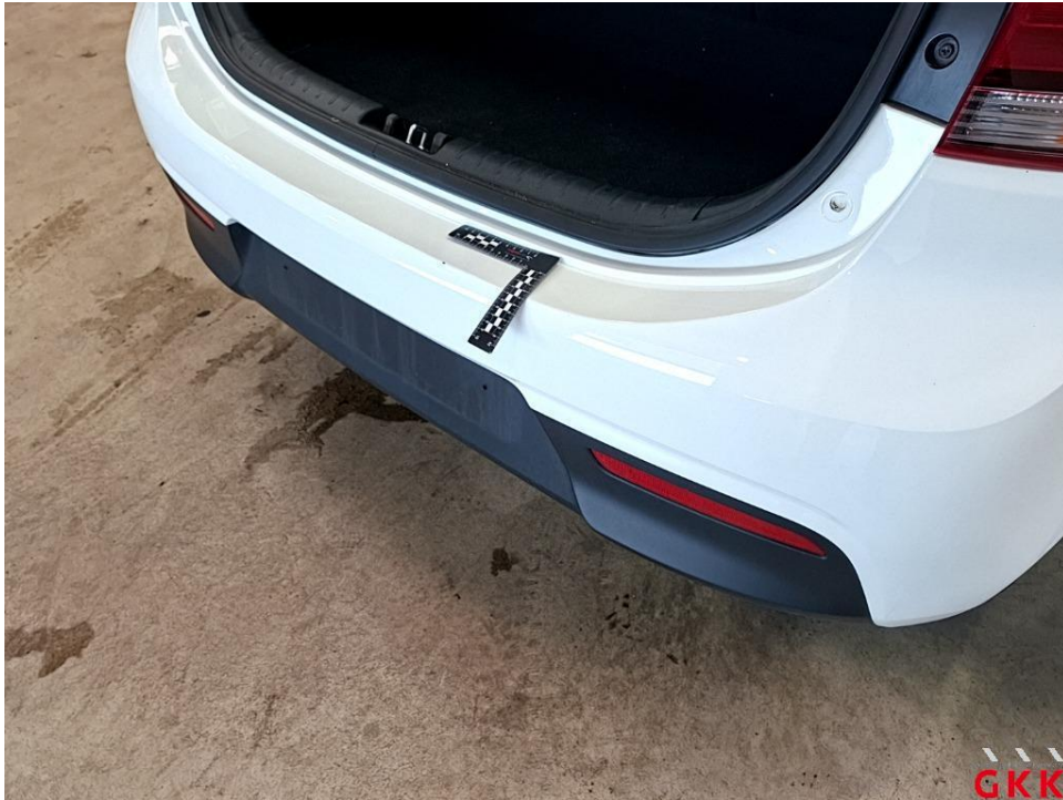
Bild 27. Stoßfänger hinten, Verkleidung -lackiert-, verkratzt, auslegen, schleifen, polieren
