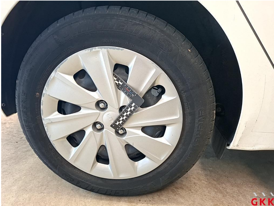
Bild 29. Radkappe(n), hinten rechts, verkratzt, ersetzen
