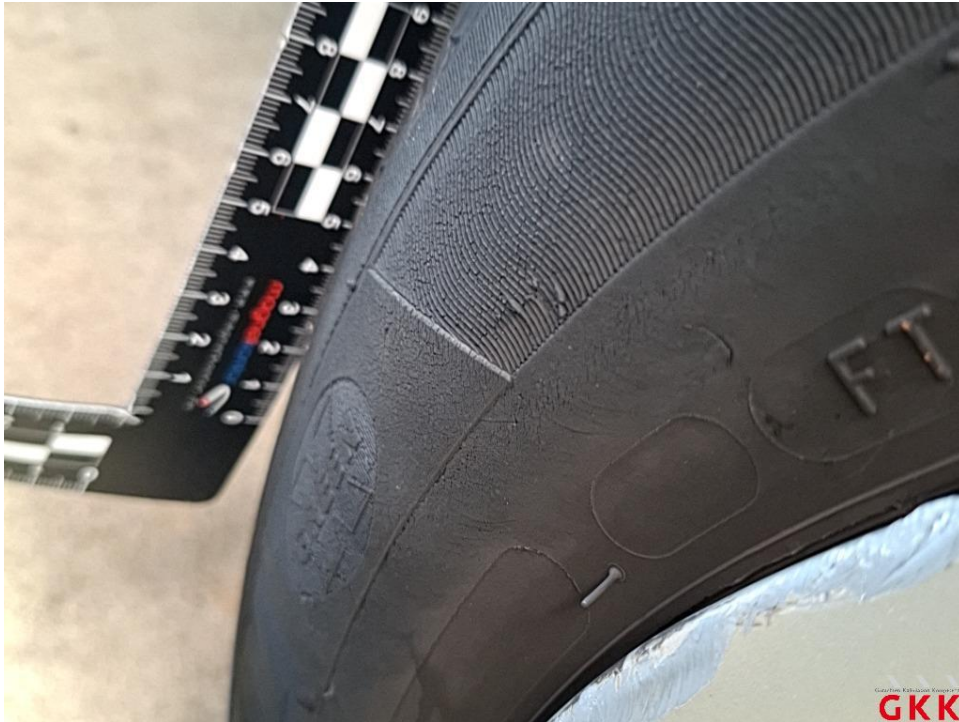
Bild 39. Reifen, vorne rechts, beschädigt, ersetzen
