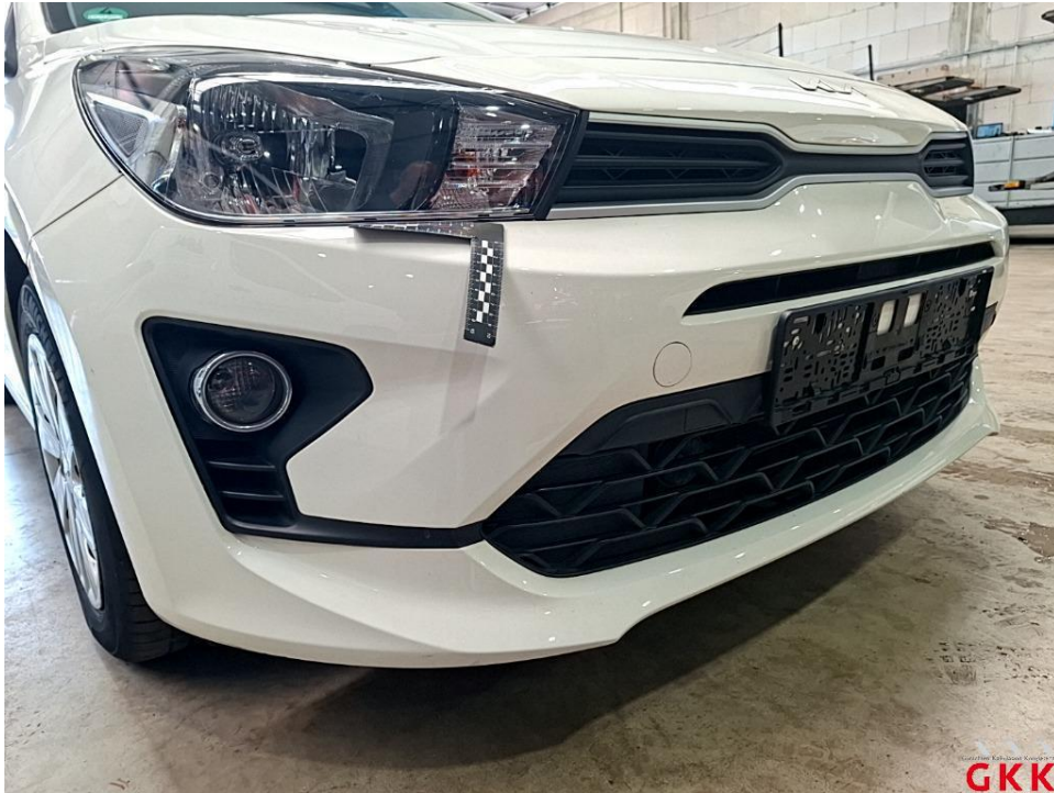
Bild 17. Stoßfänger vorne, Verkleidung -lackiert-, verkratzt, lackieren
