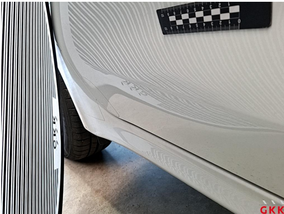
Bild 32. Fahrzeug, Seite rechts, Unfallschaden, Unfallschaden beheben
