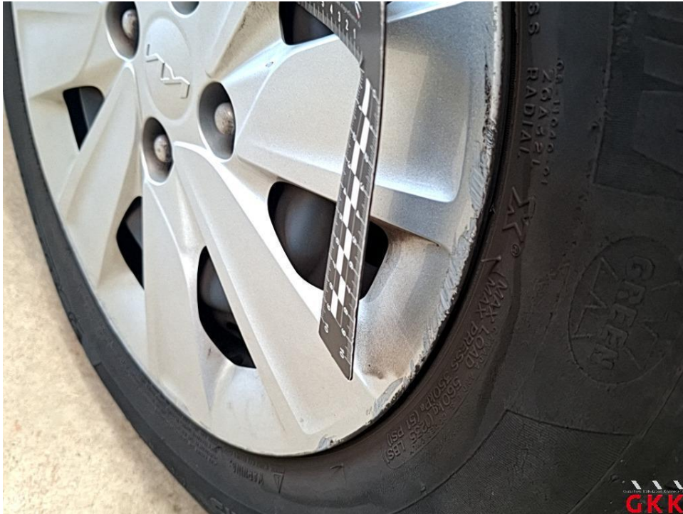
Bild 37. Radkappe(n), vorne rechts, verkratzt, ersetzen
