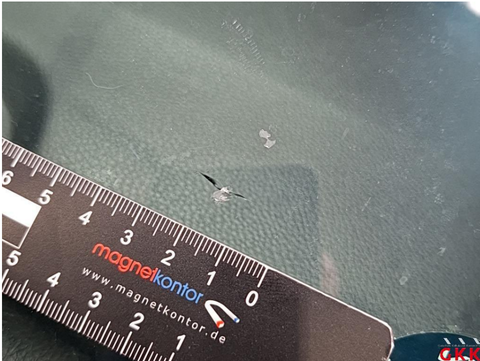
Bild 16. Frontscheibe, Steinschlag mit Rissbildung, ersetzen
