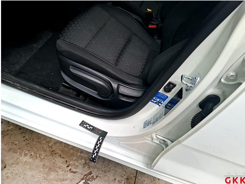
Bild 23. Tür vorne links, Einstieg, beschädigt, instand setzen - lackieren
