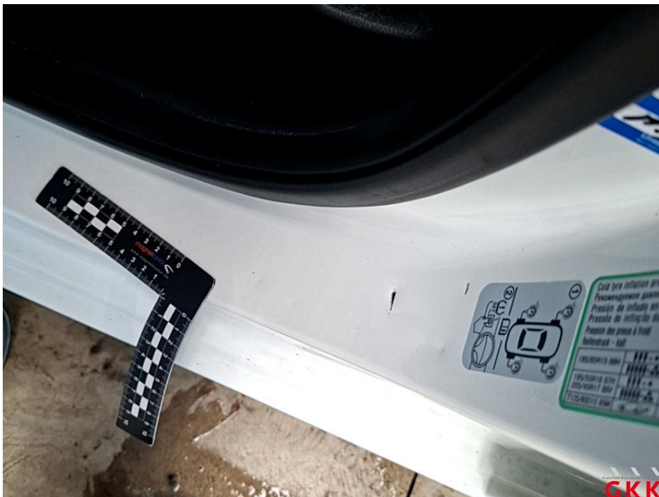
Bild 24. Tür vorne links, Einstieg, beschädigt, instand setzen - lackieren
