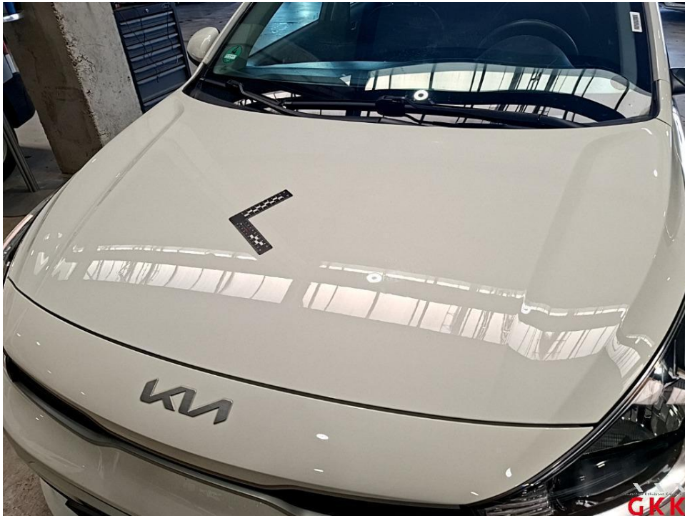
Bild 20. Motorhaube, Lackierung verätzt, lackieren
