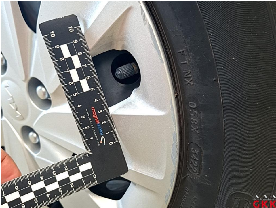
Bild 30. Radkappe(n), hinten rechts, verkratzt, ersetzen
