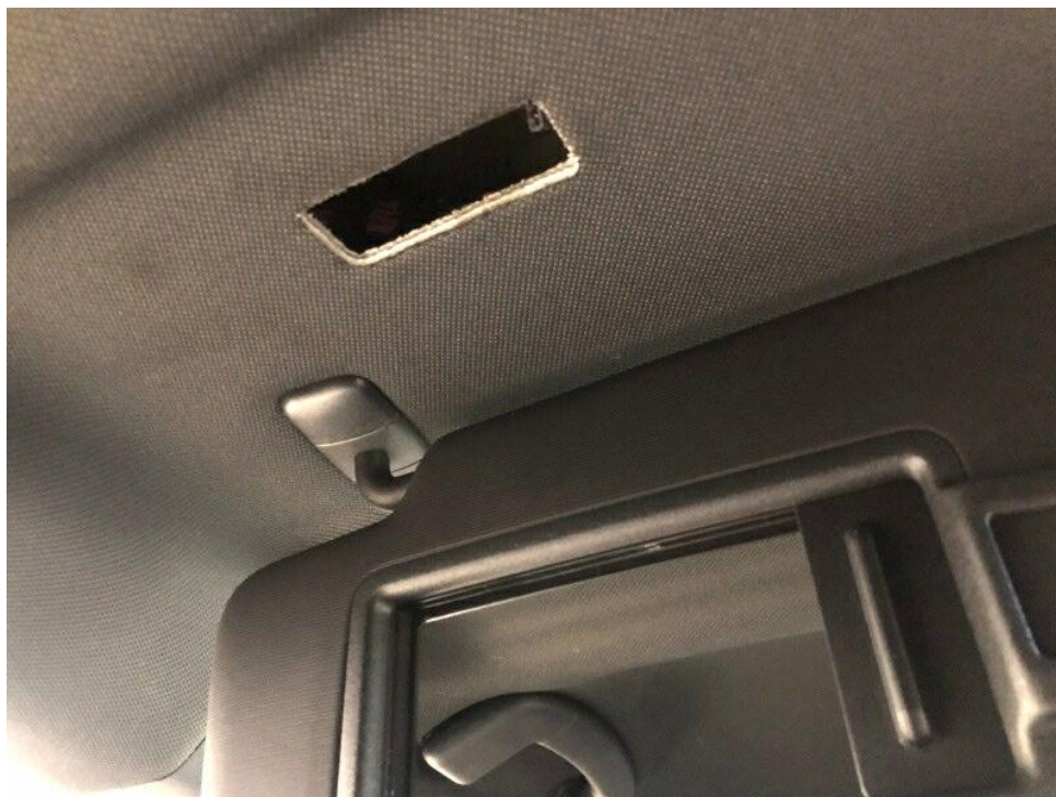
Bild 13 : Lampe Sonnenblende vorne links fehlt (Schadenerweiterung möglich)
