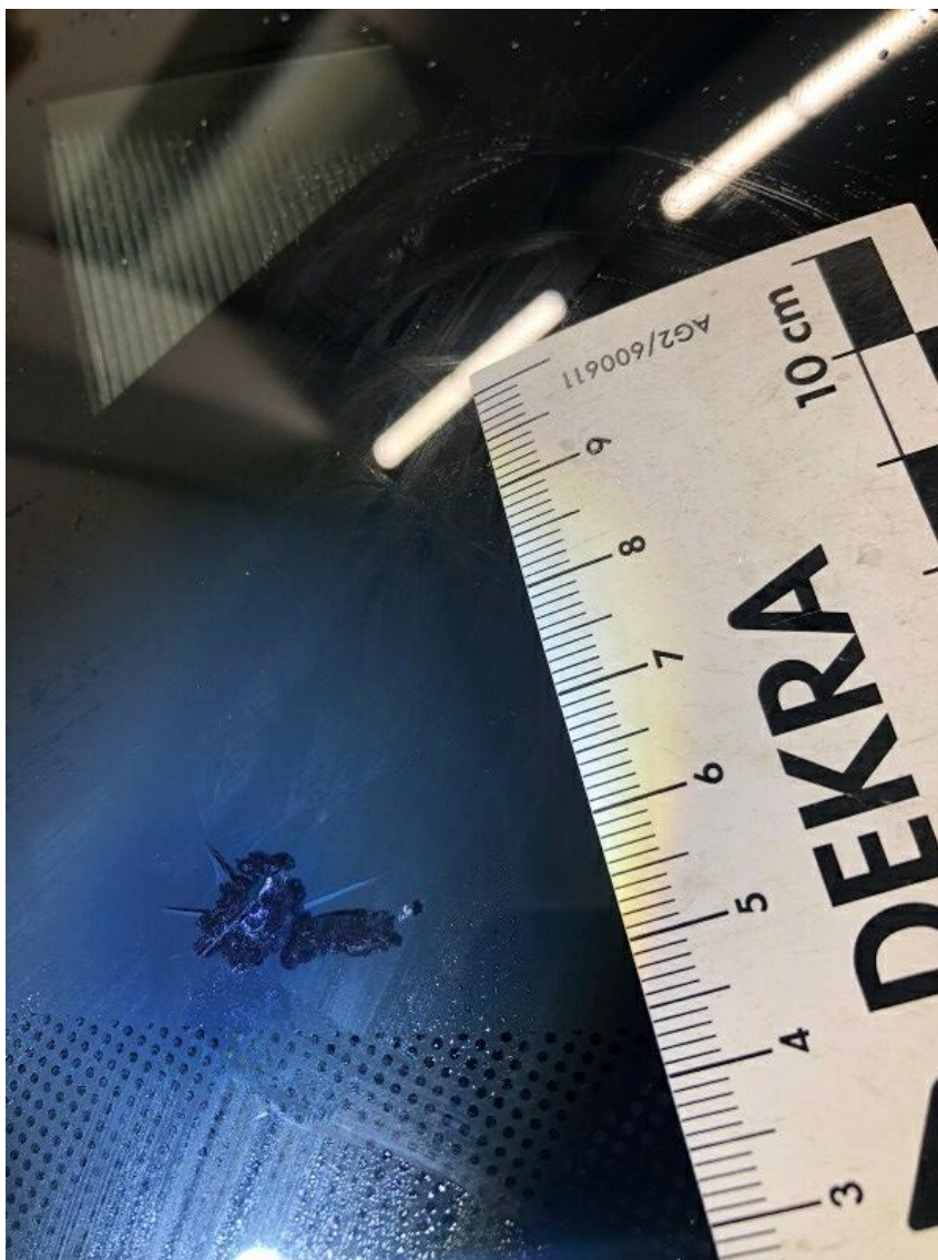
Bild 15 : Frontscheib Steinschlag / Riss
