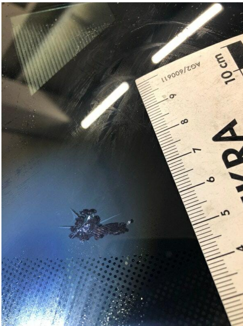
Bild 16 : Frontscheib Steinschlag / Riss
