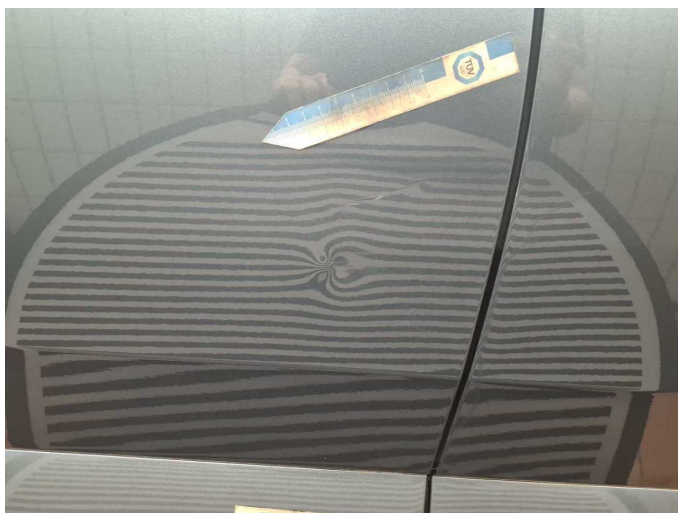
Damage 22: Door - rear right side: Door (+ Zierleiste verschürft - lackieren) - Dent / paintcoat damage - Repair and paint
