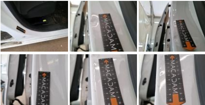
Panneau ARG, Mauvaise réparation, Peindre
