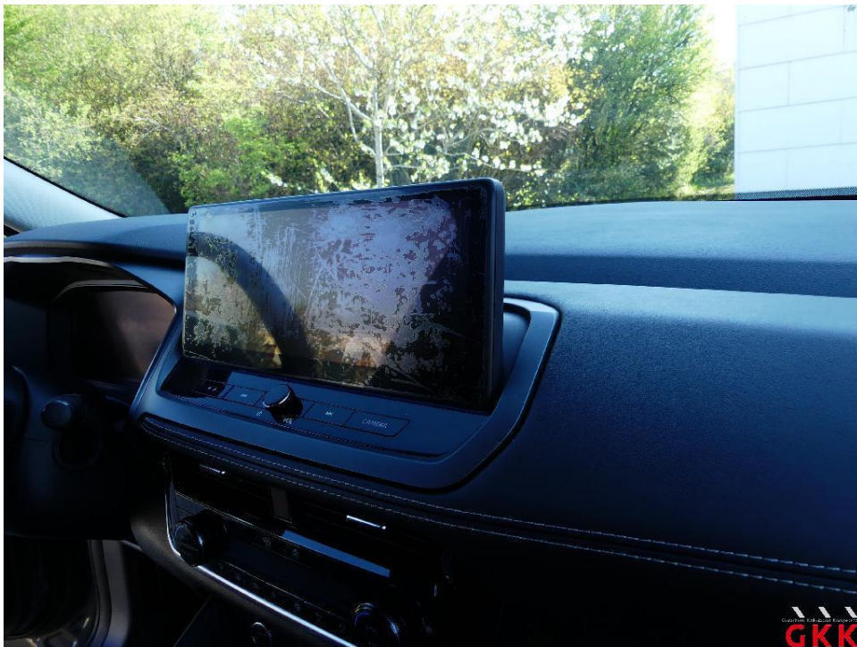
Bild 22 Radio - Display, beschädigt, prüfen
