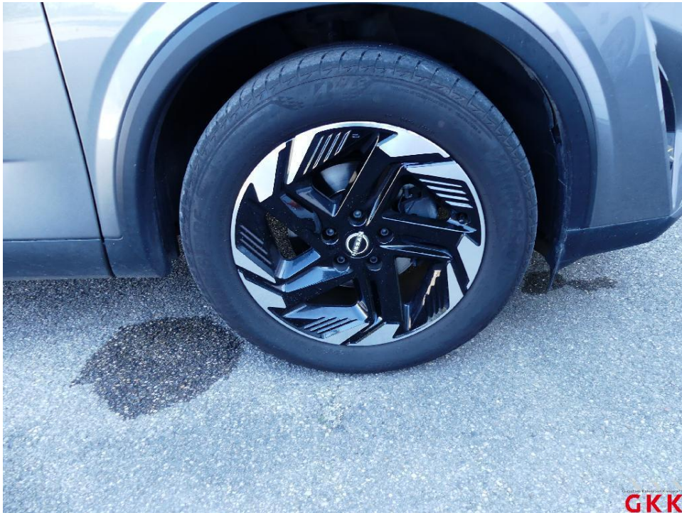
Bild 15 LM-Rad, vorne rechts, Materialabtrag, Minderwert
