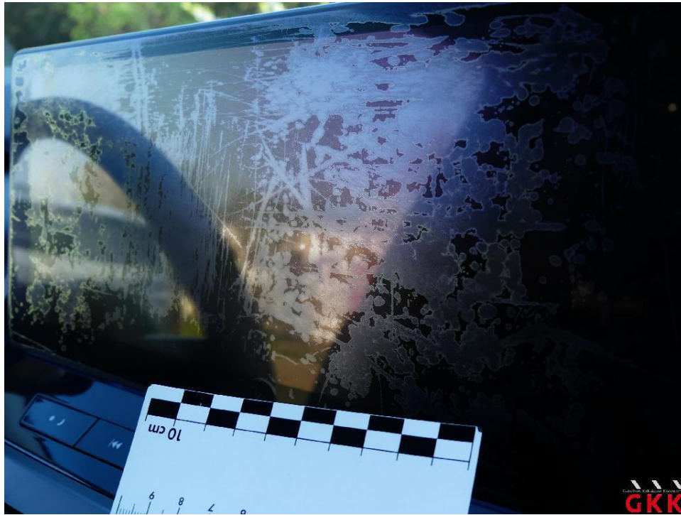
Bild 23 Radio - Display, beschädigt, prüfen
