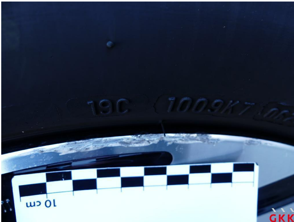
Bild 16 LM-Rad, vorne rechts, Materialabtrag, Minderwert
