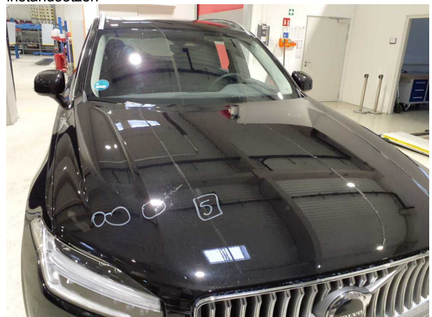
Beschädigung #7: Karosserie: Karosserie - Hagelschaden - instandsetzen
