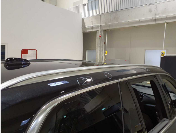
Beschädigung #7: Karosserie: Karosserie - Hagelschaden - instandsetzen
