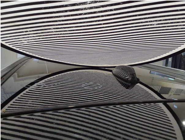
Beschädigung #7: Karosserie: Karosserie - Hagelschaden - instandsetzen
