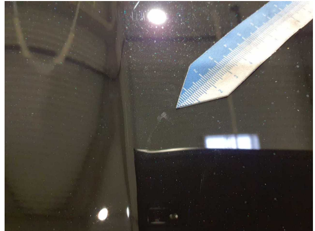
Beschädigung #7: Karosserie: Karosserie - Hagelschaden - instandsetzen
