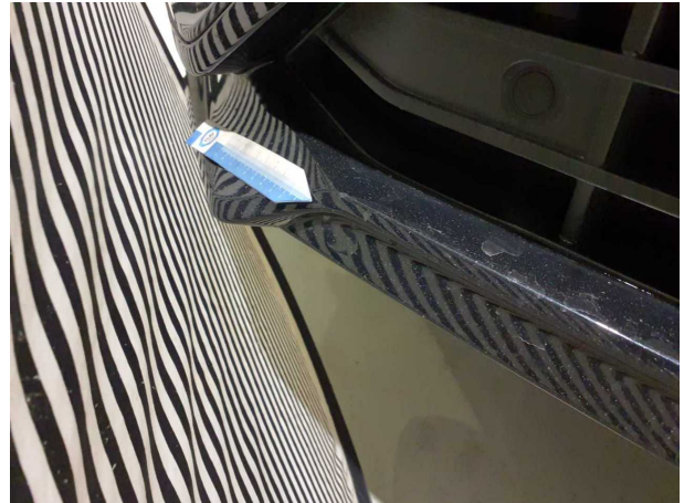
Beschädigung #5: Stossfänger vorn: Spoiler (Druckstelle) - Delle / Lackschaden - Smart Repair
