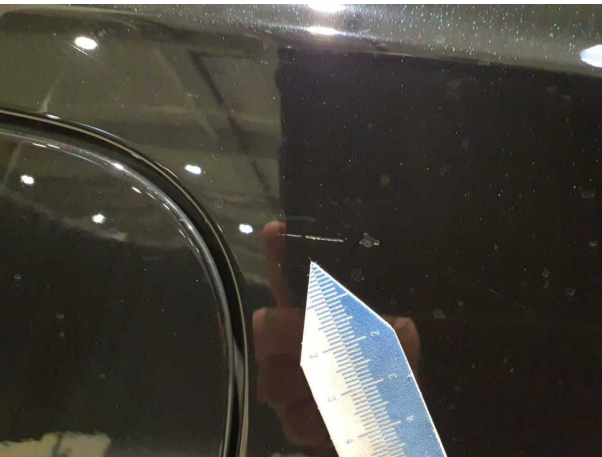
Beschädigung #2: Seitenwand rechts: Seitenwand - Kratzer - Smart Repair
