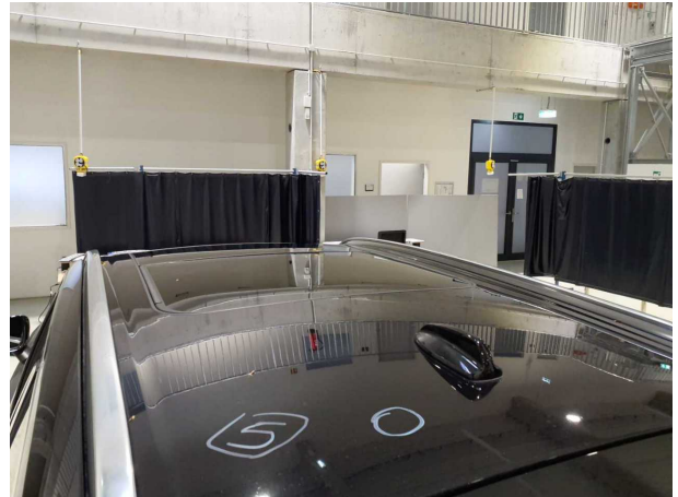
Beschädigung #7: Karosserie: Karosserie - Hagelschaden - instandsetzen
