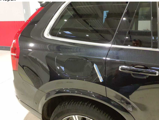
Beschädigung #2: Seitenwand rechts: Seitenwand - Kratzer - Smart Repair
