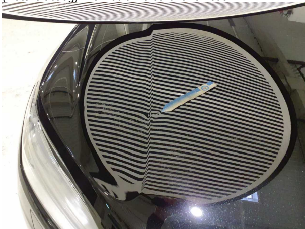
Beschädigung #7: Karosserie: Karosserie - Hagelschaden - instandsetzen
