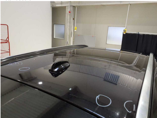
Beschädigung #7: Karosserie: Karosserie - Hagelschaden - instandsetzen
