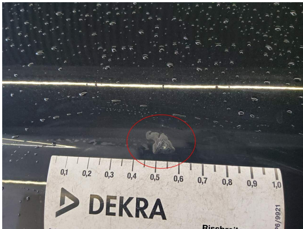
Bild 17 : Tür hinten rechts, Lackierung, Umweltschaden, entfernen
