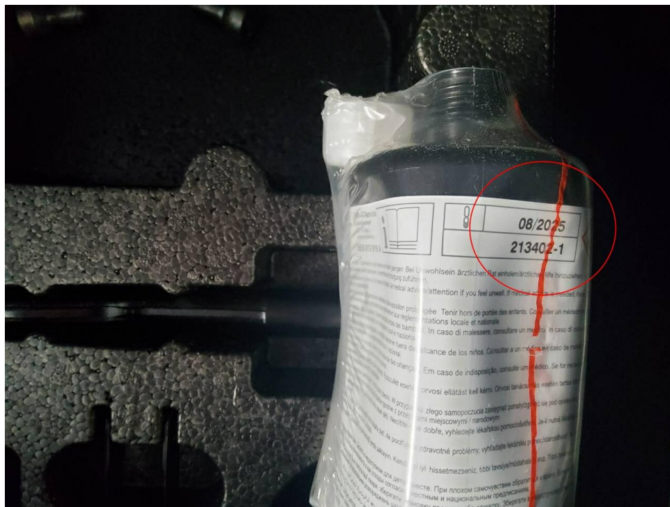
Bild 14 : Füllflasche Pannenset, abgelaufen (08/2025)
