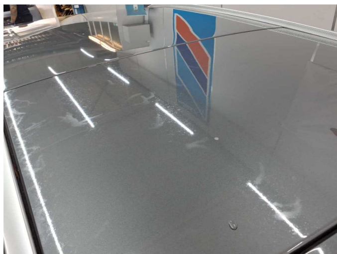
Damage 7: Roof: Roof (Verätzungen) - Paint defect - Paint
