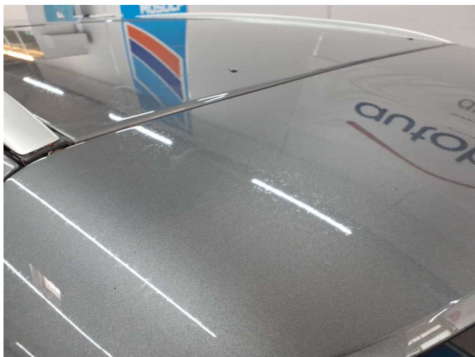
Damage 6: Boot lid / rear door: Rear spoiler (Verätzungen) - Paint defect - Paint
