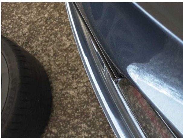
Beschädigung #2: Heckklappe/-tür: Heckklappe (Zierleiste) - lose - befunden ggf. instandsetzen
