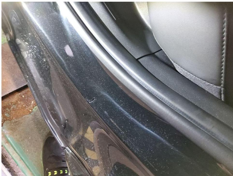
Bild 7 : Türeinstieg hinten links Kratzer
