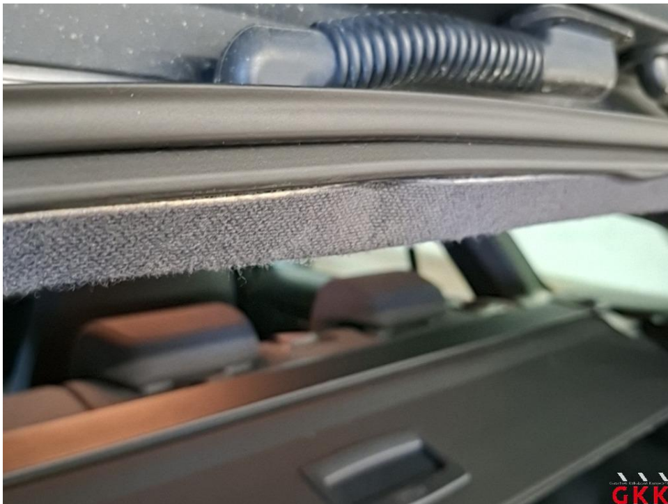
Bild 26 Himmel, hinten, Druckstellen, Smartrepair
