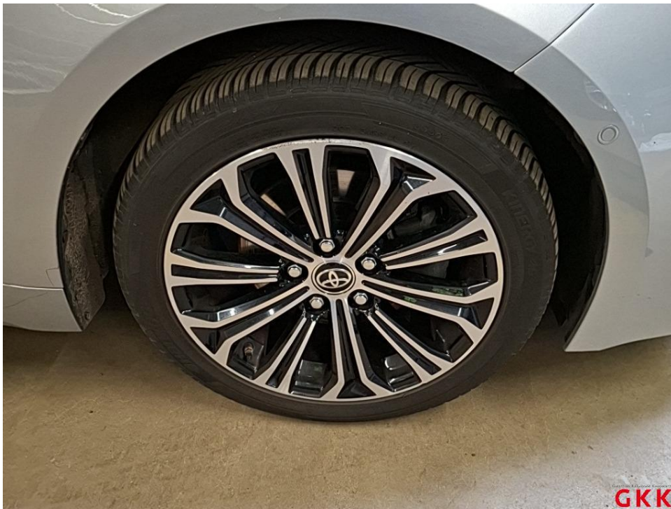
Bild 18 LM-Rad, vorne rechts, verkratzt, ersetzen
