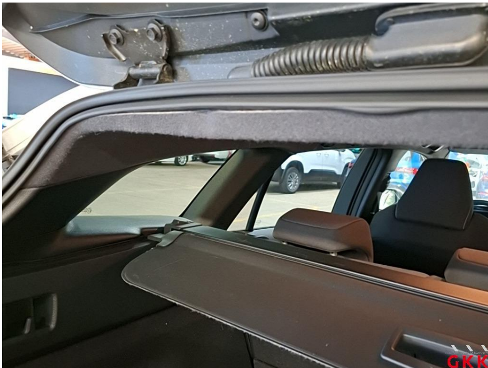
Bild 24 Himmel, hinten, Druckstellen, Smartrepair
