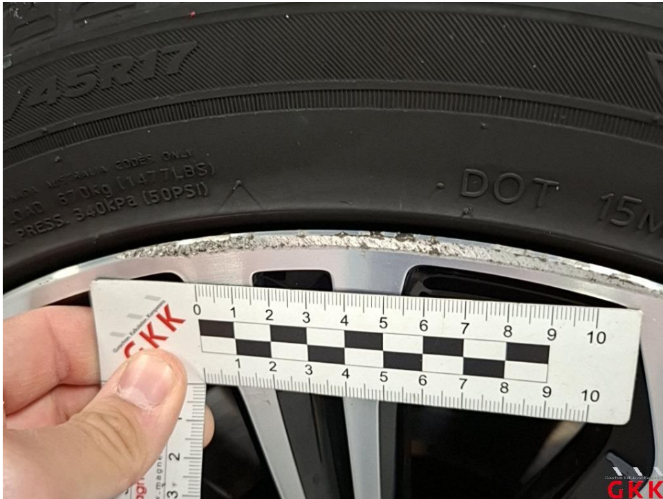
Bild 19 LM-Rad, vorne rechts, verkratzt, ersetzen
