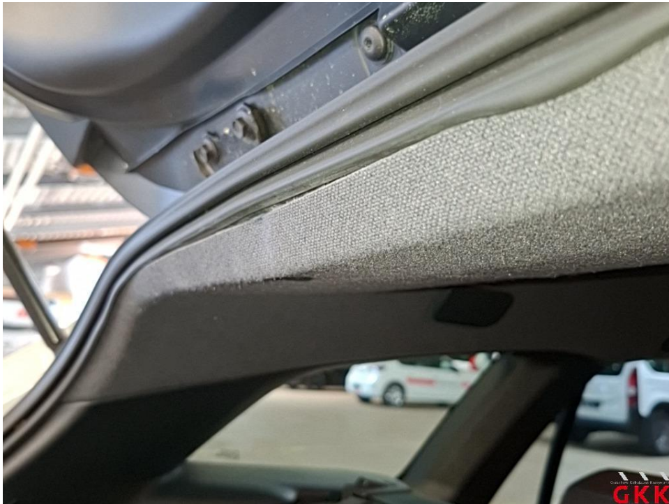
Bild 25 Himmel, hinten, Druckstellen, Smartrepair
