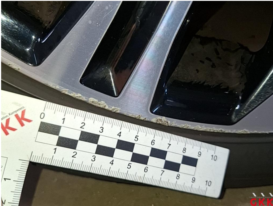
Bild 15 LM-Rad, vorne links, verkratzt, ersetzen
