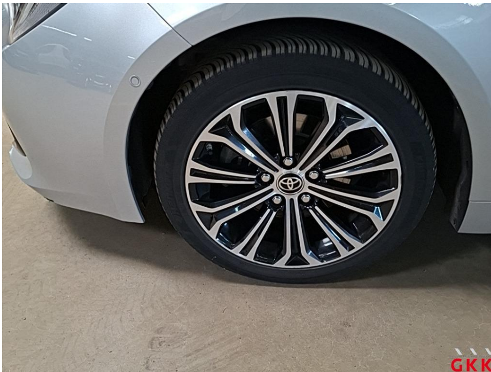
Bild 14 LM-Rad, vorne links, verkratzt, ersetzen
