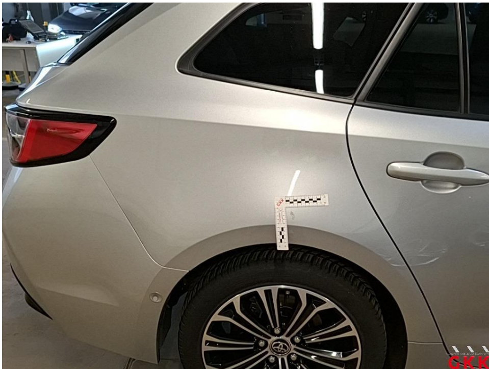
Bild 20 Seitenwand rechts, Harzhaftungen/-rückstände, aufbereiten
