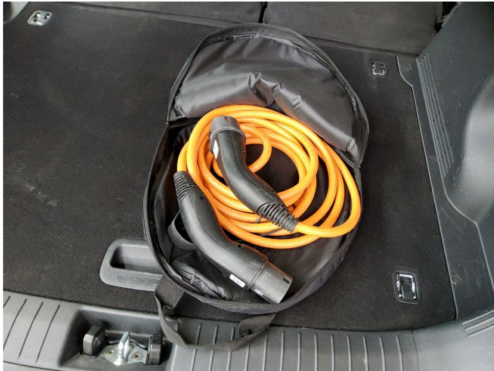
Bild 7 : Ladekabel beim E-Fahrzeug
