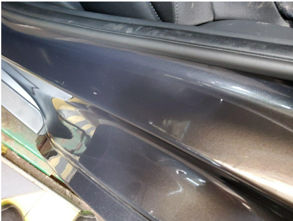
Bild 10 : Türeinstieg hinten links Kratzer
