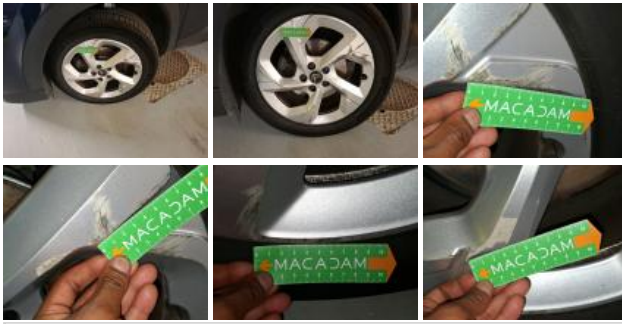
Alloy rim RL, Scratch(es), Repair/replace (lump sum)
