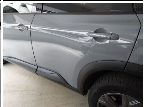
Tür / Hinten Links / Delle
