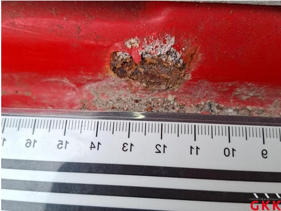
Bild 25. Heckblech, korrodiert, instand setzen - lackieren
