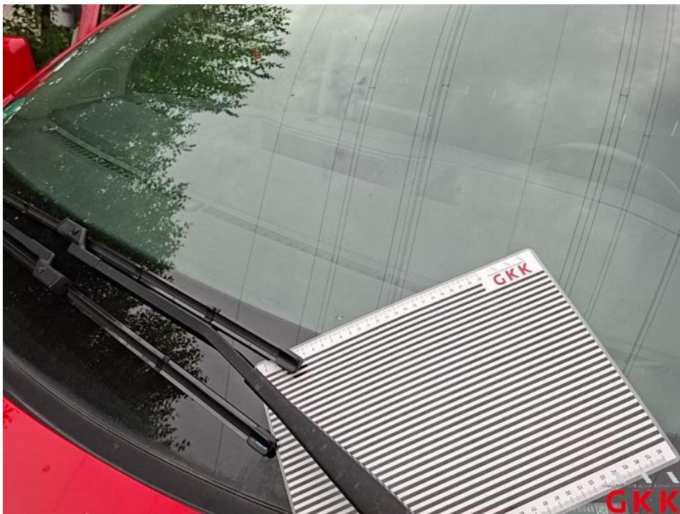
Bild 16. Frontscheibe, beheizt, Steinschlag, ersetzen
