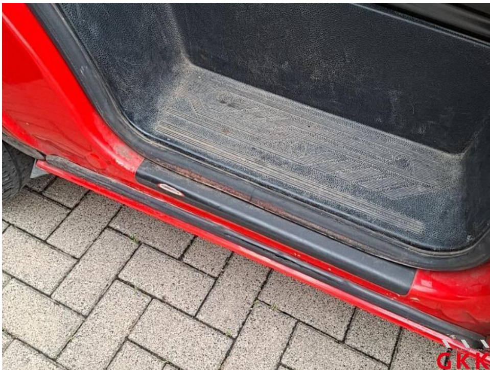
Bild 20. Tür vorne links, Einstieg, verkratzt, lackieren
