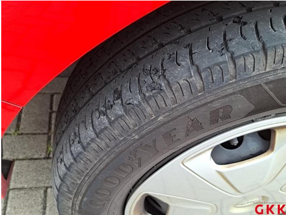
Bild 47. Reifen, vorne rechts, beschädigt, ersetzen
