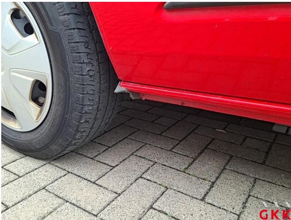
Bild 18. Kotflügel vorne links, Schmutzfänger, abgerissen, ersetzen
