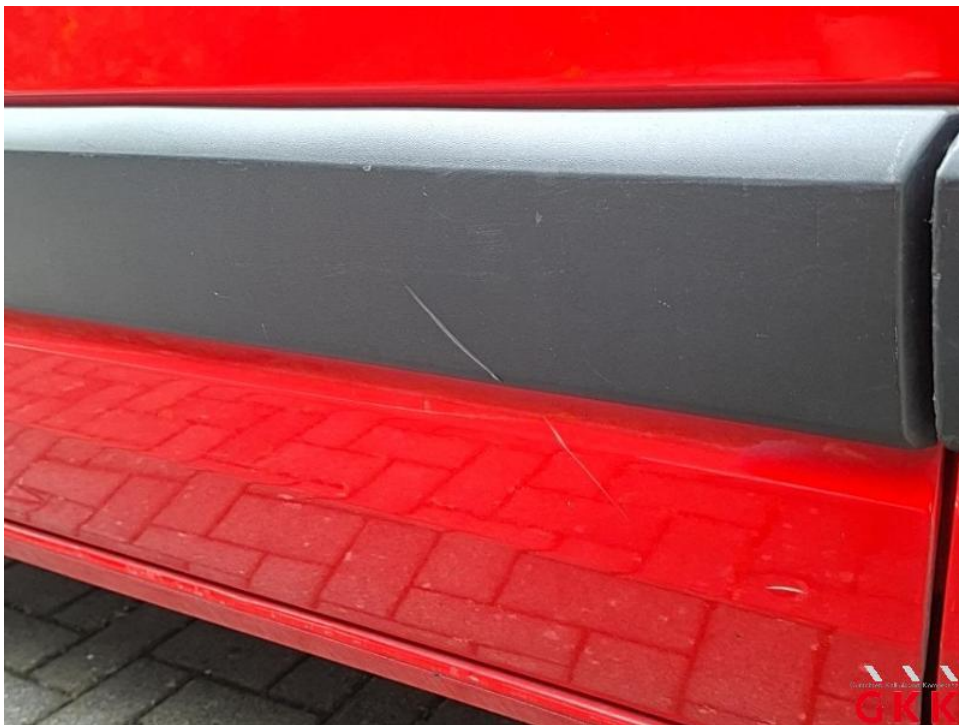
Bild 32. Schiebetür rechts, Leiste -unten-, verkratzt, ersetzen
