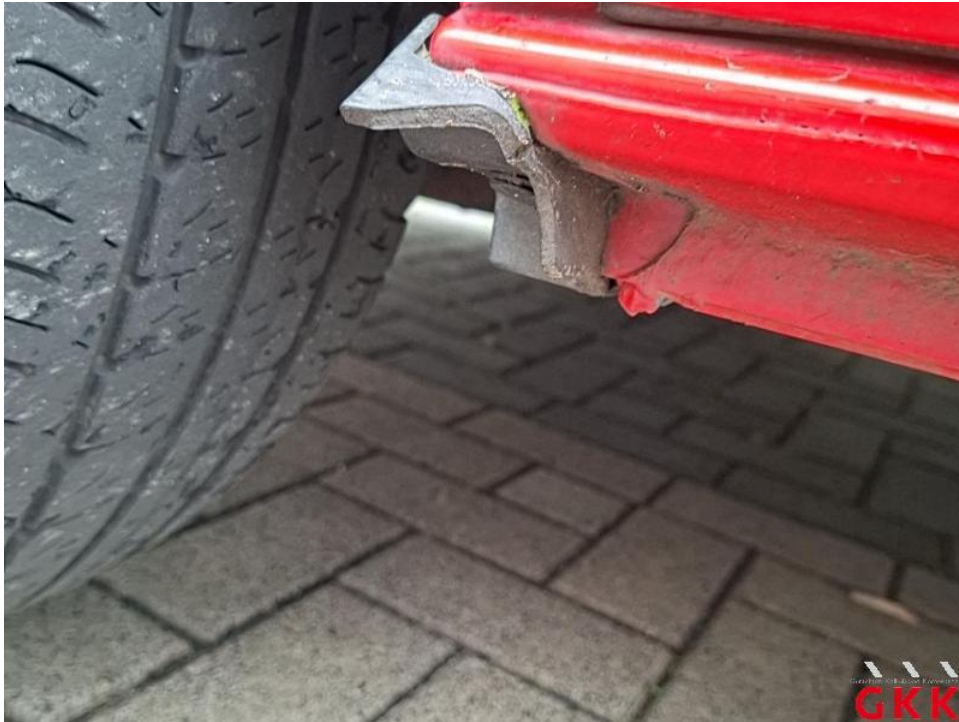
Bild 19. Kotflügel vorne links, Schmutzfänger, abgerissen, ersetzen
