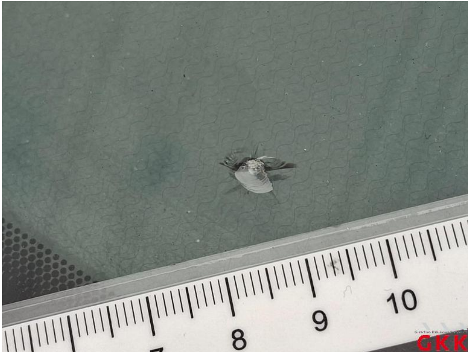
Bild 17. Frontscheibe, beheizt, Steinschlag, ersetzen
