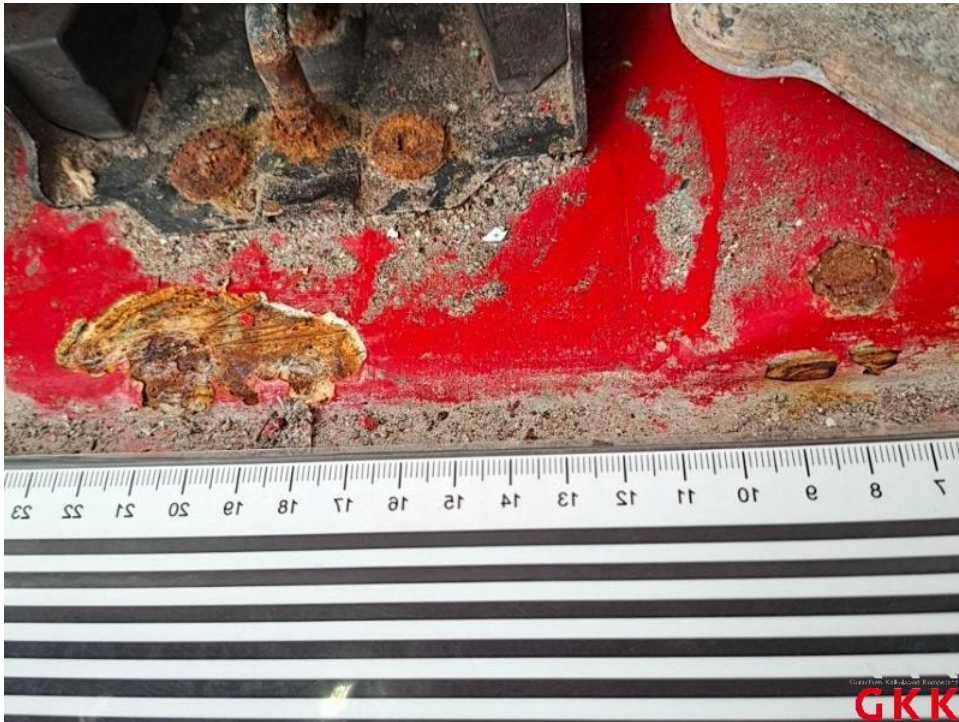
Bild 26. Heckblech, korrodiert, instand setzen - lackieren
