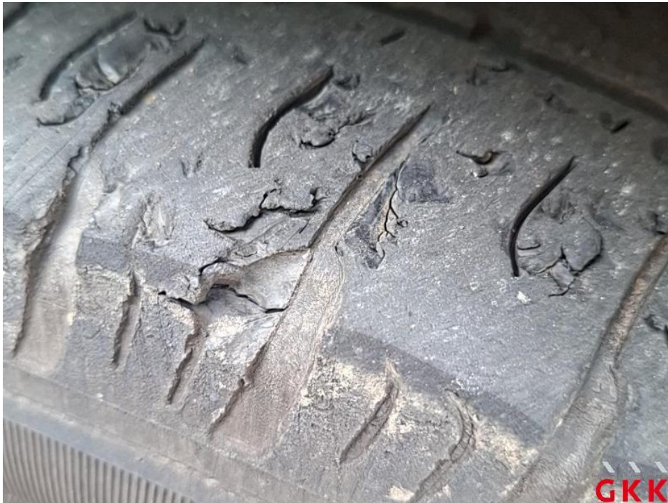
Bild 46. Reifen, vorne links, beschädigt, ersetzen
