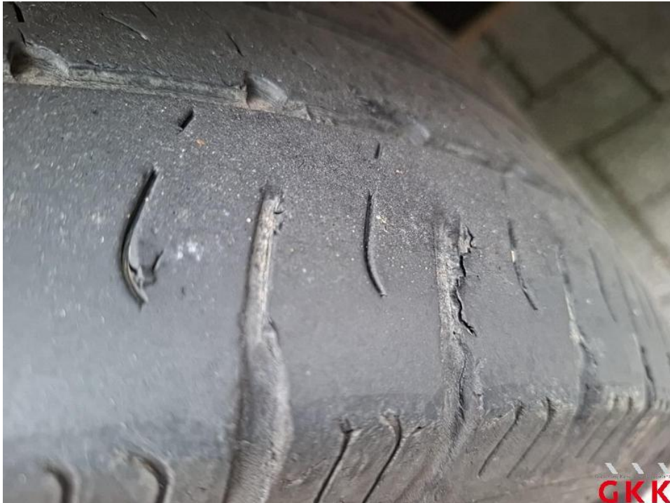
Bild 43. Reifen, hinten rechts, beschädigt, ersetzen
