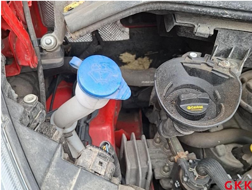
Bild 14. Motorraum, Dämmmatte, beschädigt, ersetzen
