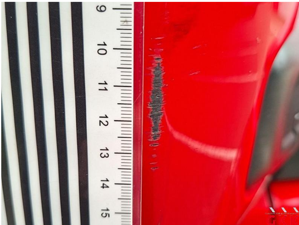
Bild 40. Spiegelgehäuse rechts, Kappe -lackiert-, gerissen, ersetzen
