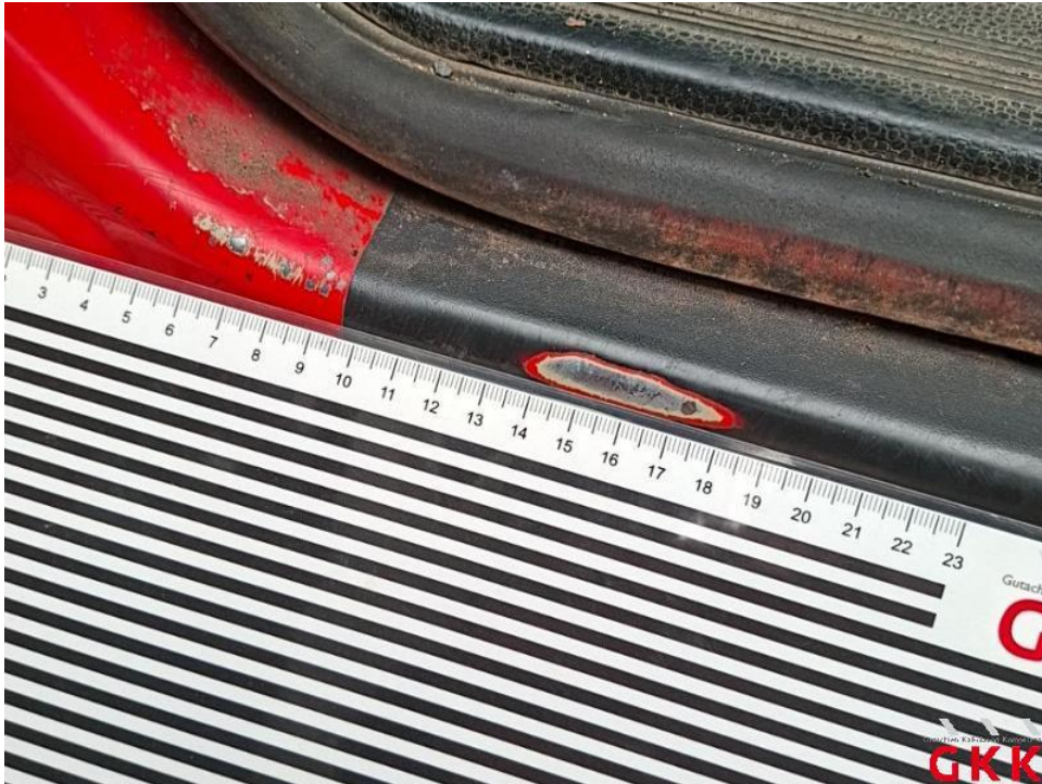
Bild 21. Tür vorne links, Einstieg, verkratzt, lackieren
