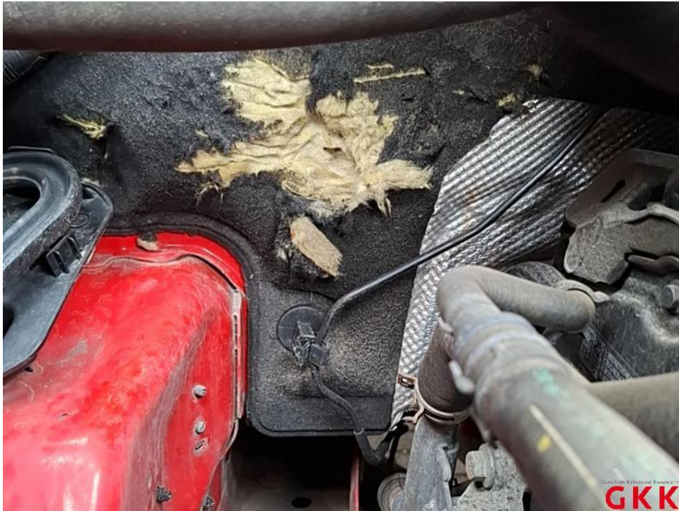
Bild 13. Motorraum, Dämmmatte, beschädigt, ersetzen
