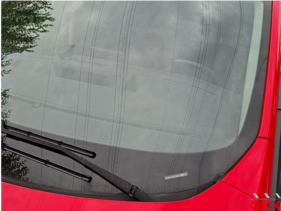
Bild 15. Frontscheibe, beheizt, Steinschlag, ersetzen
