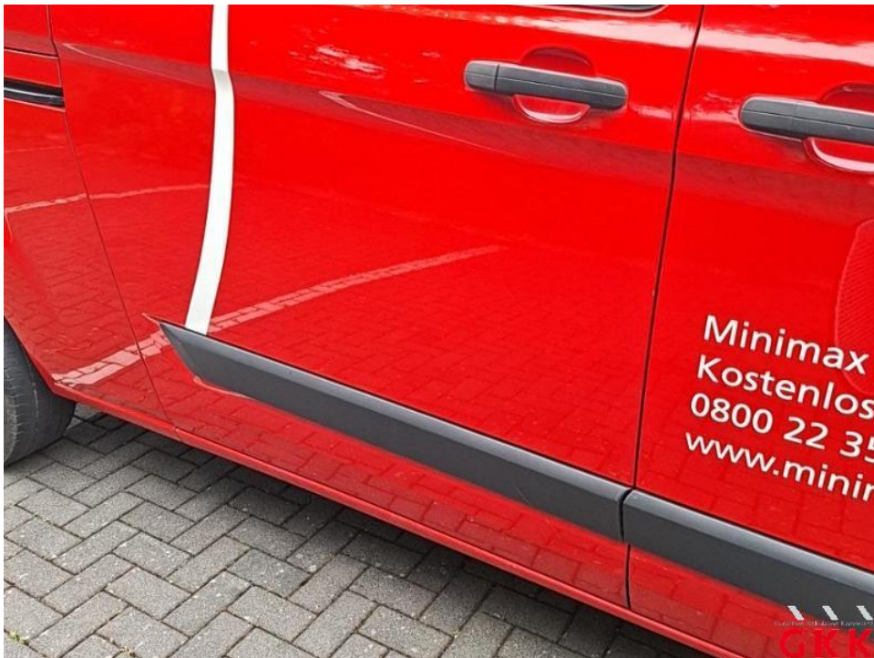
Bild 29. Schiebetür rechts, beschädigt, instand setzen - lackieren
