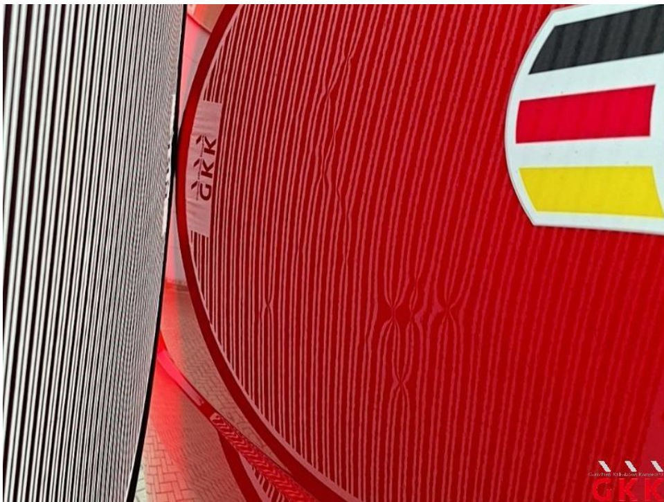
Bild 28. Heckklappe, 4 bis 10 Dellen / Bauteil, instand setzen - lackieren
