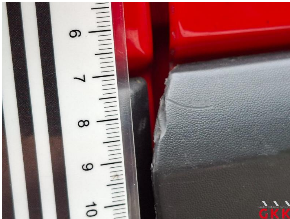
Bild 38. Tür vorne rechts, Leiste unten -unlackiert-, beschädigt, ersetzen
