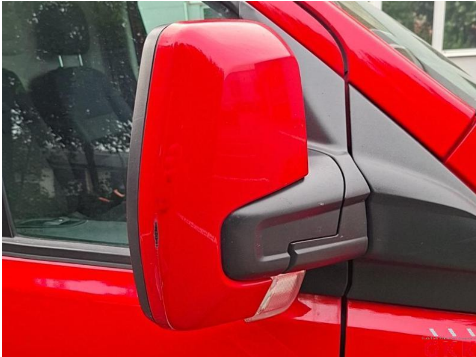
Bild 39. Spiegelgehäuse rechts, Kappe -lackiert-, gerissen, ersetzen
