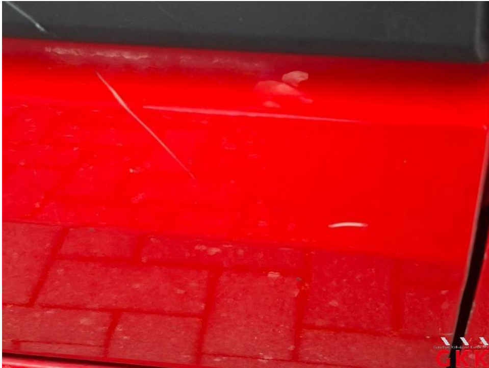
Bild 31. Schiebetür rechts, beschädigt, instand setzen - lackieren
