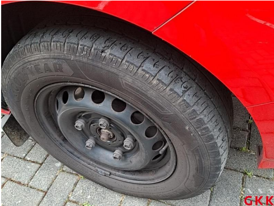
Bild 53. Radkappe(n), vorne rechts, fehlt, ersetzen
