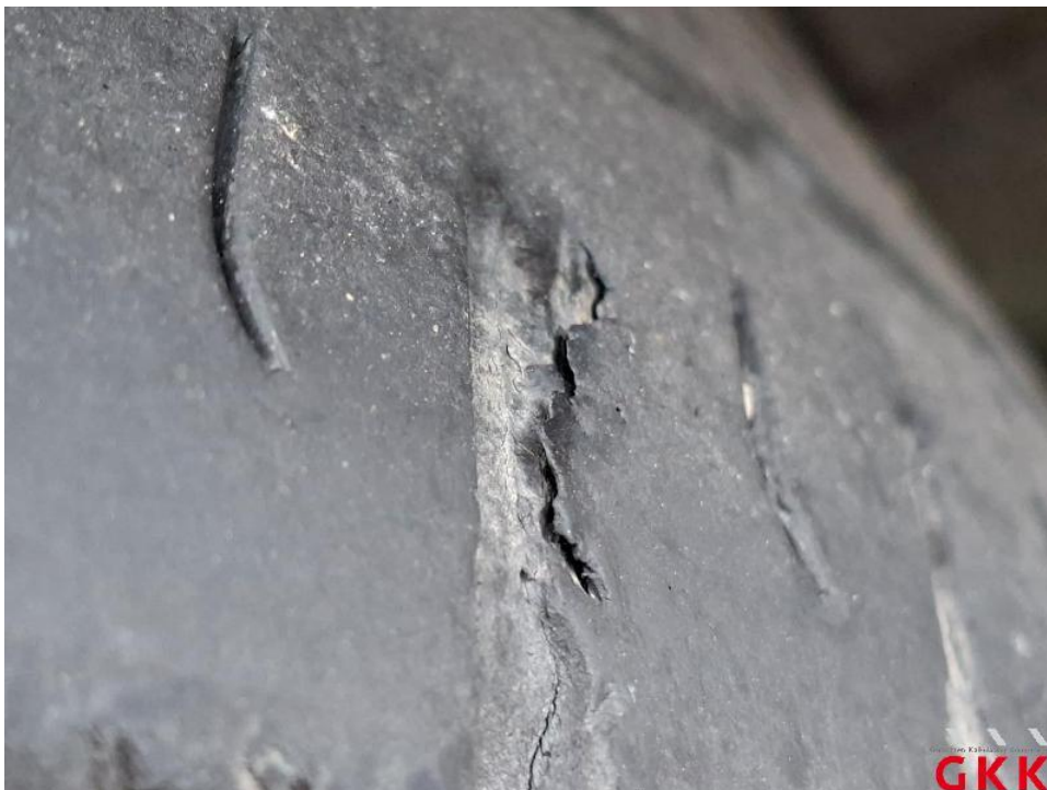
Bild 44. Reifen, hinten rechts, beschädigt, ersetzen
