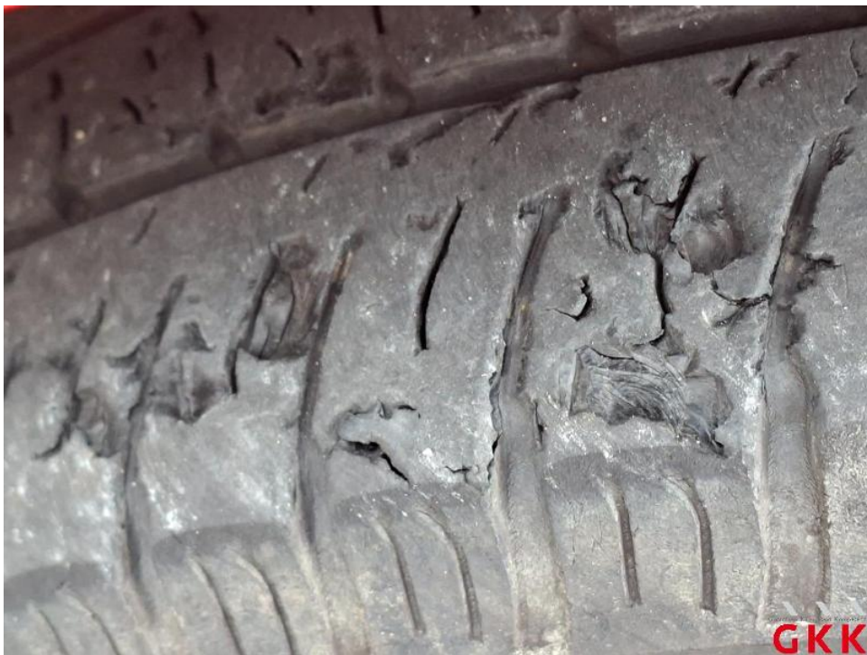
Bild 48. Reifen, vorne rechts, beschädigt, ersetzen
