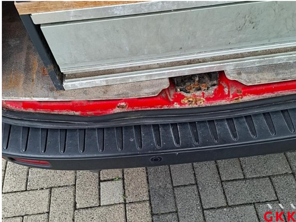
Bild 24. Heckblech, korrodiert, instand setzen - lackieren
