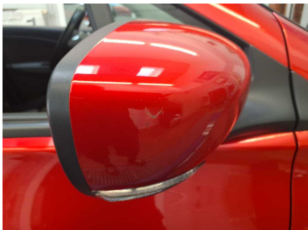
Beschädigung #2: Außenspiegel rechts: Abdeckkappe - Kratzer - Smart Repair
