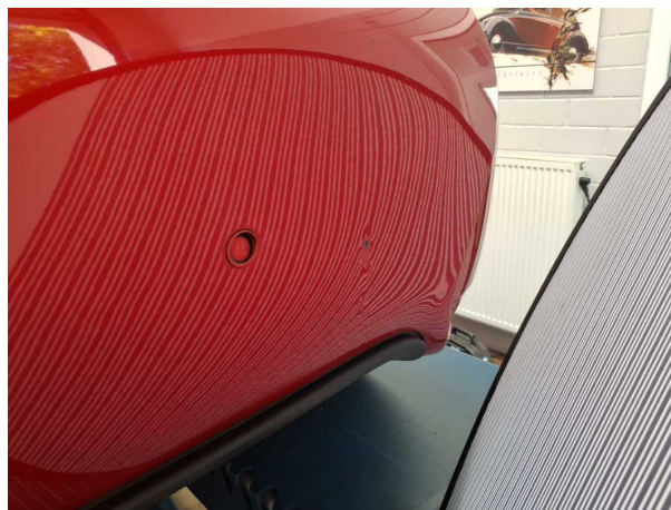
Beschädigung #7: Stossfänger hinten: Stossfänger hinten - verformt - erneuern
