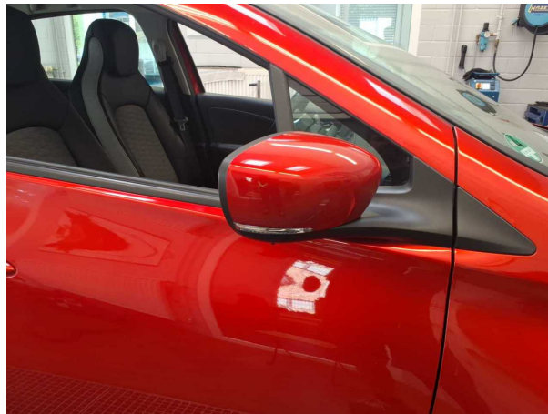
Beschädigung #2: Außenspiegel rechts: Abdeckkappe - Kratzer - Smart Repair
