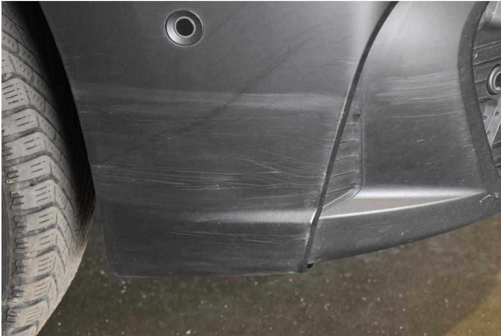
Bild 17 Fahrzeugfront Stoßfänger vorne verkratzt
