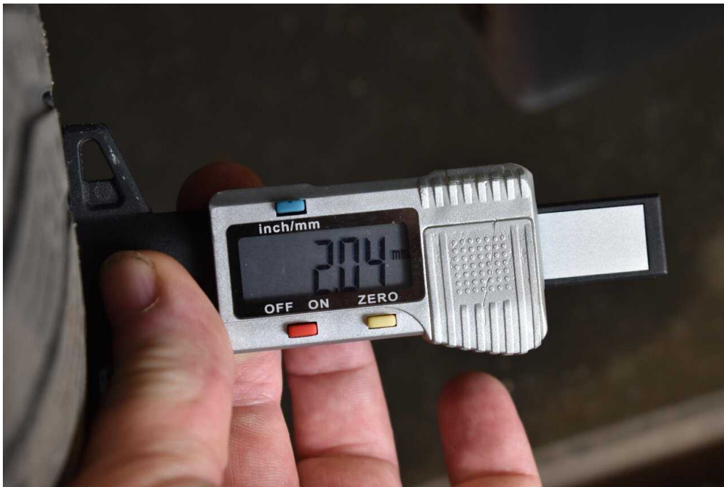
Bild 31 Vorderachse beide Winterreifen verschlissen
