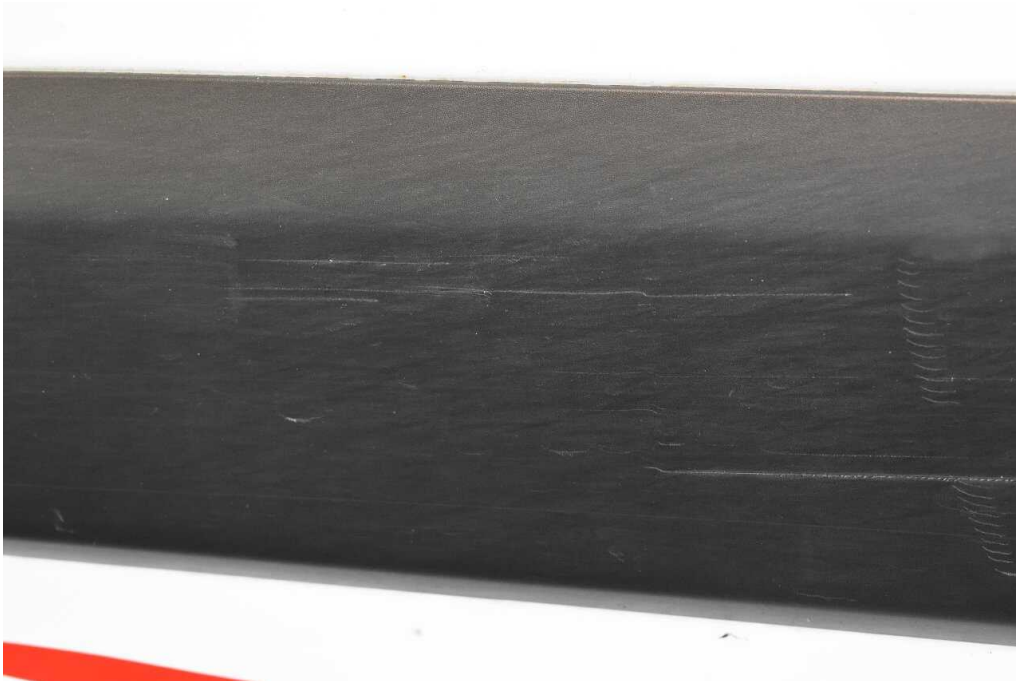
Bild 29 rechte Seite Stoßleiste Tür vorn und hinten - verkratzt
