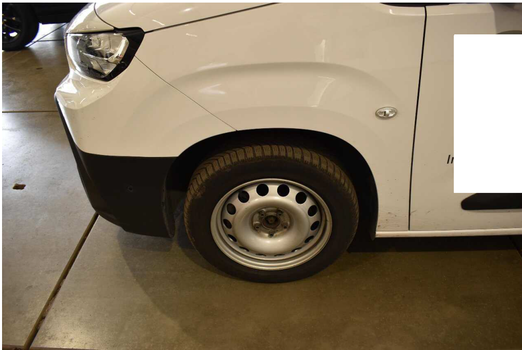
Bild 32 Vorderachse beide Winterreifen verschlissen
