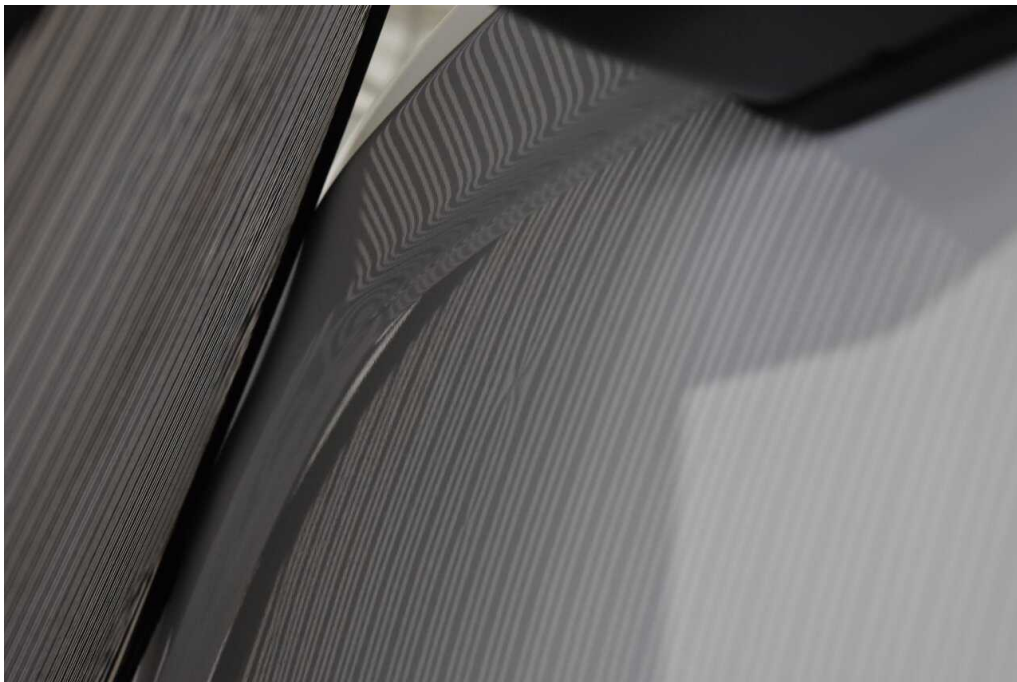
Bild 20 Fahrzeugheck Heckflügeltür links Dellen
