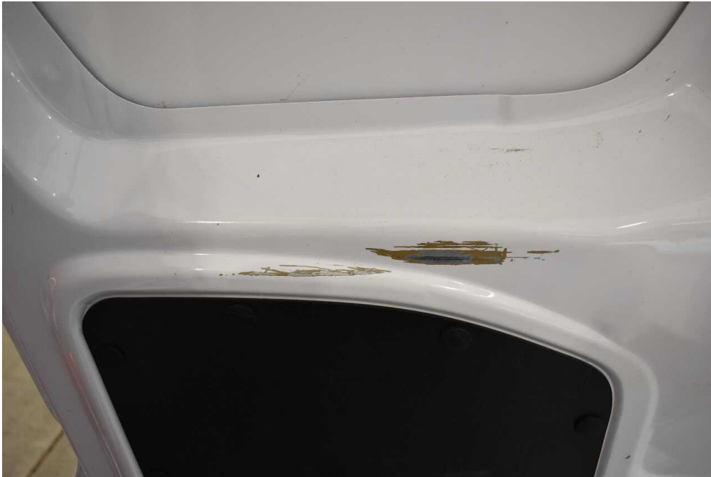
Bild 15 Fahrzeugheck Heckflügeltür rechts Innen Kratzer
