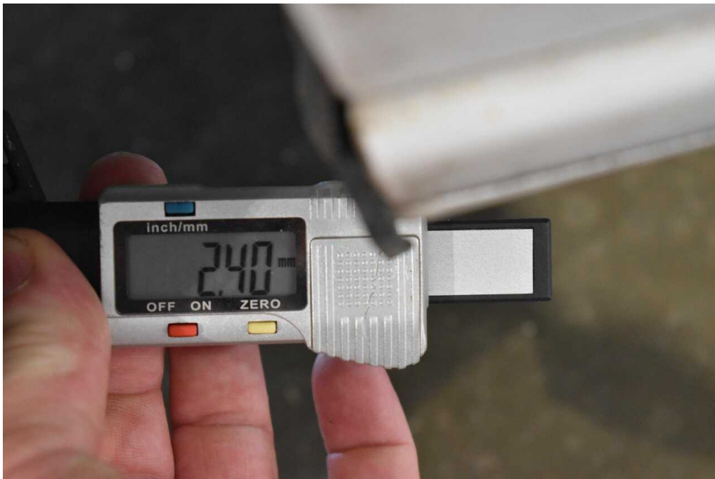
Bild 33 Vorderachse beide Winterreifen verschlissen
