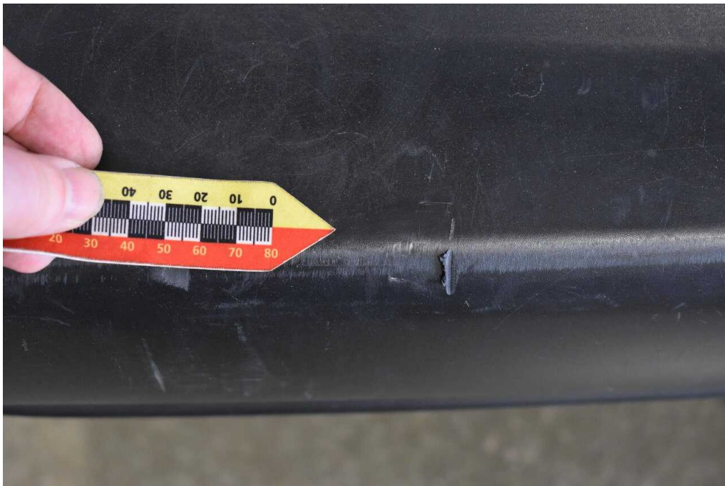
Bild 37 Fahrzeugheck Stoßfänger hinten Kratzer
