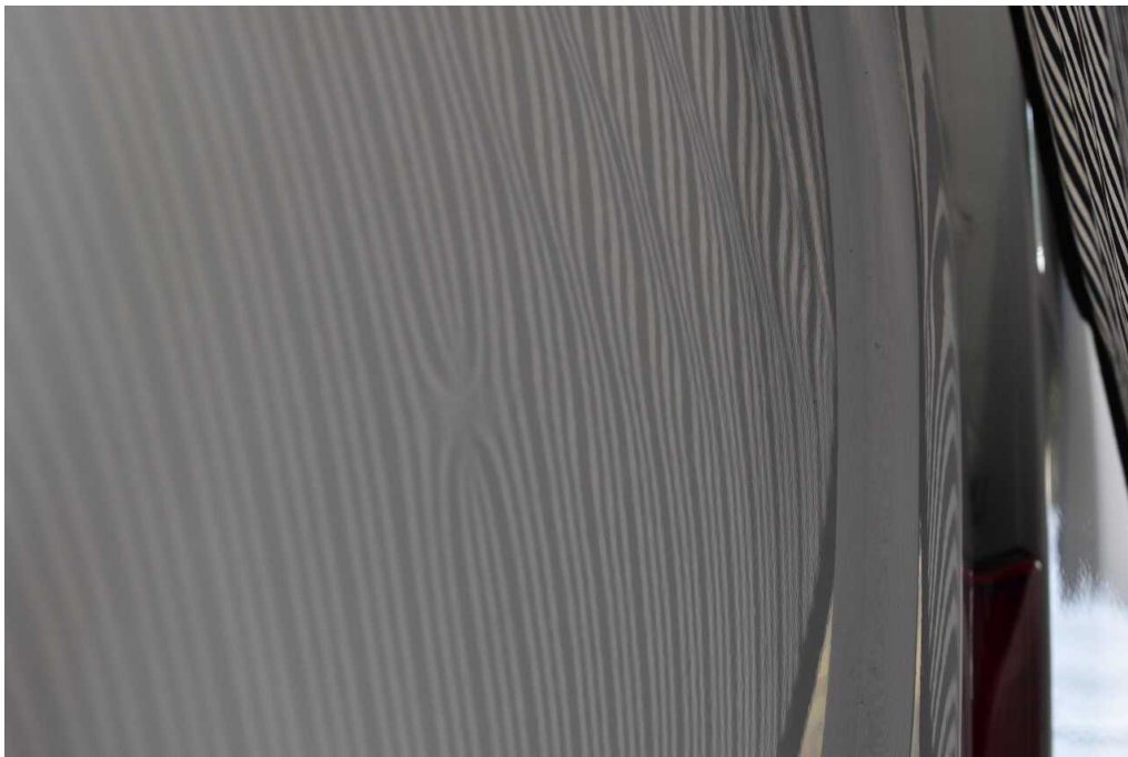
Bild 24 Fahrzeugheck Heckflügeltür rechts Beule
