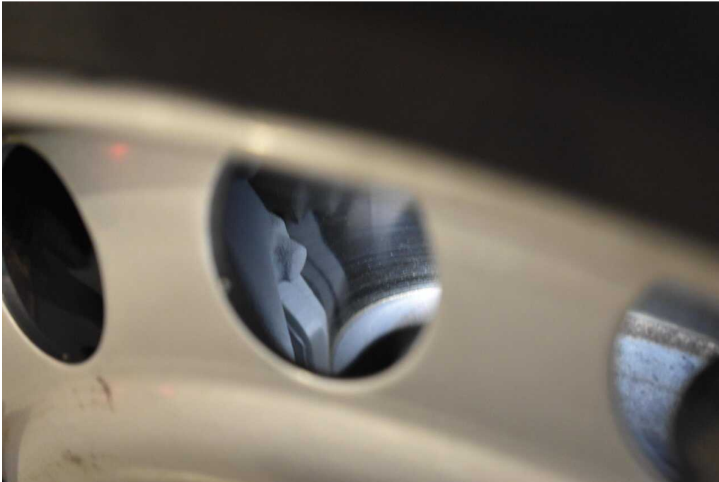
Bild 35 Vorderachse Bremsscheiben und Bremsklötze verschlissen
