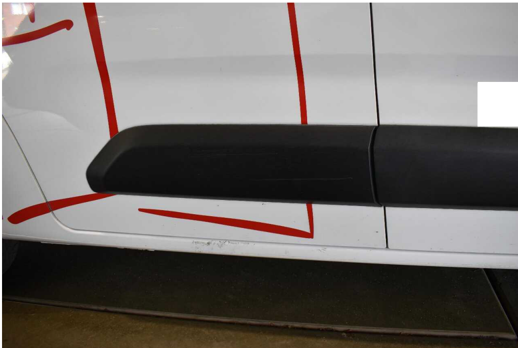
Bild 27 rechte Seite Stoßleiste Tür vorn und hinten - verkratzt
