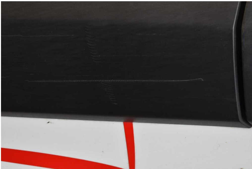
Bild 28 rechte Seite Stoßleiste Tür vorn und hinten - verkratzt
