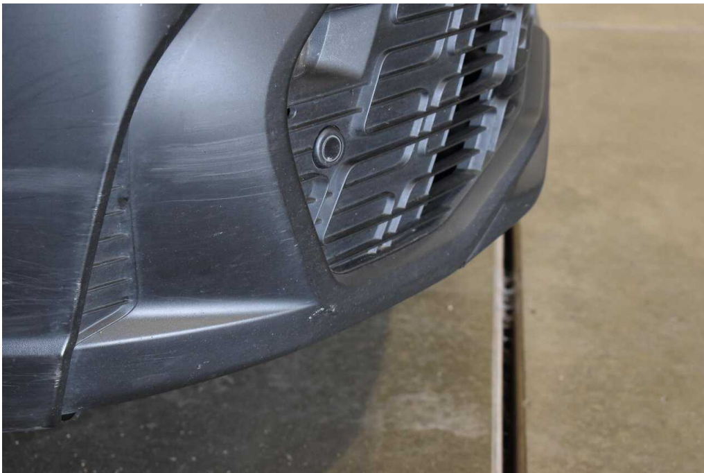
Bild 18 Fahrzeugfront Stoßfänger vorne verkratzt
