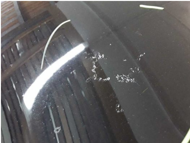
Beschädigung #16: Motorhaube: Motorhaube - Lackmangel - instandsetzen und lackieren
