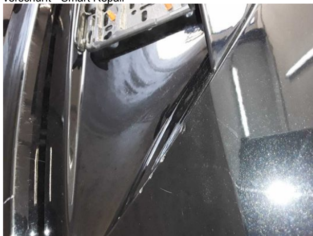
Beschädigung #7: Heckklappe/-tür: Heckklappe - verkratzt / verschürft - Smart Repair
