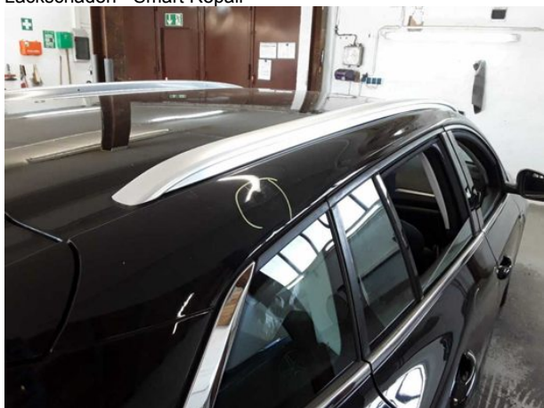
Beschädigung #11: Fahrzeugdach: Dachholm rechts - Delle / Lackschaden - instandsetzen und lackieren
