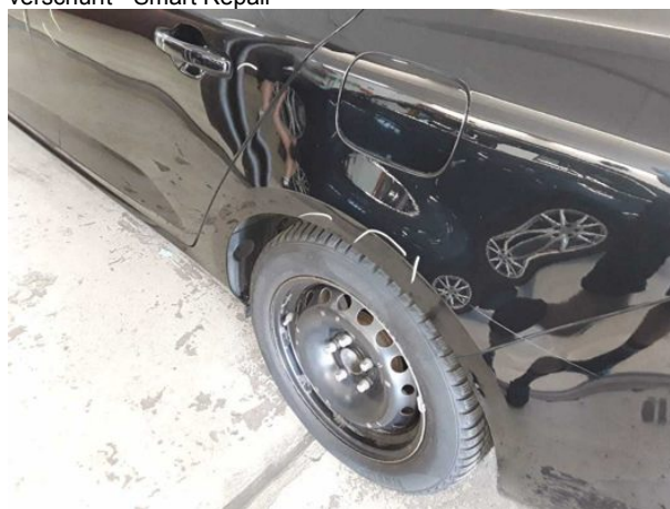
Beschädigung #10: Seitenwand links: Seitenwand - Delle / Lackschaden - Smart Repair
