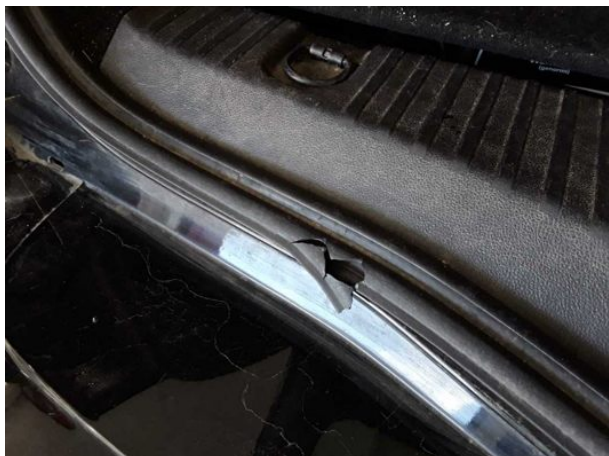
Beschädigung #1: Heckklappe/-tür: Dichtung - gebrochen / gerissen - erneuern
