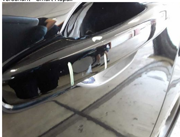
Beschädigung #8: Tür hinten links: Griff außen - verkratzt / verschürft - Smart Repair
