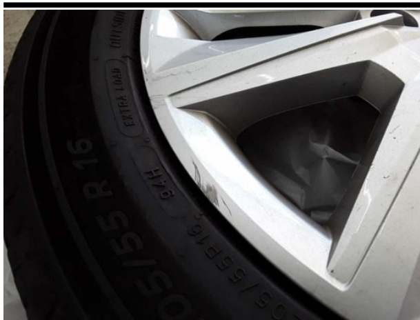
Beschädigung #3: 2.Radsatz: Radblendensatz komplett - verkratzt / verschürft - erneuern
