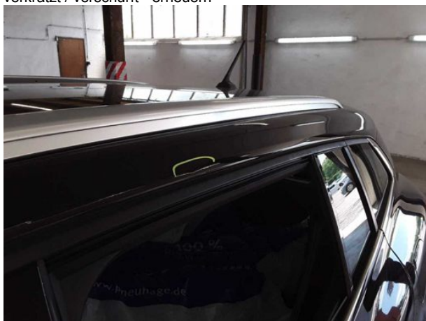
Beschädigung #4: Fahrzeugdach: Dachholm links - Delle(n) - sa... instandsetzen
