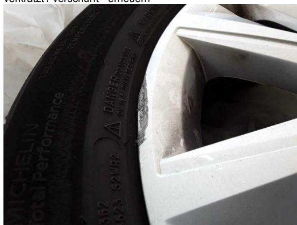
Beschädigung #3: 2.Radsatz: Radblendensatz komplett - verkratzt / verschürft - erneuern
