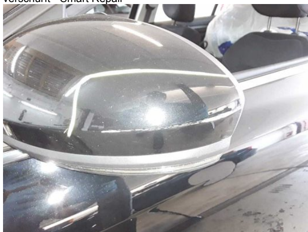
Beschädigung #9: Außenspiegel links: Abdeckkappe - verkratzt / verschürft - Smart Repair
