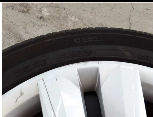
Beschädigung #3: 2.Radsatz: Radblendensatz komplett - verkratzt / verschürft - erneuern
