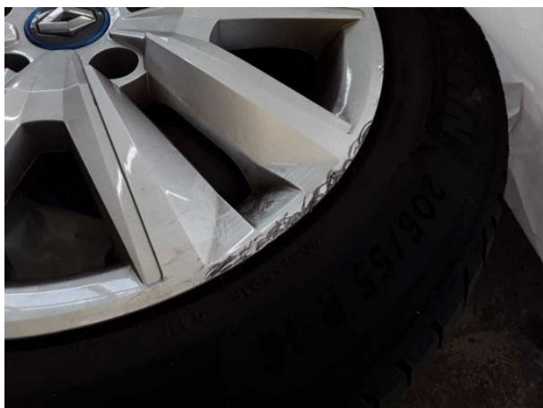
Beschädigung #3: 2.Radsatz: Radblendensatz komplett - verkratzt / verschürft - erneuern
