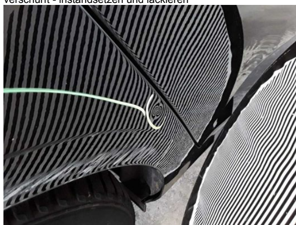
Beschädigung #15: Seitenwand rechts: Seitenwand - Delle / Lackschaden - instandsetzen und lackieren
