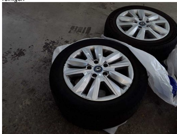
Beschädigung #3: 2.Radsatz: Radblendensatz komplett - verkratzt / verschürft - erneuern
