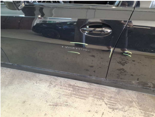
Beschädigung #7: Tür vorn links: Tür - verkratzt / verschürft - instandsetzen und lackieren
