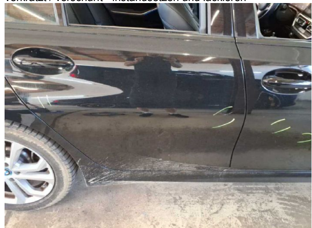
Beschädigung #6: Tür hinten rechts: Tür - verkratzt / versch... - instandsetzen und lackieren
