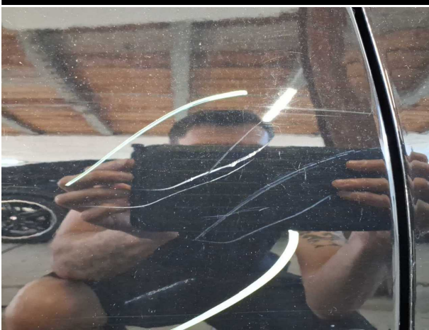
Beschädigung #6: Tür hinten rechts: Tür - verkratzt / verschürft - instandsetzen und lackieren
