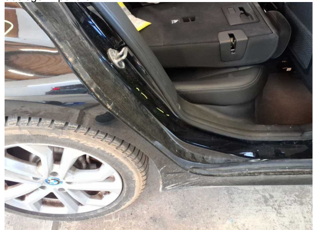
Beschädigung #3: Seitenwand rechts: Einstieg - verkratzt / verschürft - auslegen / polieren
