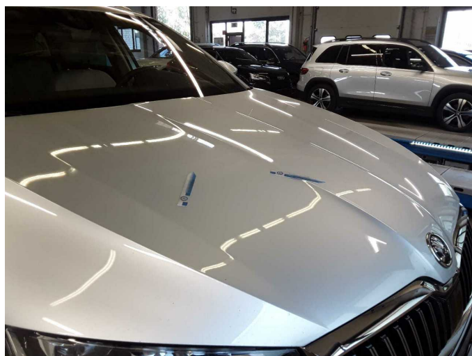
Damage 11: Bonnet: Bonnet (Vermehrte steinschläge) - Stone chips - Paint
