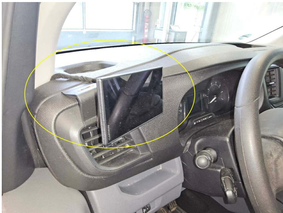
Bild 15 : Navigationsgerät (Zubehör) ausbauen
