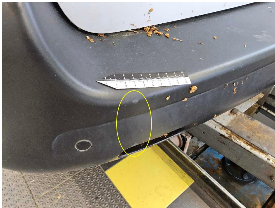
Bild 18 : Stossfänger hinten links eingedrückt und verschrammt
