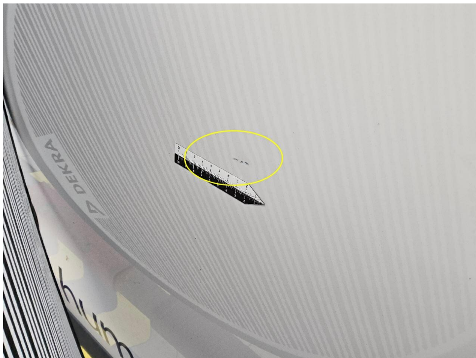
Bild 17 : Seitenteil hinten links, eingedellt, instandsetzen und lackieren mit Lackaufbau
