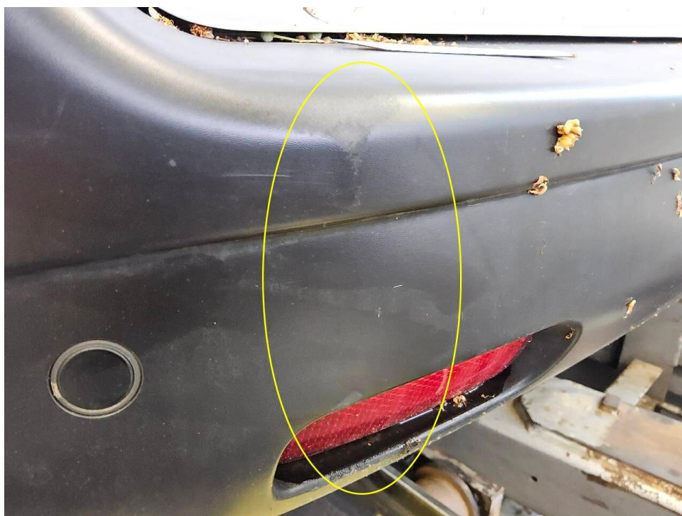
Bild 19 : Stossfänger hinten links eingedrückt
