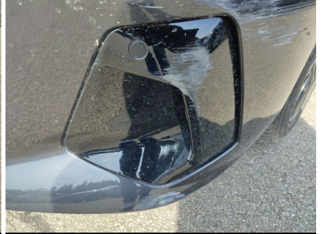
Stoßfängerleiste / Vorne Links / Gebrochen
