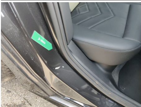
Türeinstieg / Hinten Rechts / Kratzer
