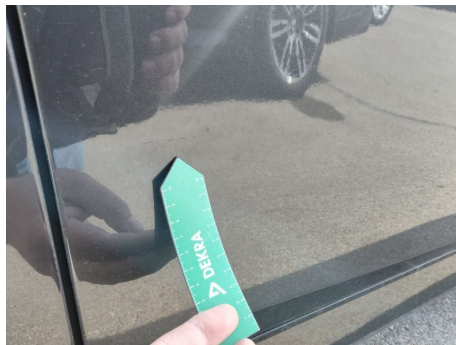
Tür / Vorne Rechts / Kratzer
