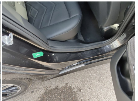
Türeinstieg / Hinten Rechts / Kratzer
