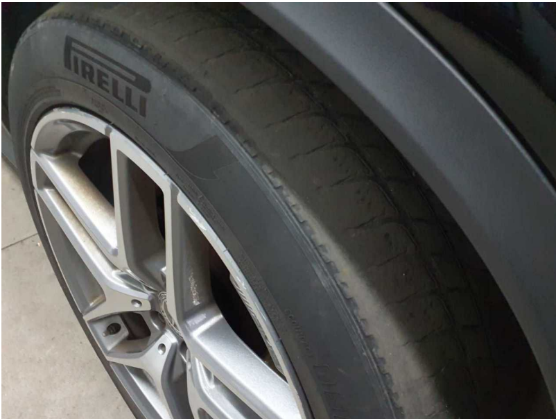
Beschädigung #1: Rad/Reifen: Reifen vorn - verschlissen - kein Abzug
