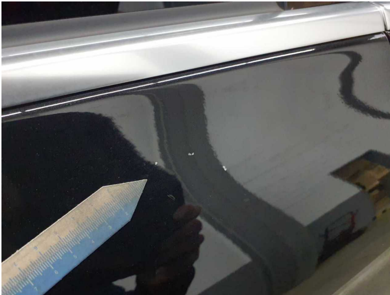
Beschädigung #4: Tür hinten rechts: Tür - Kratzer - Smart Repair
