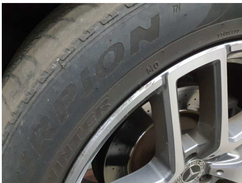
Beschädigung #8: Rad/Reifen: Leichtmetallfelge vorn links - beschädigt - erneuern
