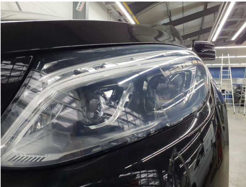
Beschädigung #13: Scheinwerfer: Scheinwerfer links (Verblichen) - erneuern
