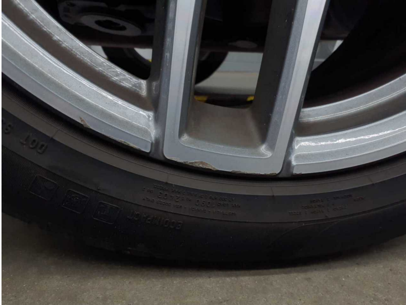
Beschädigung #10: Rad/Reifen: Leichtmetallfelge hinten links - beschädigt - erneuern
