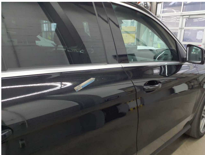
Beschädigung #4: Tür hinten rechts: Tür - Kratzer - Smart Repair
