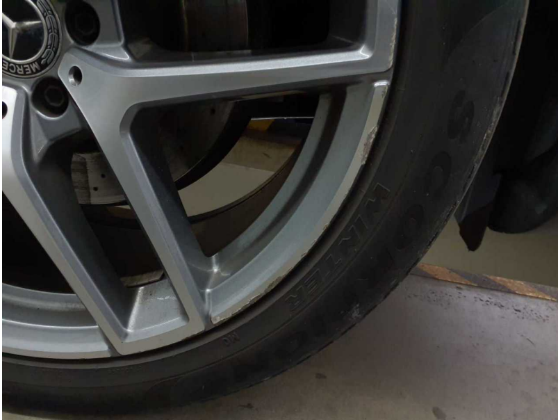
Beschädigung #9: Rad/Reifen: Leichtmetallfelge vorn rechts - beschädigt - erneuern
