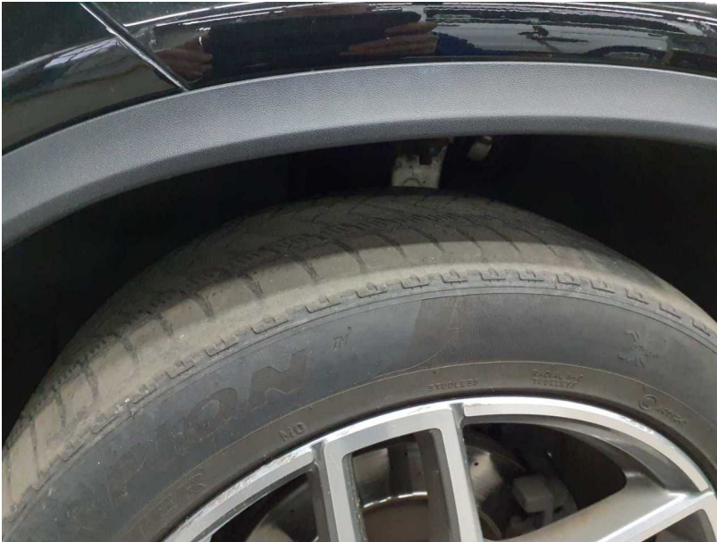
Beschädigung #1: Rad/Reifen: Reifen vorn - verschlissen - kein Abzug
