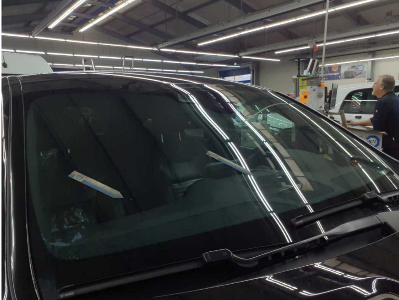
Beschädigung #7: Verglasung: Frontscheibe mit Spurhalteassistent (und Kratzer) - Steinschlag - erneuern
