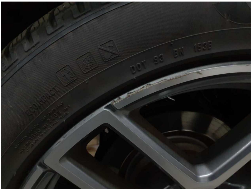
Beschädigung #11: Rad/Reifen: Leichtmetallfelge hinten rechts - beschädigt - erneuern
