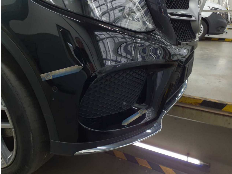
Beschädigung #12: Stossfänger vorn: Stossfänger mit Parktronic (inkl. Chromblende unten mitte und rechts) - beschädigt - erneuern
