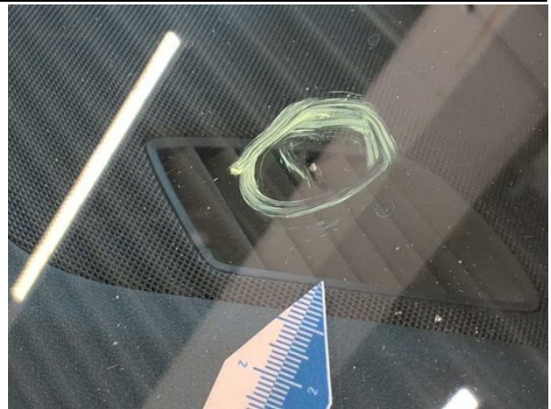
Beschädigung #5: Verglasung: Frontscheibe mit Spurhalteassistent - Steinschlag - erneuern
