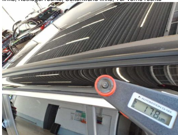
Nachlackierung 1: Dachholm links, Dachholm rechts, Kotflügel links, Kotflügel rechts, Seitenwand links, Tür vorne rechts
