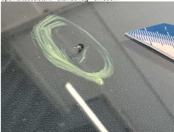
Beschädigung #5: Verglasung: Frontscheibe mit Spurhalteassistent - Steinschlag - erneuern
