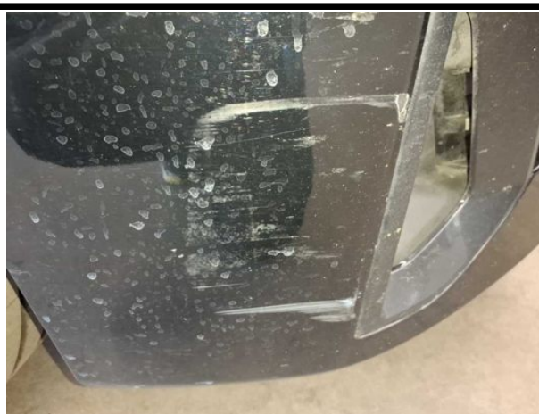
Beschädigung #3: Stossfänger vorn: Stossfänger vorn - Kratzer - instandsetzen und lackieren
