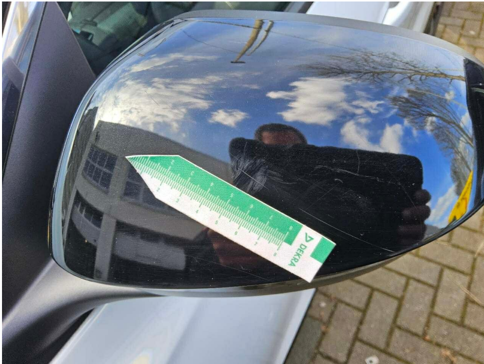
Bild 15 : Außenspiegel links Lackierung, zerkratzt, smart repair
