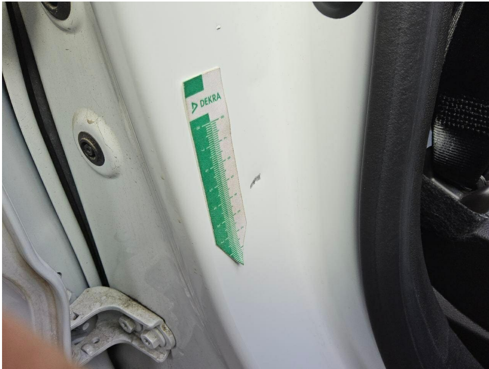
Bild 13 : Tür vorne rechts Einstieg Lackierung, zerkratzt, smart repair
