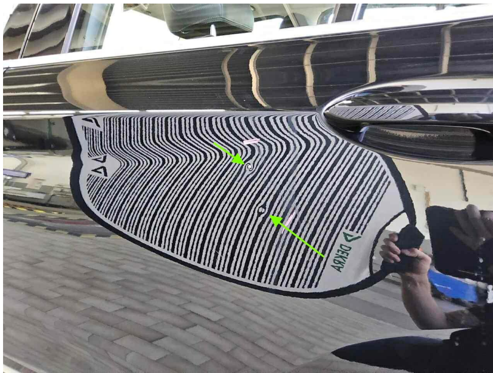
Bild 20 : Tür hinten links, mehrfach eingedellt, instandsetzen und lackieren mit Lackaufbau
