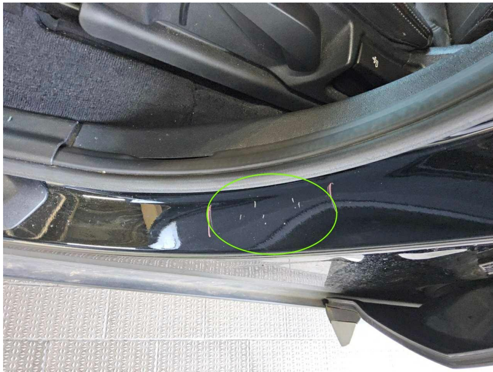
Bild 14 : Tür vorne links Einstieg Lackierung, verschrammt, smart repair
