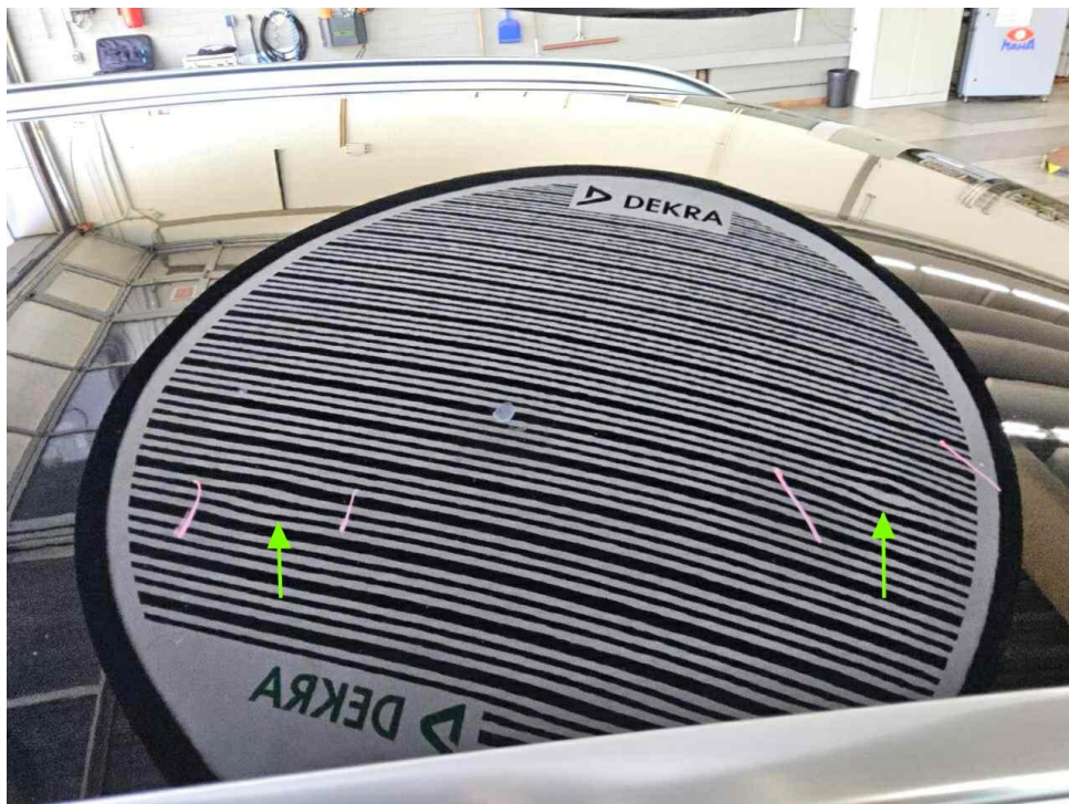
Bild 16 : Dach, mehrfach eingedellt, drücken
