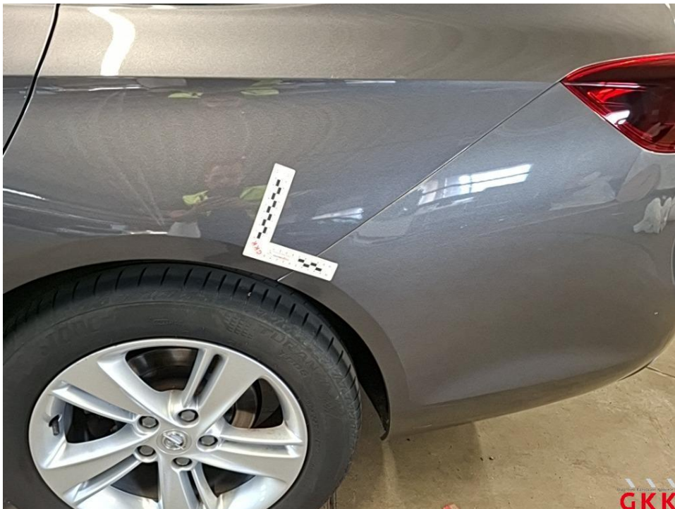
Bild 22 Stoßfänger hinten, Verkleidung -lackiert-, Spaltmaß fehlerhaft, instand setzen
