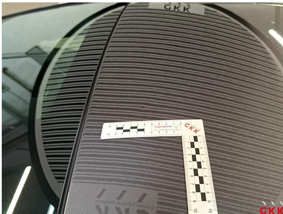
Bild 16 Dach, beschädigt, kalt drücken
