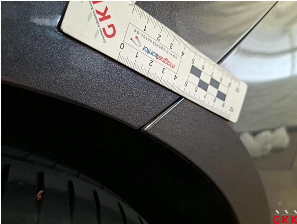
Bild 23 Stoßfänger hinten, Verkleidung -lackiert-, Spaltmaß fehlerhaft, instand setzen
