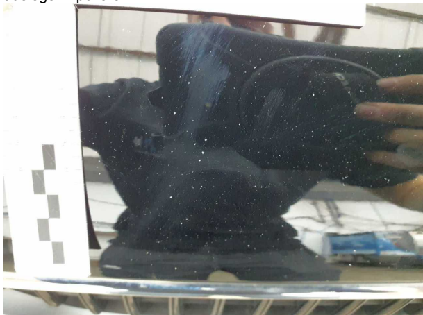
Beschädigung #2: Motorhaube: Motorhaube - Steinschlag - auslegen / polieren
