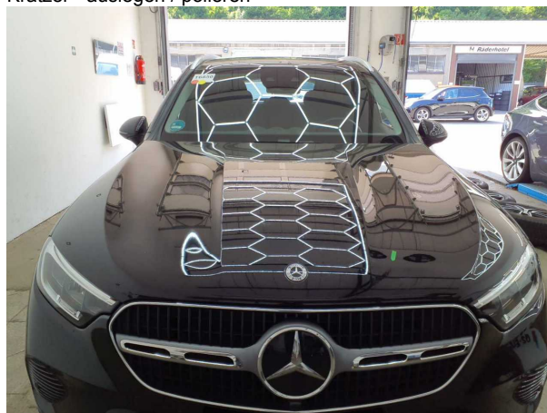
Beschädigung #2: Motorhaube: Motorhaube - Steinschlag - auslegen / polieren
