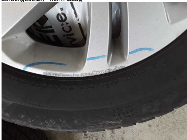
Beschädigung #4: 2.Radsatz: 1 Leichtmetallfelge - verkratzt / verschürft - Wertminderung
