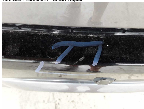
Beschädigung #8: Stossfänger hinten: Spoiler - verkratzt / verschürft - erneuern
