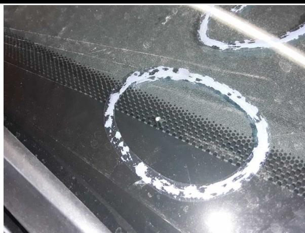
Beschädigung #9: Verglasung: Frontscheibe (Rissbildung) - Steinschlag - erneuern
