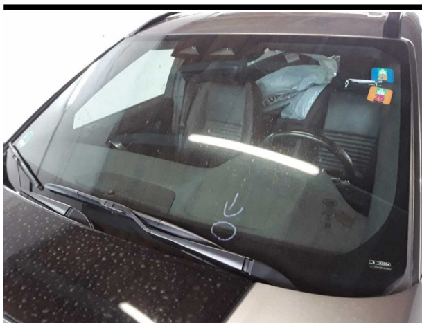
Beschädigung #9: Verglasung: Frontscheibe (Rissbildung) - Steinschlag - erneuern
