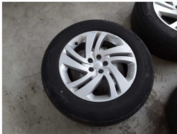
Beschädigung #4: 2.Radsatz: 1 Leichtmetallfelge - verkratzt / verschürft - Wertminderung
