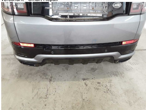
Beschädigung #8: Stossfänger hinten: Spoiler - verkratzt / verschürft - erneuern
