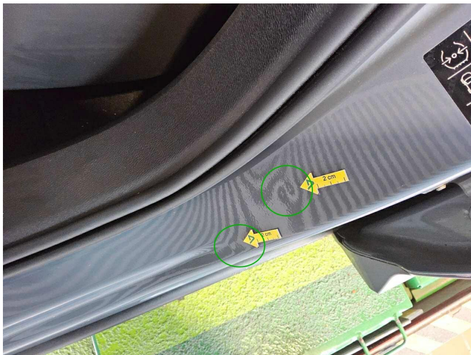
Bild 16 : Einstieg vorne links mehrfach eingedellt
