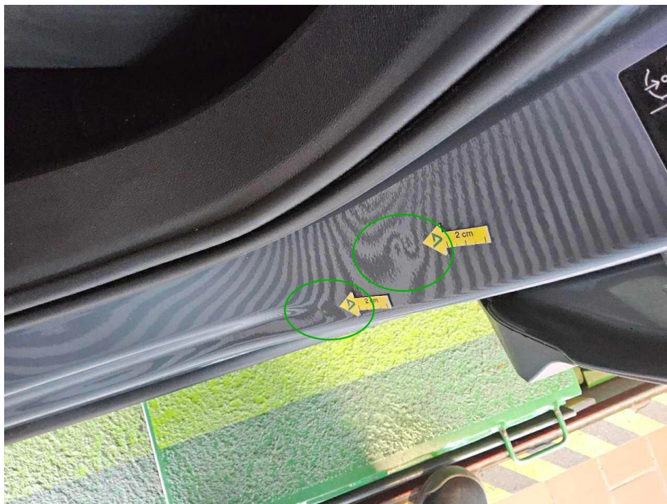
Bild 15 : Einstieg vorne links mehrfach eingedellt
