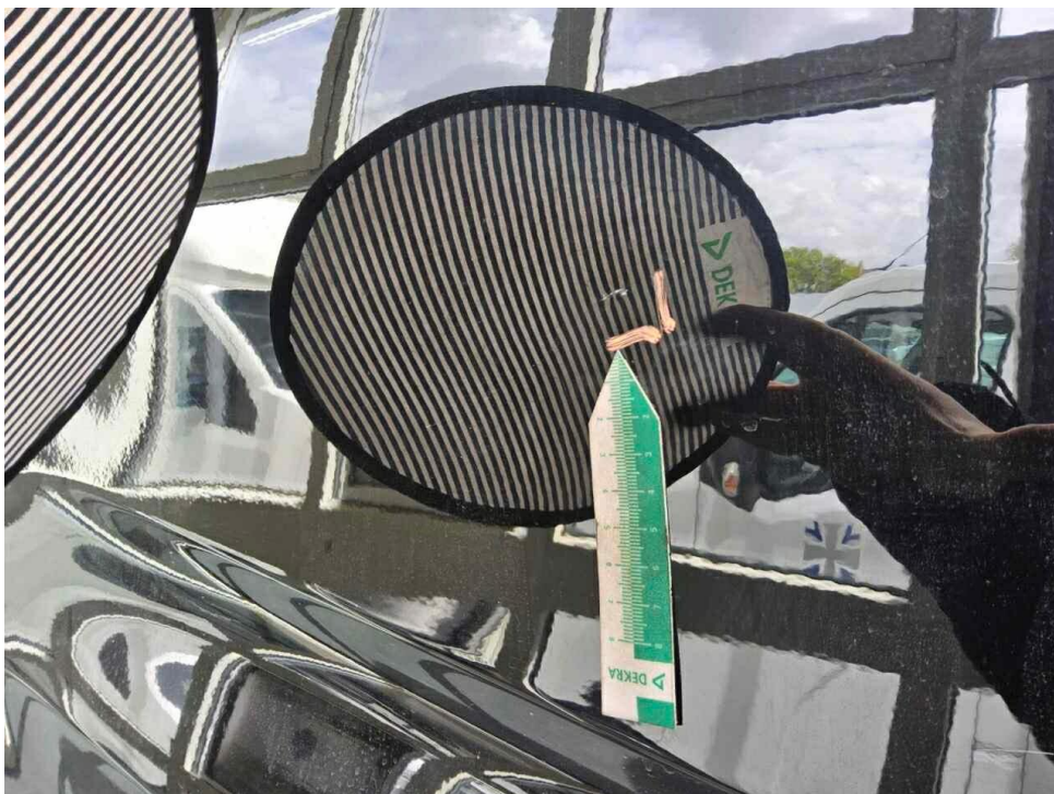
Bild 14 : Tür hinten rechts, eingedellt, instandsetzen und lackieren mit Lackaufbau
