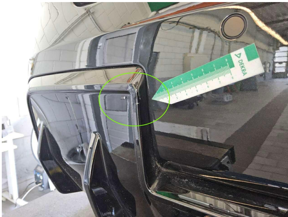
Bild 13 : Stoßfänger hinten, Druckstelle
