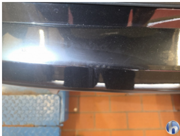
5. Stoßfänger Hinten Kratzer - Lackieren
