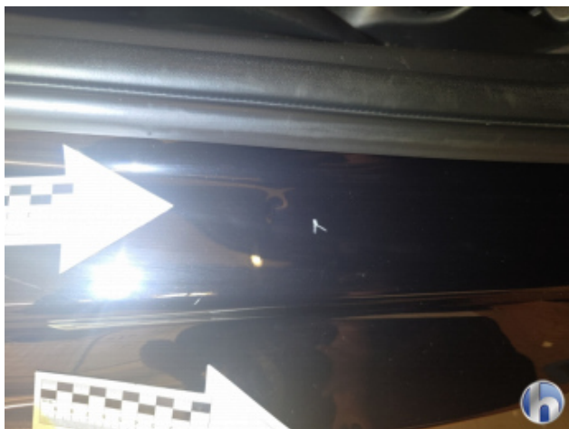
6. C-Säule Hinten - Rechts 3 Dellen - Smart Repair
