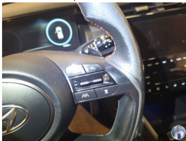
8. Lenkrad (leder) Materialabrieb - Smart Repair
