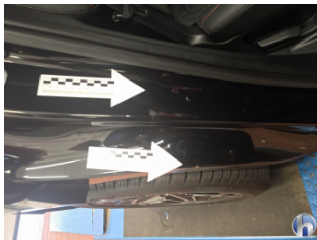
6. C-Säule Hinten - Rechts 3 Dellen - Smart Repair
