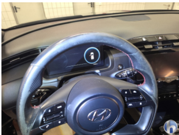
8. Lenkrad (leder) Materialabrieb - Smart Repair
