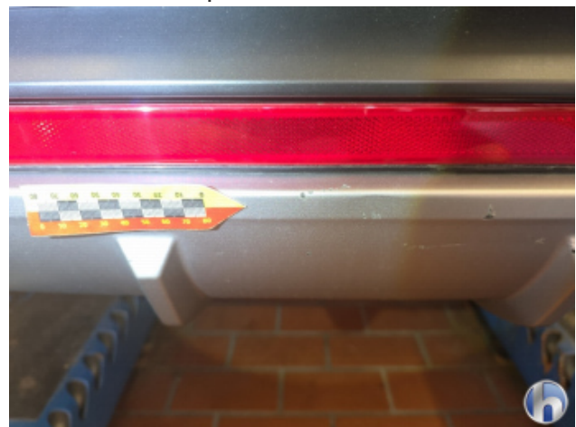
5. Stoßfänger Hinten Kratzer - Lackieren
