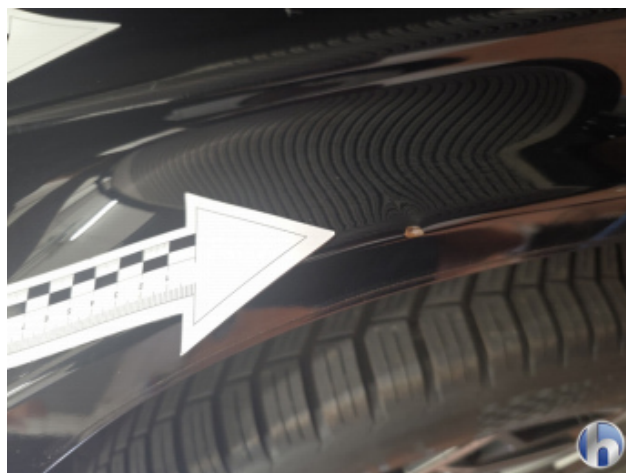
6. C-Säule Hinten - Rechts 3 Dellen - Smart Repair
