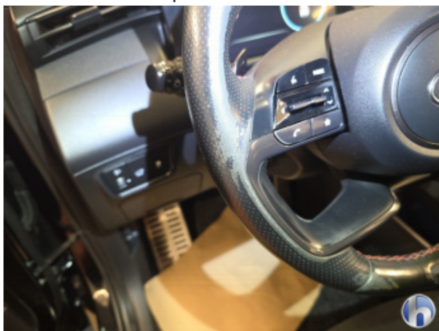
8. Lenkrad (leder) Materialabrieb - Smart Repair
