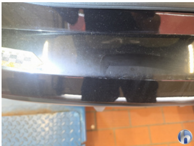
5. Stoßfänger Hinten Kratzer - Lackieren
