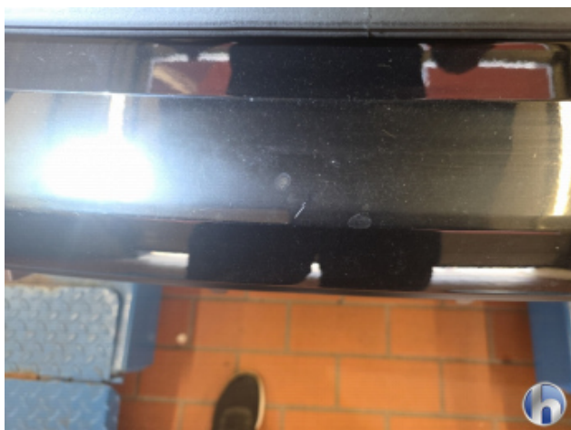
5. Stoßfänger Hinten Kratzer - Lackieren
