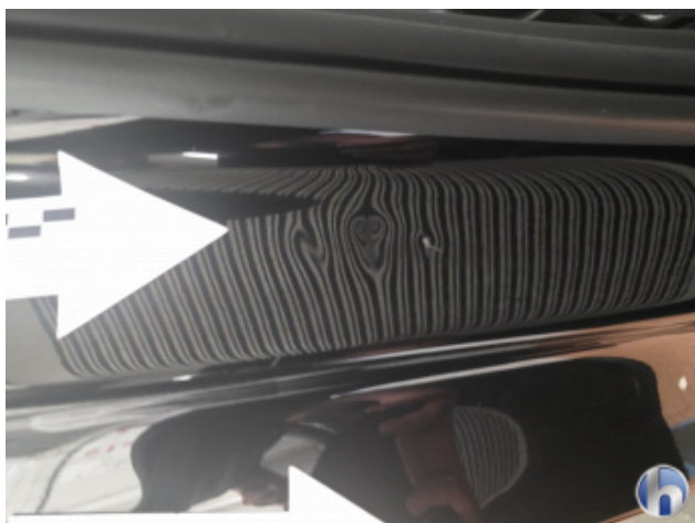
6. C-Säule Hinten - Rechts 3 Dellen - Smart Repair
