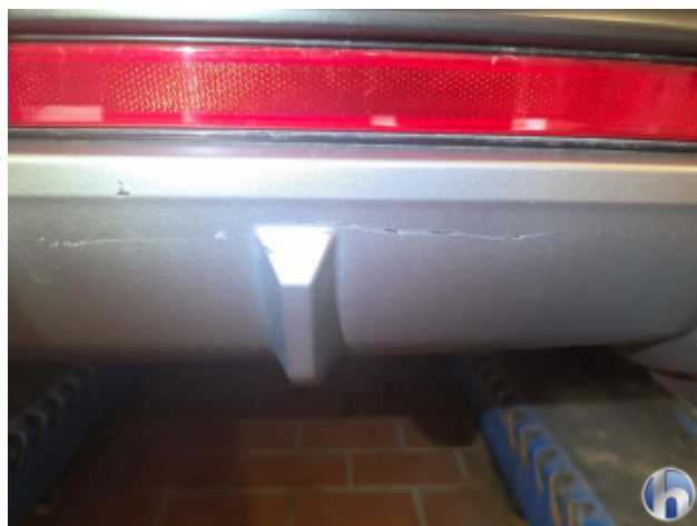
5. Stoßfänger Hinten Kratzer - Lackieren
