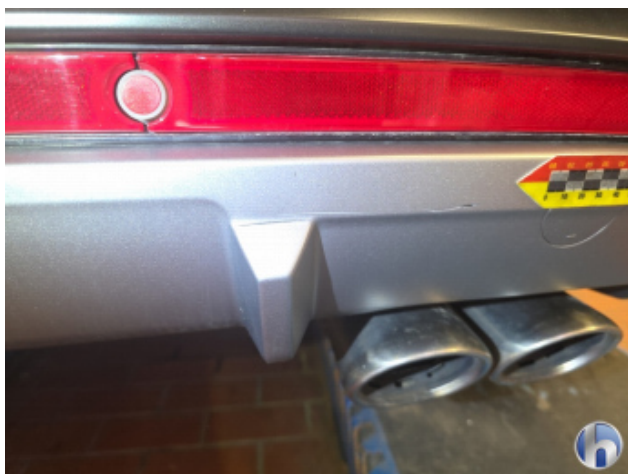
5. Stoßfänger Hinten Kratzer - Lackieren
