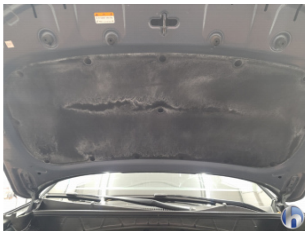
10. Motordämmmaterial Verschmutzt - Reinigen
