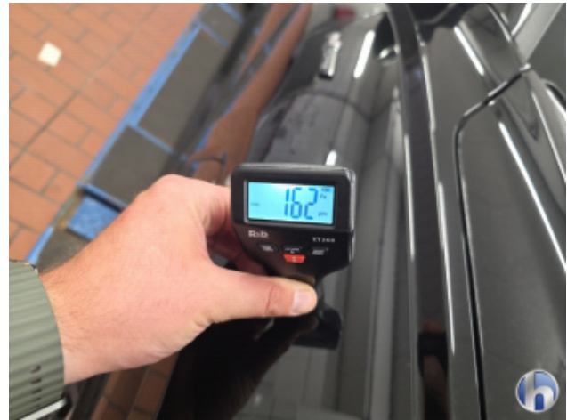
2. Kotflügel Vorne - Rechts Nachlackiert - Ohne Reparatur
