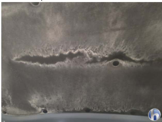
10. Motordämmmaterial Verschmutzt - Reinigen
