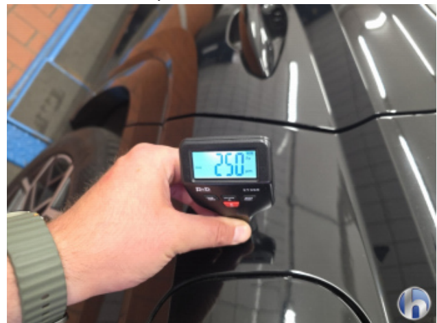
4. Seitenwand - Hinten - Links Nachlackiert - Ohne Reparatur
