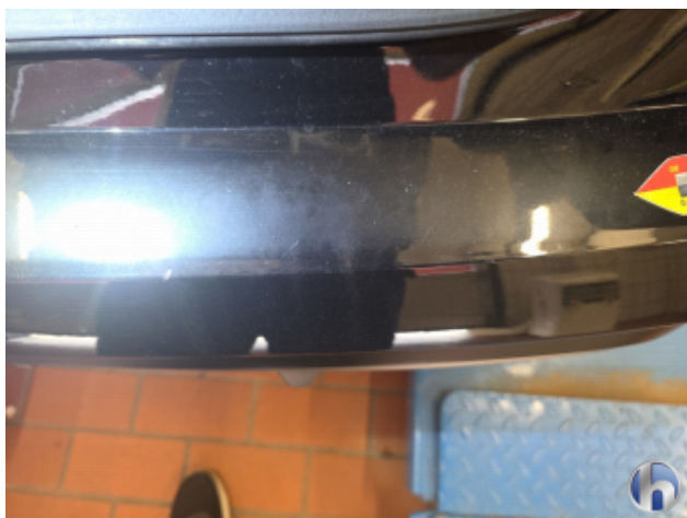
5. Stoßfänger Hinten Kratzer - Lackieren
