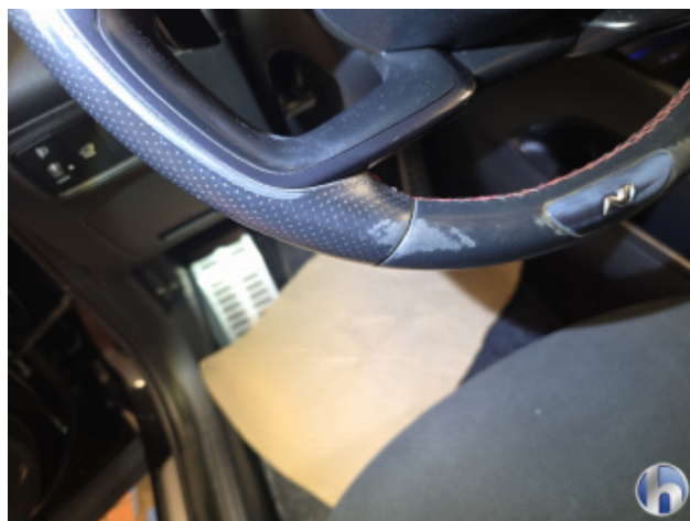
8. Lenkrad (leder) Materialabrieb - Smart Repair
