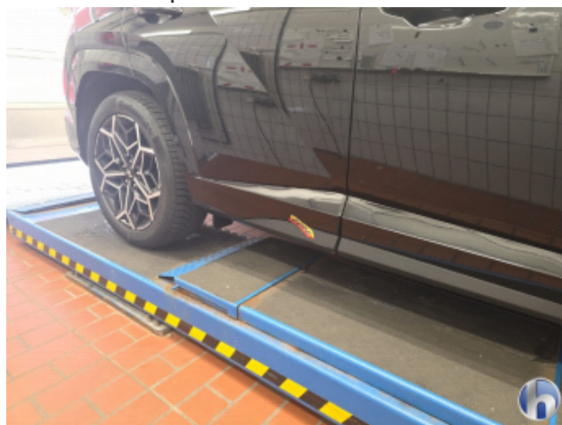
7. Tür Hinten - Rechts Kratzer - Smart Repair
