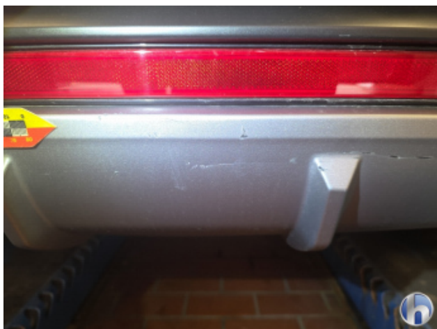
5. Stoßfänger Hinten Kratzer - Lackieren
