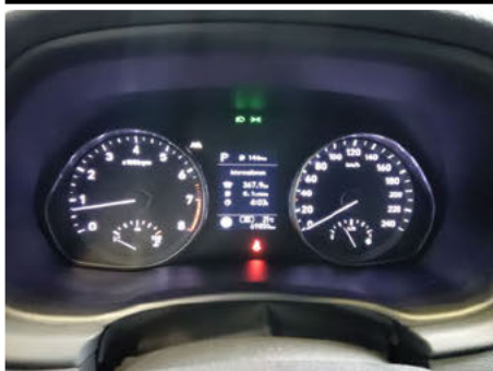
Warnleuchte Inspektion / Fehlt
