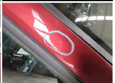
Dachholm / Vorne Rechts / Steinschlag
