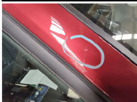
Dachholm / Vorne Rechts / Steinschlag
