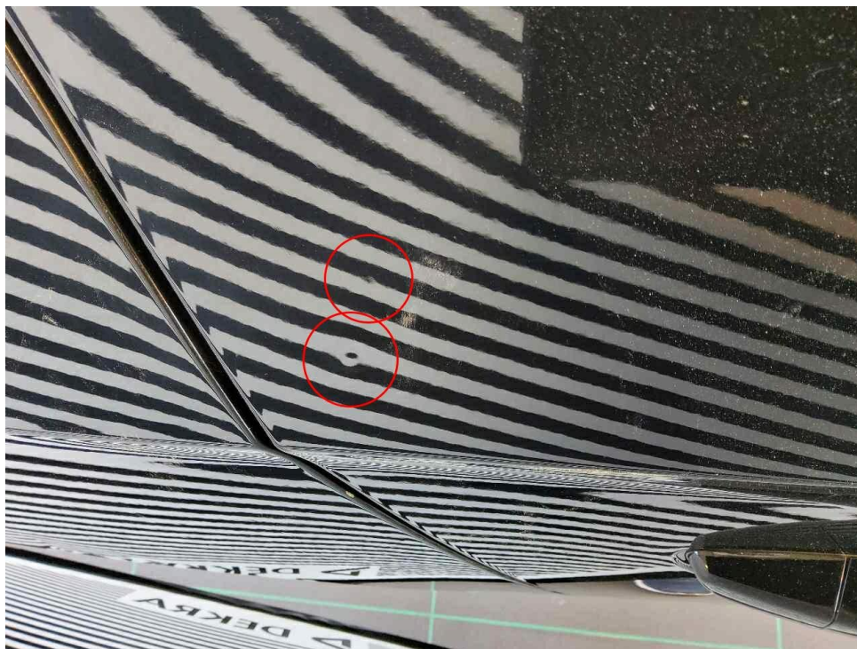
Bild 20 : Tür hinten rechts, eingedellt, drücken
