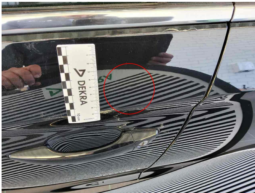
Bild 15 : Tür vorne links, eingedellt, Gebrauchsspur
