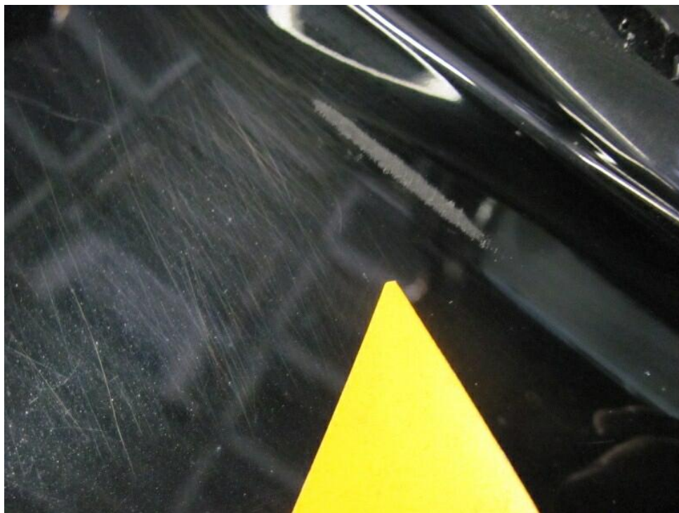
Bild 24 : Stoßfänger hinten Lackierung, zerkratzt, lackieren mit Lackaufbau, linksseitig
