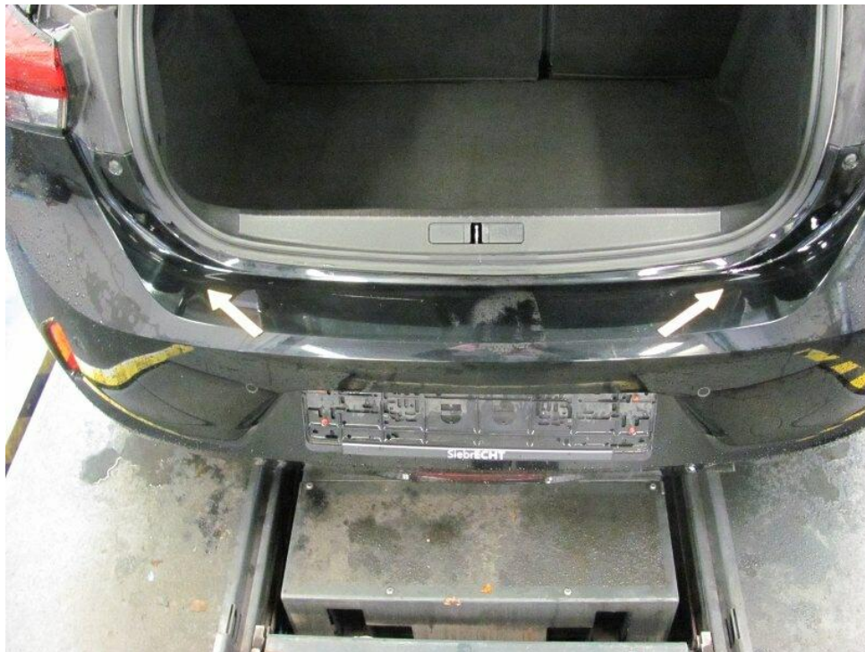
Bild 23 : Übersicht Stoßfängerverkleidung hinten zerkratzt
