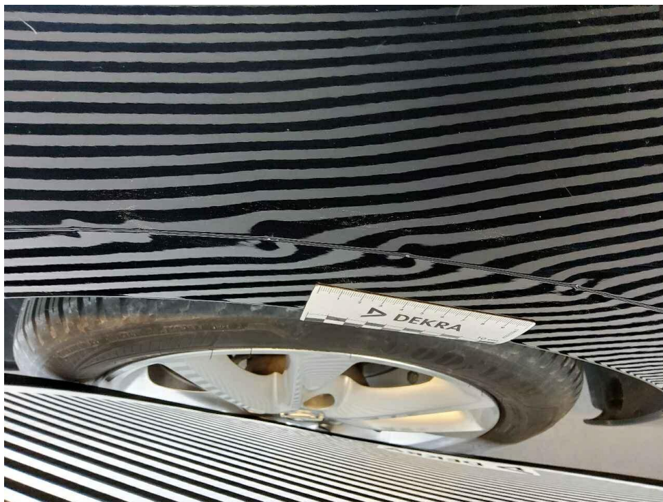
Bild 19 : Seitenteil hinten rechts, eingedellt, instandsetzen und lackieren mit Lackaufbau
