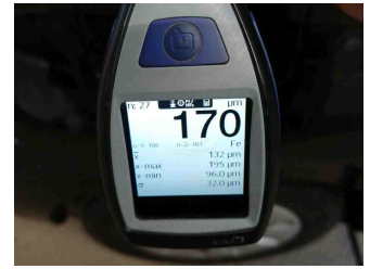
Lackstärke Seitenwand hinten rechts
