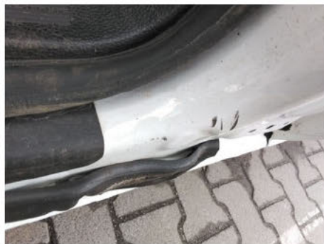
Türeinstieg / Vorne Links / Kratzer
