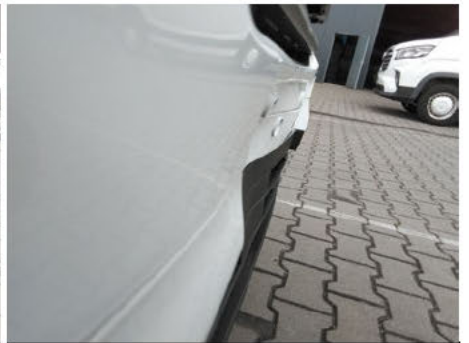
Stoßfänger unterhalb / Vorne / Gebrochen
