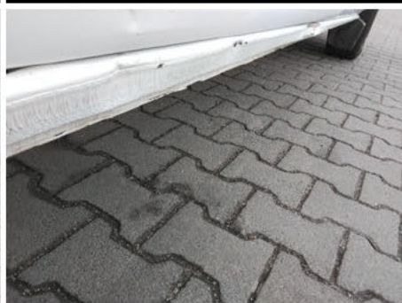
Schweller / Rechts / Delle
