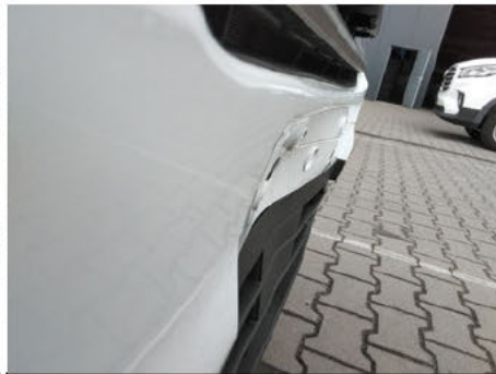
Stoßfänger unterhalb / Vorne / Gebrochen
