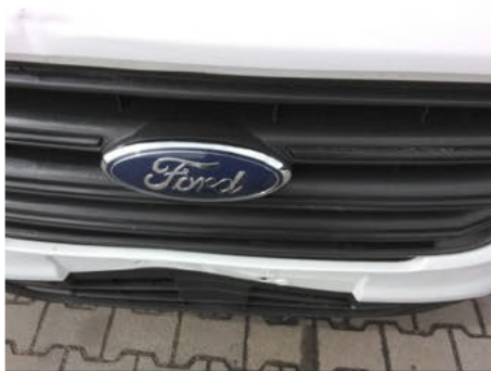
Stoßfängergrill / Vorne / Gebrochen
