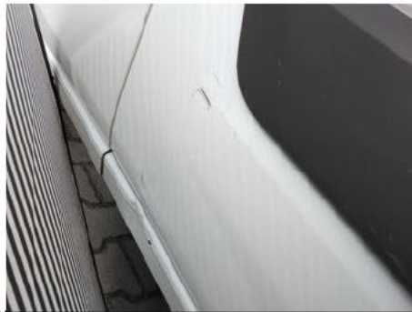
Tür / Rechts / Delle
