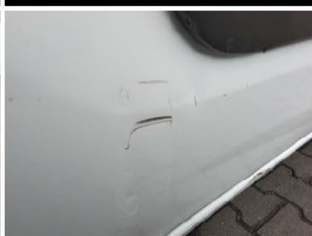
Tür / Rechts / Delle
