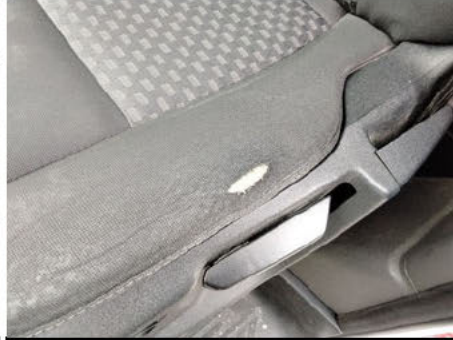
Sitz komplett / Vorne Links / Riss
