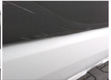
Türzierleiste / Rechts / Kratzer
