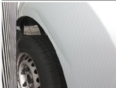
Seitenwand / Rechts / Delle
