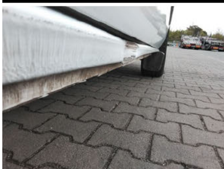
Schweller / Rechts / Delle
