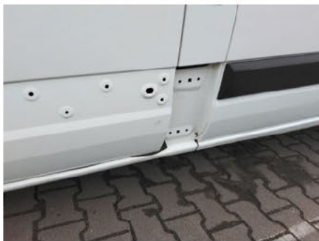
Zierleiste Seitenwand / Mitte Mitte / Fehlt
