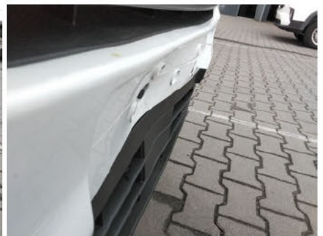
Stoßfänger oberhalb / Vorne / Gebrochen
