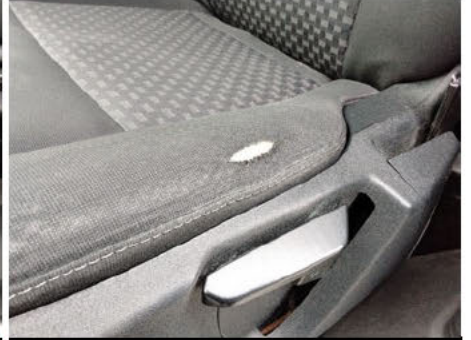
Sitz komplett / Vorne Links / Riss
