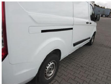
Seitenwand / Rechts / Delle
