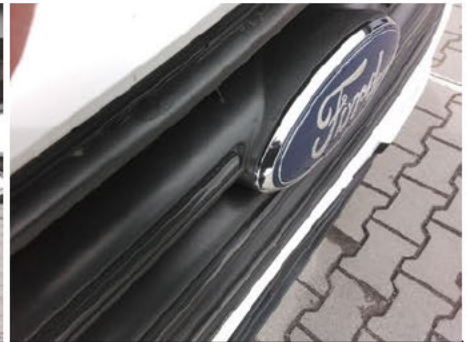
Stoßfängergrill / Vorne / Gebrochen
