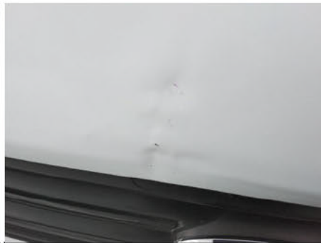
Motorhaube / Vorne / Delle
