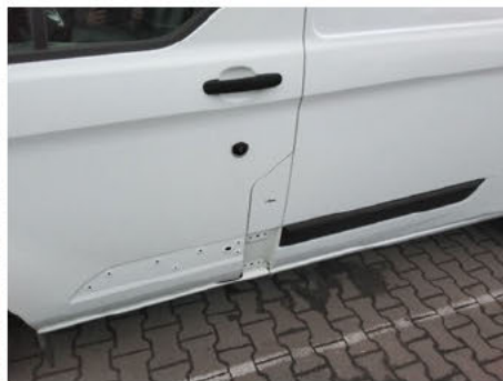
Zierleiste Seitenwand / Mitte Mitte / Fehlt
