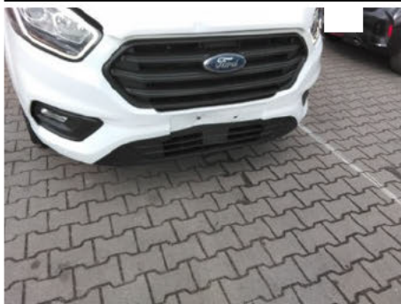
Stoßfänger unterhalb / Vorne / Gebrochen
