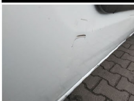
Tür / Rechts / Delle
