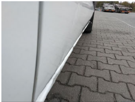
Tür / Rechts / Delle
