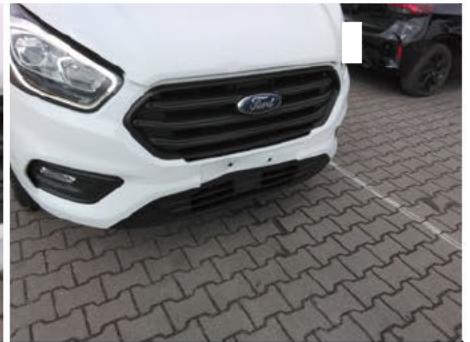
Stoßfänger oberhalb / Vorne / Gebrochen
