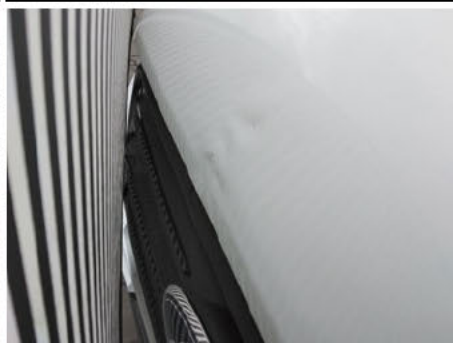
Motorhaube / Vorne / Delle
