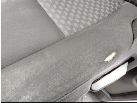
Sitz komplett / Vorne Links / Riss
