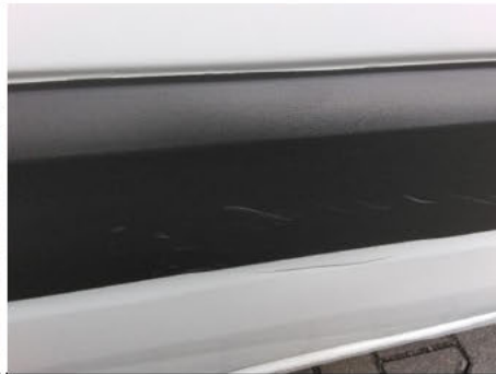
Türzierleiste / Rechts / Kratzer
