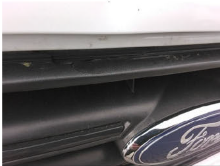
Stoßfängergrill / Vorne / Gebrochen
