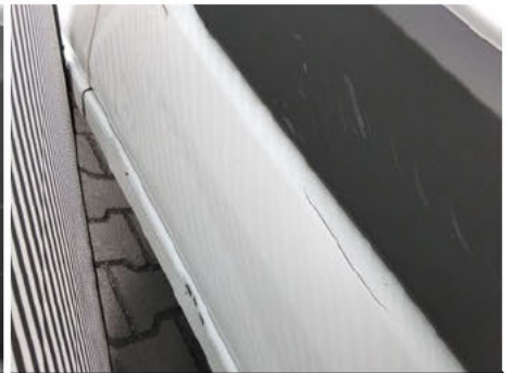
Tür / Rechts / Delle
