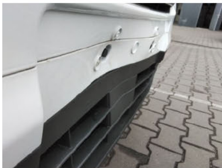
Stoßfänger unterhalb / Vorne / Gebrochen
