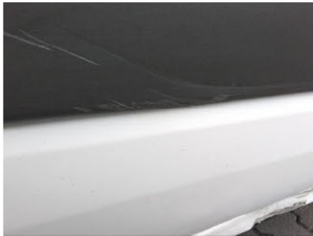
Türzierleiste / Rechts / Kratzer
