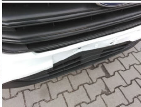
Stoßfänger unterhalb / Vorne / Gebrochen
