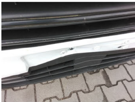
Stoßfänger oberhalb / Vorne / Gebrochen
