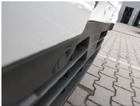
Stoßfänger unterhalb / Vorne / Gebrochen
