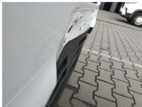
Stoßfänger oberhalb / Vorne / Gebrochen
