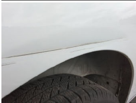
Seitenwand / Rechts / Delle
