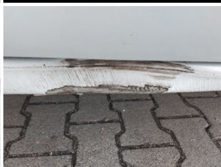
Schweller / Rechts / Delle
