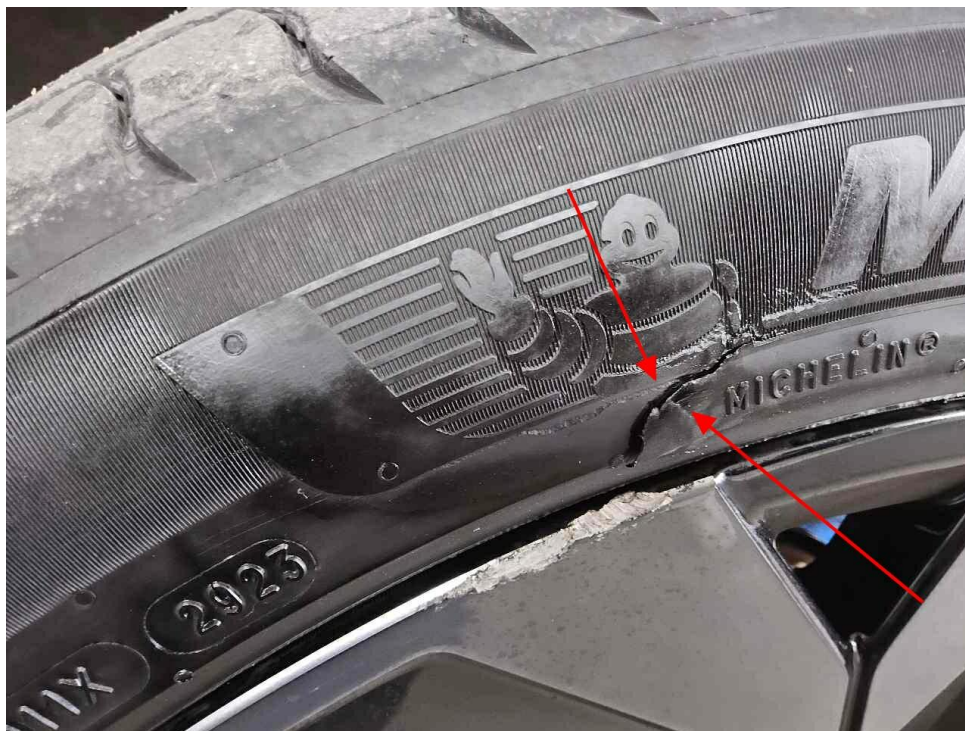
Bild 17 : Sommerreifen vorne links Flanke eingeschnitten
