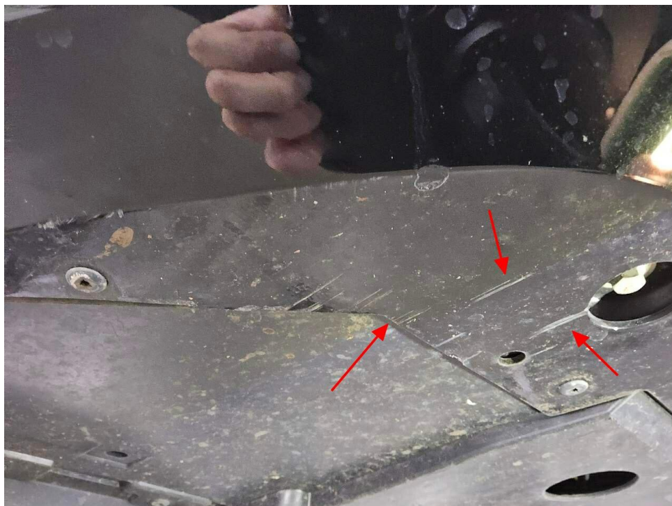
Bild 25 : Frontspoiler Lackierung, zerkratzt, lackieren mit Lackaufbau
