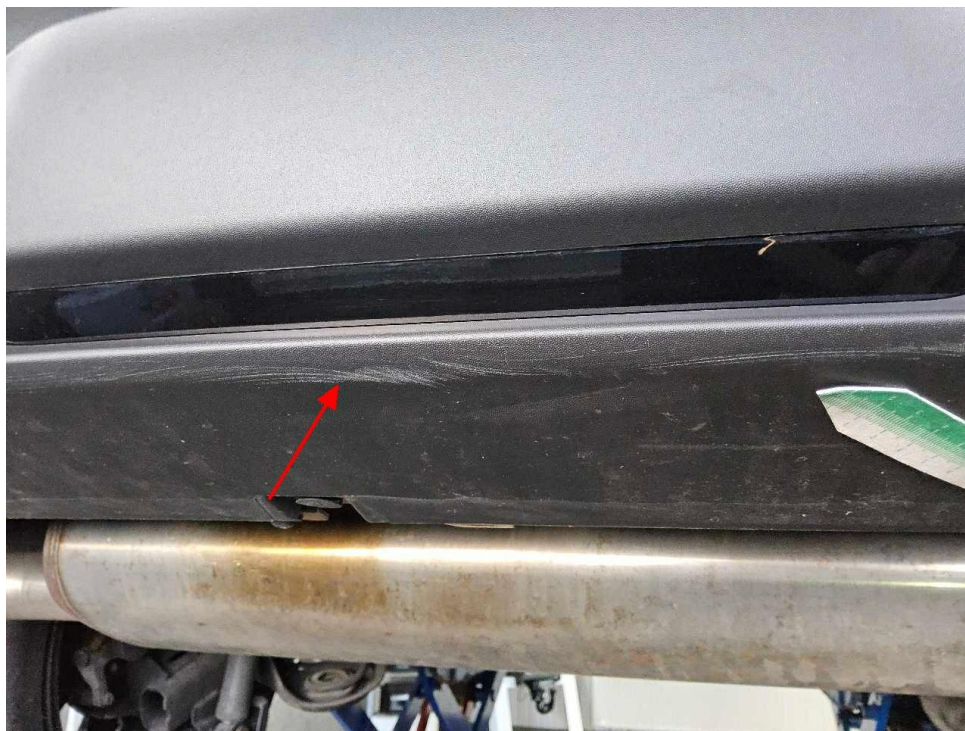
Bild 21 : Stoßfänger hinten Spoiler zerkratzt
