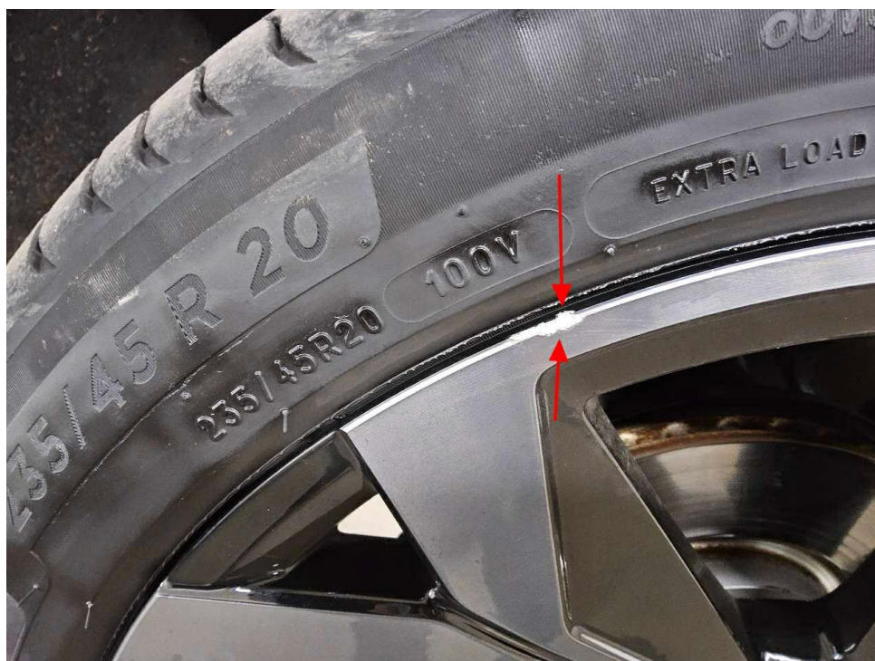
Bild 15 : Leichtmetallfelge vorne rechts mehrfach verschrammt
