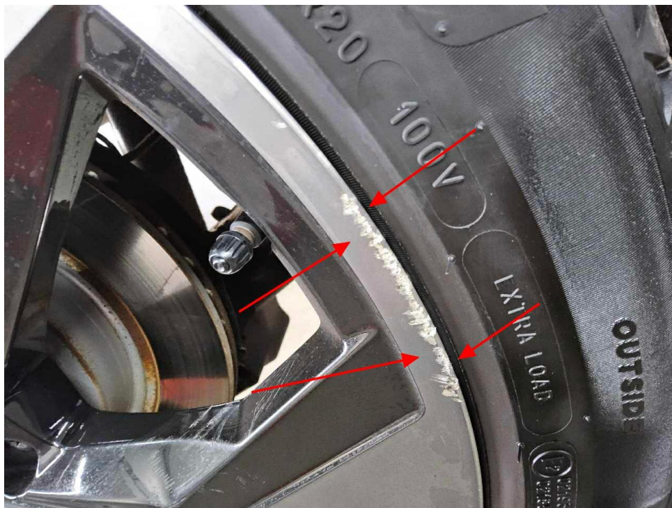
Bild 22 : Leichtmetallfelge hinten rechts zerkratzt
