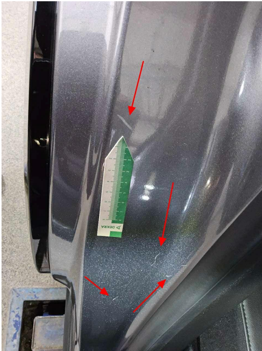
Bild 13 : Tür hinten rechts Einstieg Lackierung, zerkratzt, smart repair
