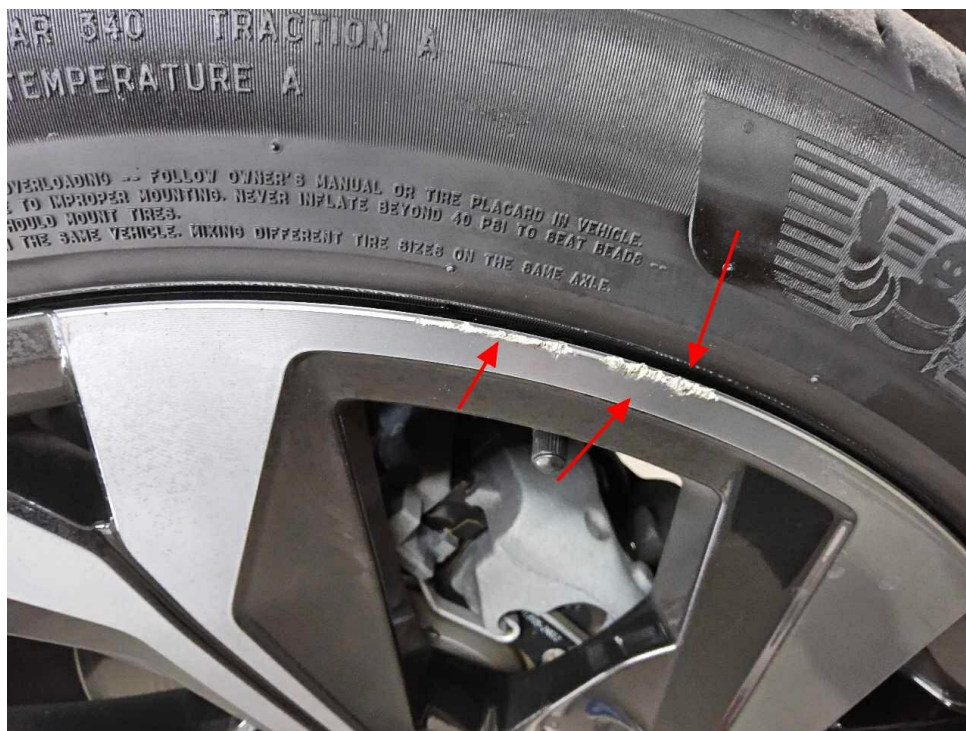
Bild 14 : Leichtmetallfelge vorne rechts mehrfach verschrammt
