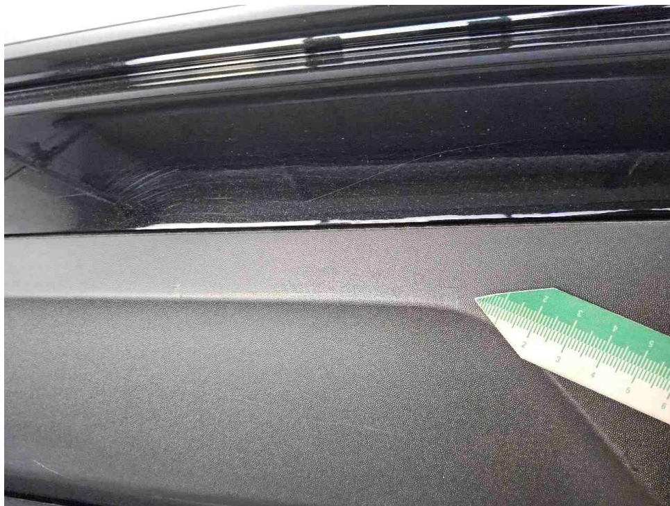
Bild 20 : Stoßfänger hinten Spoiler zerkratzt
