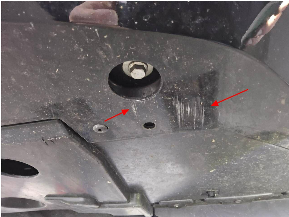
Bild 26 : Frontspoiler Lackierung, zerkratzt, lackieren mit Lackaufbau
