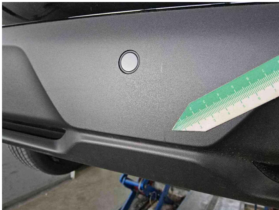
Bild 19 : Stoßfänger hinten Spoiler zerkratzt
