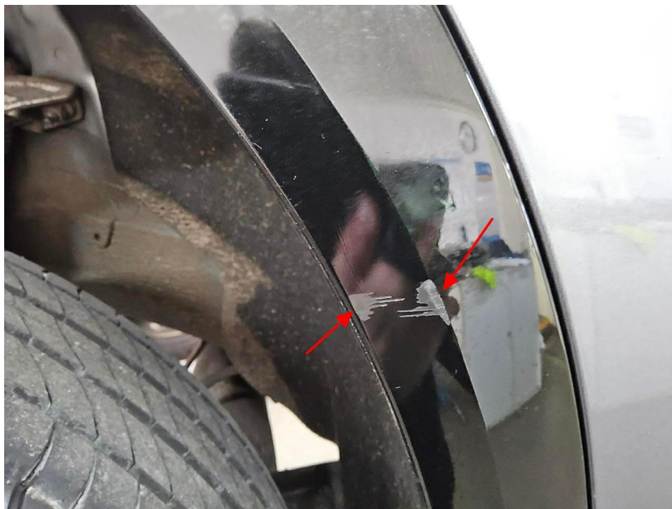
Bild 23 : Radlaufverkleidung hinten rechts zerkratzt
