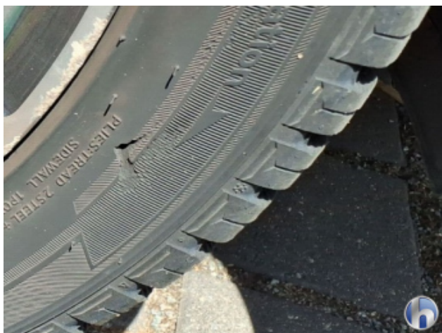
2. Reifen Vorne - Rechts Beschädigt - Erneuern
