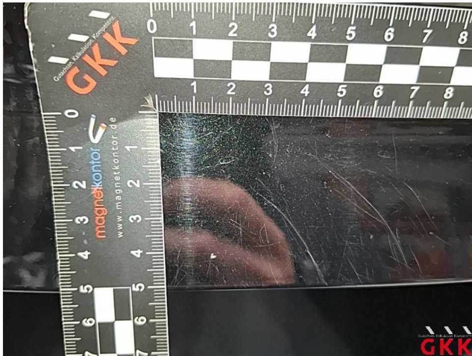
Bild 39. Heckklappe, verkratzt, Smartrepair
