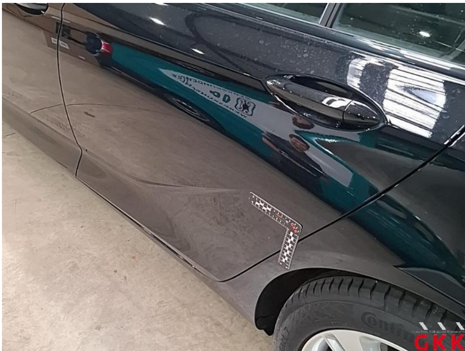
Bild 32. Tür hinten links, beschädigt, instand setzen - lackieren
