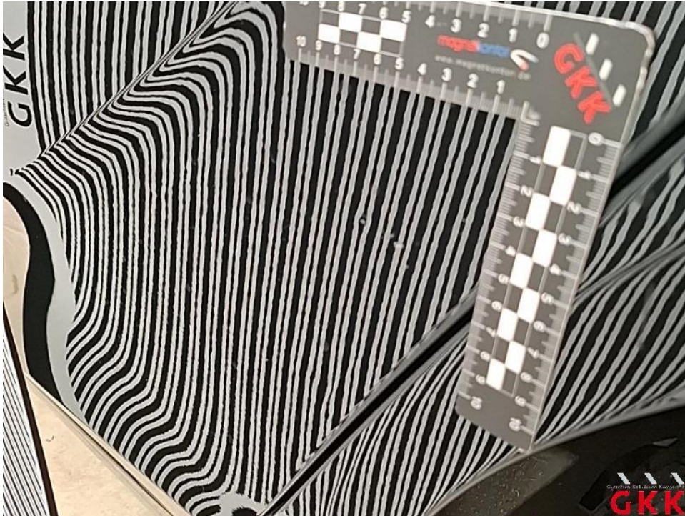
Bild 33. Tür hinten links, beschädigt, instand setzen - lackieren
