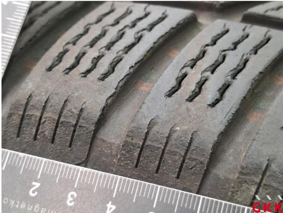
Bild 45. Reifen, 1 x beiliegend, porös, ersetzen
