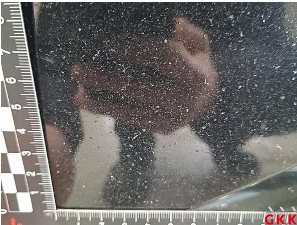
Bild 22. Stoßfänger vorne, Verkleidung -lackiert-, Steinschlag und Kratzer, lackieren
