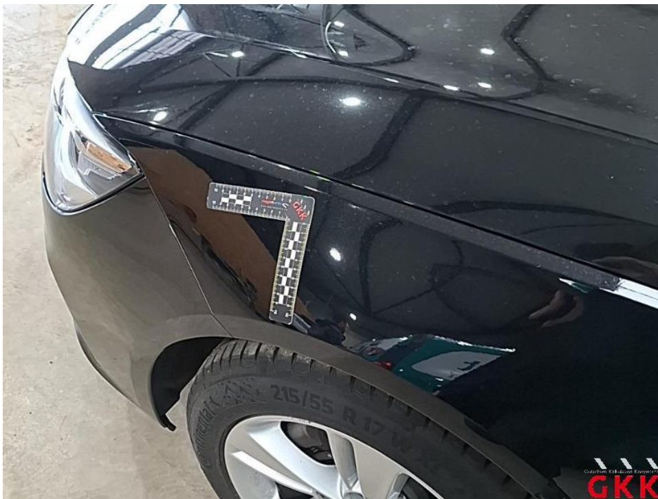
Bild 24. Kotflügel vorne links, verkratzt, auslegen, schleifen, polieren
