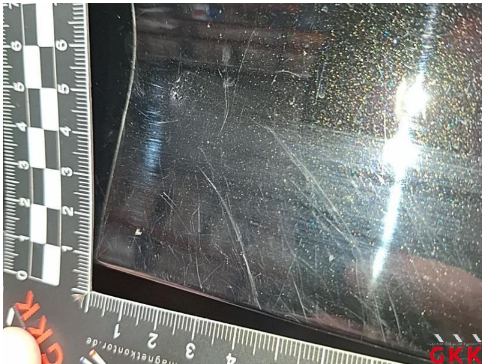
Bild 40. Heckklappe, verkratzt, Smartrepair
