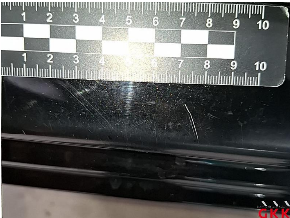
Bild 30. Tür vorne links, Einstieg, verkratzt, lackieren
