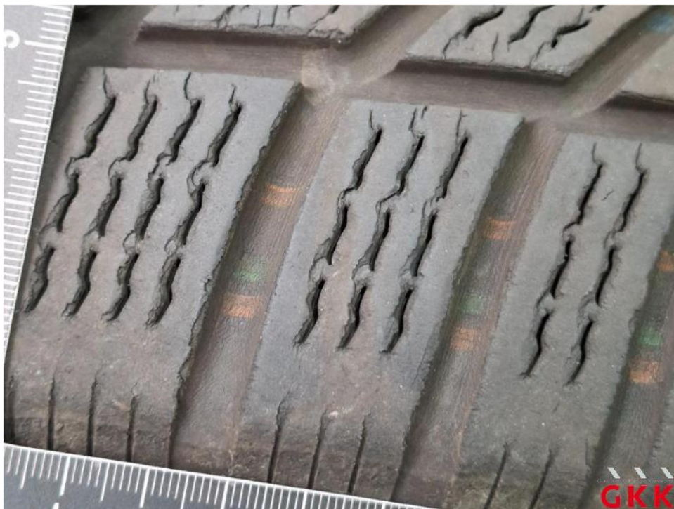
Bild 46. Reifen, 1 x beiliegend, porös, ersetzen
