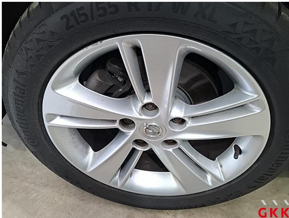
Bild 26. LM-Rad, vorne links, Materialabtrag, ersetzen
