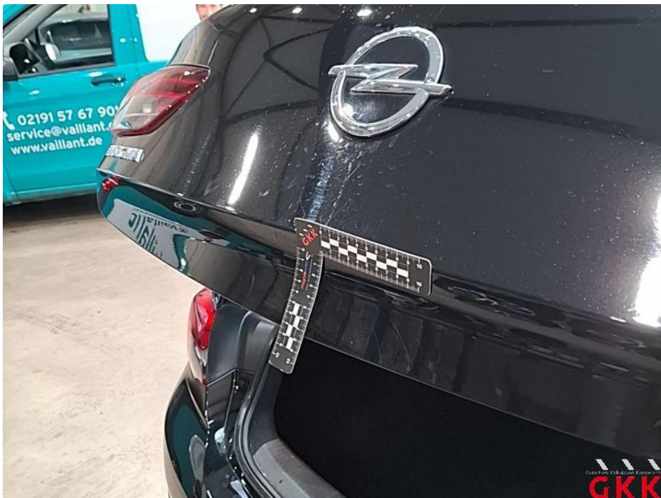
Bild 38. Heckklappe, verkratzt, Smartrepair
