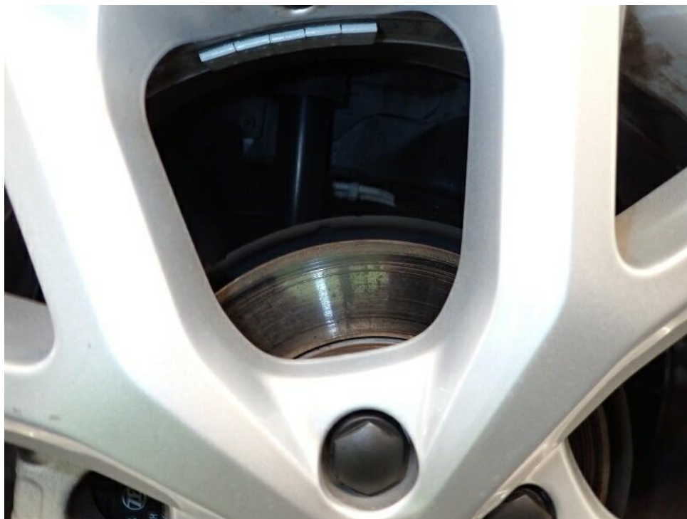
Bild 17 : Bremsscheiben beginnende Oxidation
