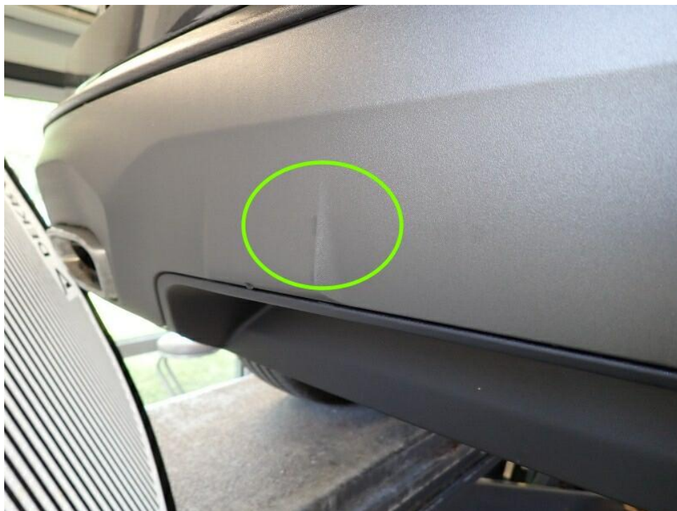
Bild 13 : Blende Stoßfänger hinten verschmutzt/Abrieb, peinigen, prüfen
