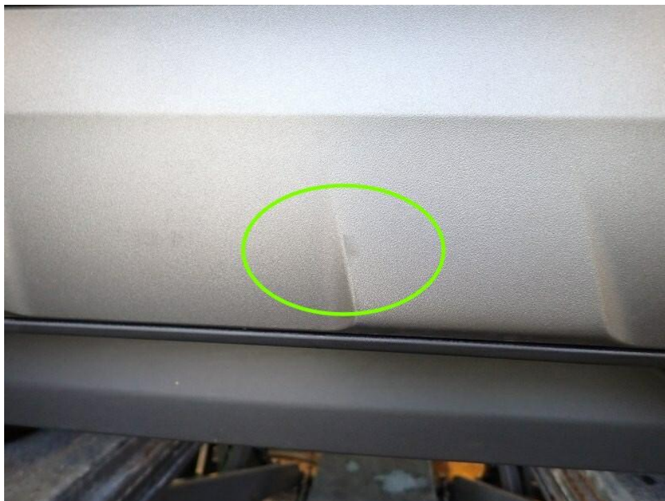
Bild 14 : Blende Stoßfänger hinten verschmutzt/Abrieb, peinigen, prüfen
