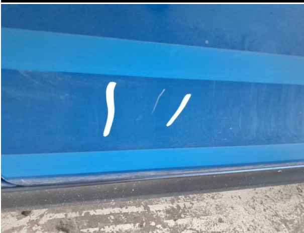
Beschädigung #11: Tür vorn rechts: Tür - Delle / Lackschaden - instandsetzen und lackieren
