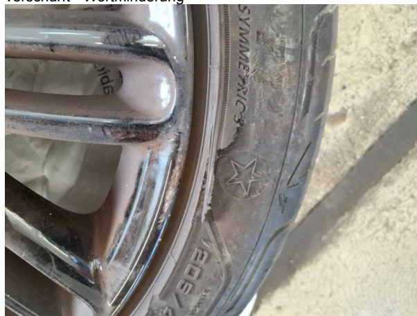
Beschädigung #5: 2.Radsatz: 1 Reifen - beschädigt - erneuern
