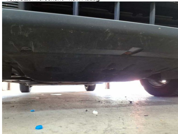
Beschädigung #3: Stossfänger vorn: Spoiler - verkratzt / verschürft - Wertminderung
