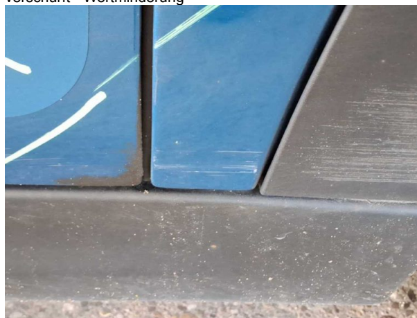
Beschädigung #7: Kotflügel rechts: Kotflügel rechts - verkratzt / verschürft - instandsetzen und lackieren
