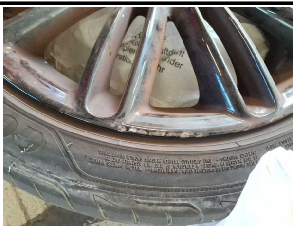
Beschädigung #6: 2.Radsatz: 3 Leichtmetallfelgen - verkratzt... verschürft - Wertminderung
