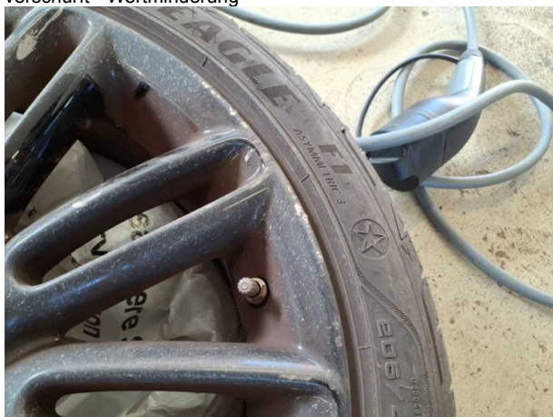
Beschädigung #6: 2.Radsatz: 3 Leichtmetallfelgen - verkratzt / verschürft - Wertminderung
