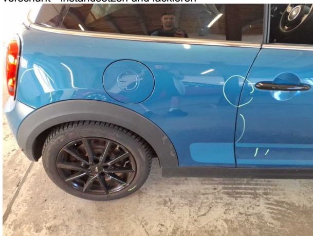
Beschädigung #10: Seitenwand rechts: Seitenwand - verkratzt / verschürft - instandsetzen und lackieren
