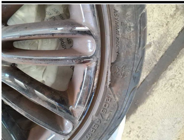
Beschädigung #6: 2.Radsatz: 3 Leichtmetallfelgen - verkratzt / verschürft - Wertminderung
