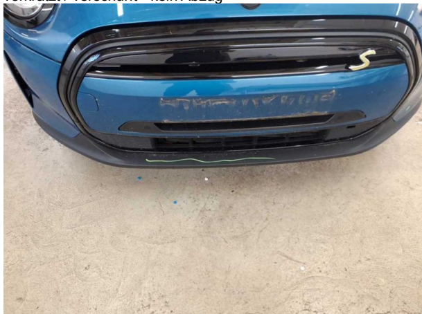
Beschädigung #3: Stossfänger vorn: Spoiler - verkratzt / versch... - Wertminderung
