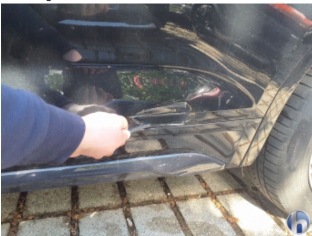
6. Tür Hinten - Links Beschädigt - Instandsetzen und Lackieren
