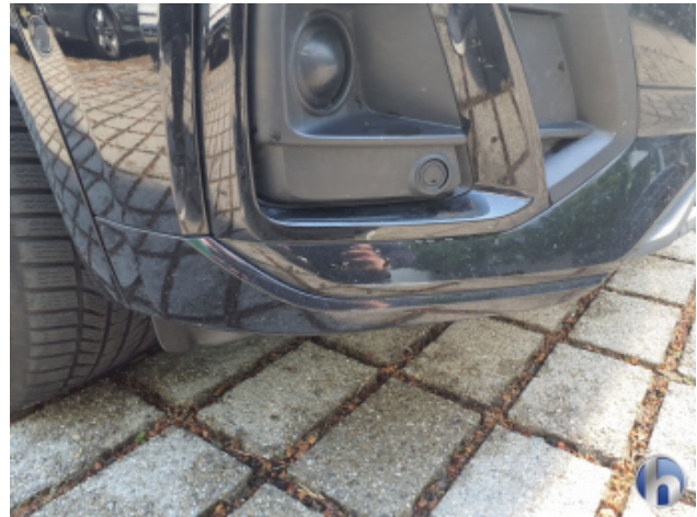
3. Stoßfänger Vorne Beschädigt - Instandsetzen und Lackieren
