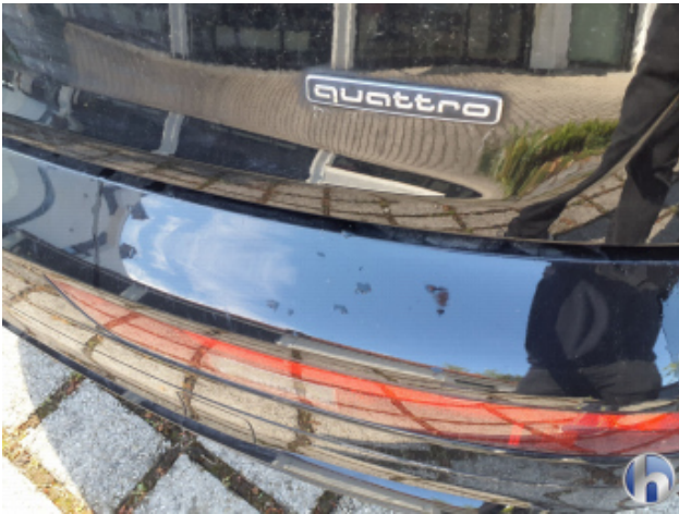
4. Stoßfänger Hinten Kratzer - Lackieren
