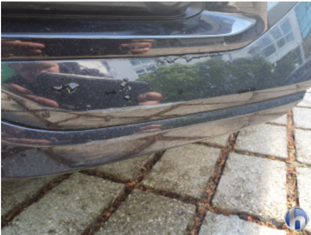
3. Stoßfänger Vorne Beschädigt - Instandsetzen und Lackieren
