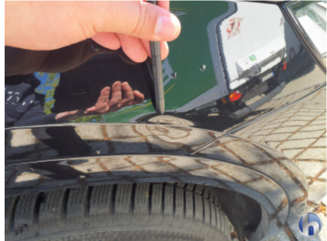
10. Kotflügel Vorne - Rechts Verdellt - Sanft Instandsetzen
