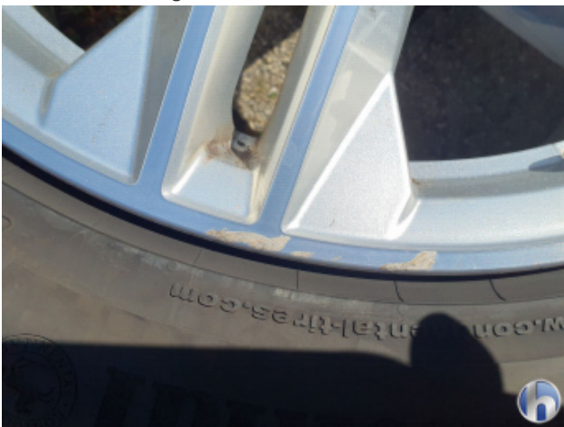
14. Zusätzlicher Radsatz Felge Außen rechts vorne Kratzer - Smart Repair
