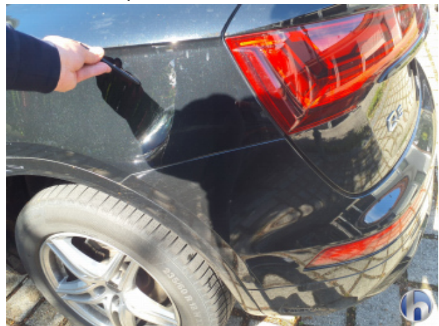
1. Seitenwand - Hinten - Links Kratzer - Smart Repair
