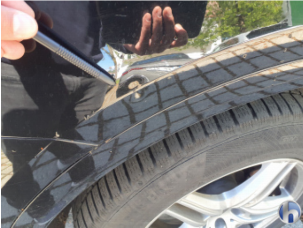
9. Seitenwand - Hinten - Rechts Verdellt - Instandsetzen und Lackieren
