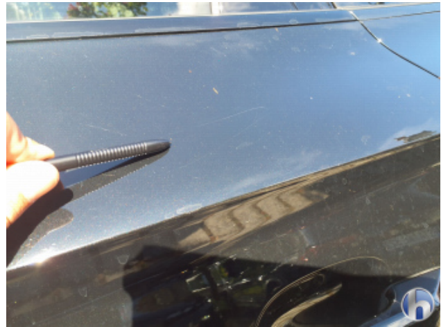
5. Tür Hinten - Links Beschädigt - Instandsetzen und Lackieren
