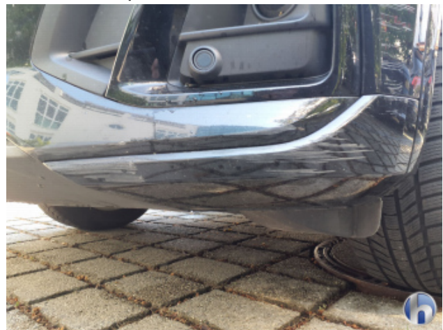
3. Stoßfänger Vorne Beschädigt - Instandsetzen und Lackieren
