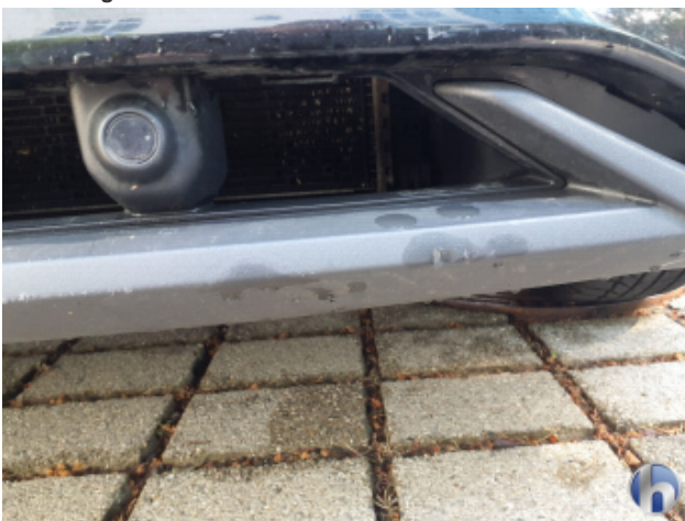
3. Stoßfänger Vorne Beschädigt - Instandsetzen und Lackieren
