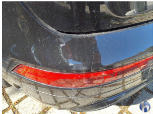
4. Stoßfänger Hinten Kratzer - Lackieren
