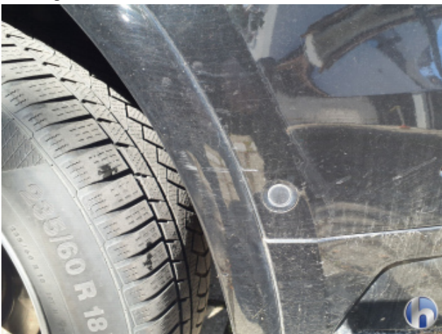
1. Seitenwand - Hinten - Links Kratzer - Smart Repair
