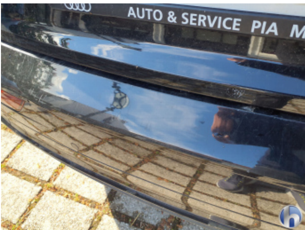
4. Stoßfänger Hinten Kratzer - Lackieren
