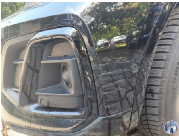
3. Stoßfänger Vorne Beschädigt - Instandsetzen und Lackieren
