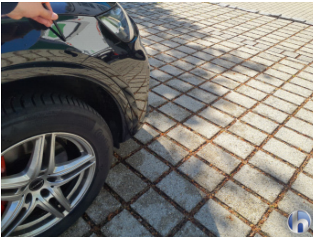
10. Kotflügel Vorne - Rechts Verdellt - Sanft Instandsetzen
