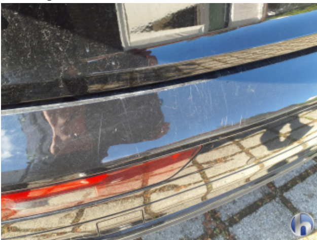
4. Stoßfänger Hinten Kratzer - Lackieren
