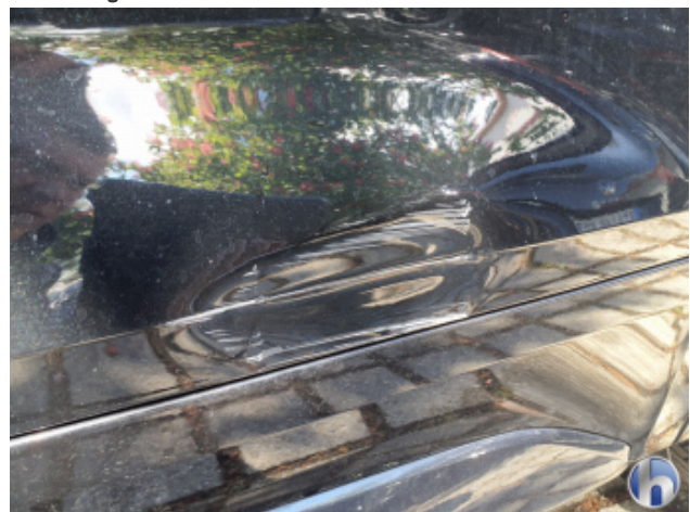
6. Tür Hinten - Links Beschädigt - Instandsetzen und Lackieren
