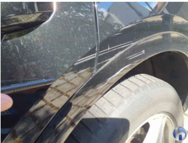
5. Tür Hinten - Links Beschädigt - Instandsetzen und Lackieren
