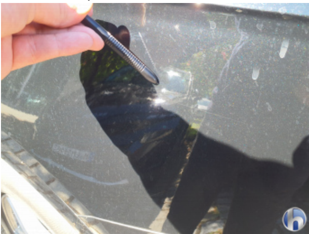
1. Seitenwand - Hinten - Links Kratzer - Smart Repair
