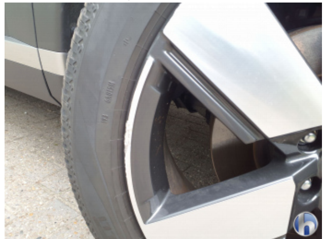
5. Felge Vorne - Rechts Unfallschaden - Smart Repair
