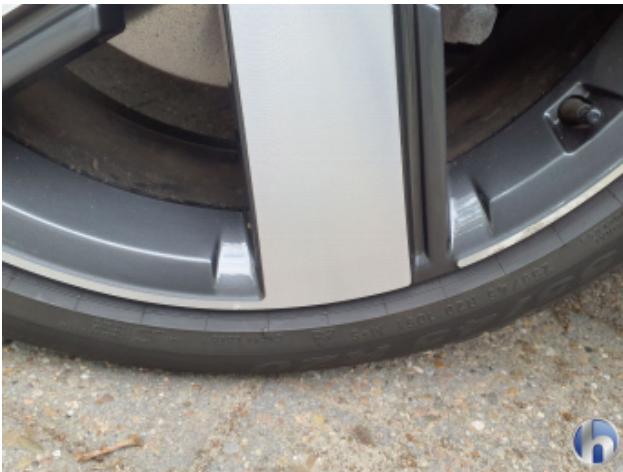
5. Felge Vorne - Rechts Unfallschaden - Smart Repair
