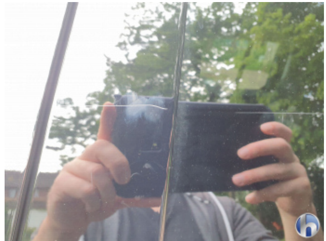
8. B-Säule Mitte - Links Beschädigt - Erneuern
