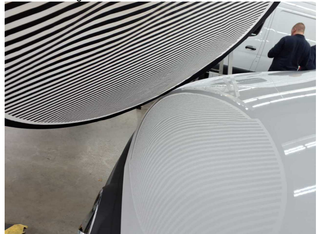
Beschädigung #6: Motorhaube: Motorhaube - Delle(n) - Smart Repair
