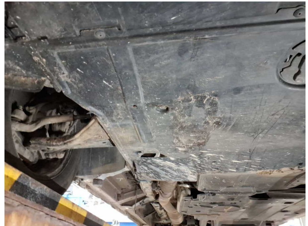
Beschädigung #4: Motor: Motorverkleidung unten - gebrochen / gerissen - erneuern
