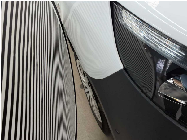
Beschädigung #19: Kotflügel rechts: Kotflügel rechts - verformt - erneuern
