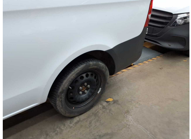
Beschädigung #2: Rad/Reifen: Radblende hinten links - fehlt - erneuern
