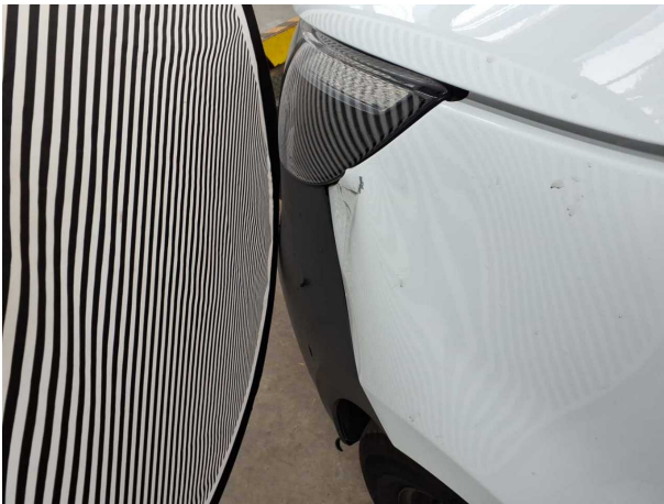
Beschädigung #18: Kotflügel links: Kotflügel links - verformt - erneuern
