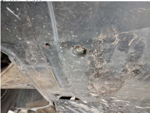
Beschädigung #4: Motor: Motorverkleidung unten - gebrochen / gerissen - erneuern
