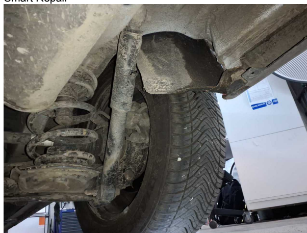
Beschädigung #12: Hinterachse: Stoßdämpfer rechts - beschädigt - erneuern
