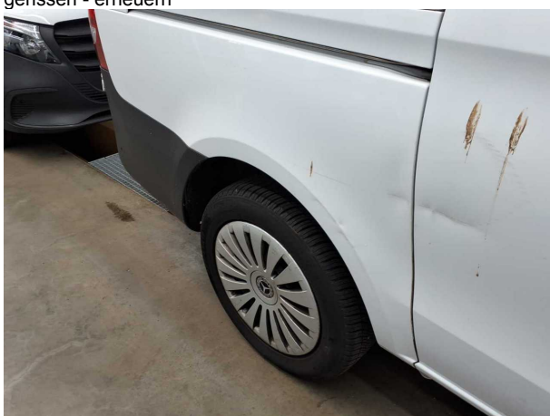
Beschädigung #23: Seitenwand rechts: Seitenwand - Delle / Lackschaden - instandsetzen und lackieren
