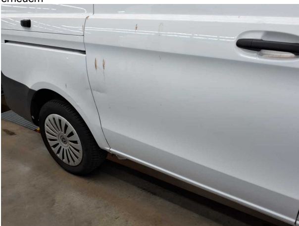
Beschädigung #20: Schiebetür rechts: Schiebetür - Delle / Lackschaden - instandsetzen und lackieren
