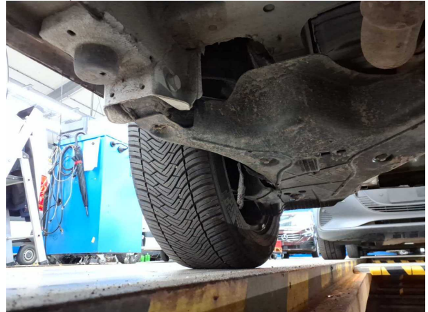
Beschädigung #9: Verkleidungen/Abdeckungen: Verkleidungen/ Abdeckungen - gebrochen / gerissen - erneuern
