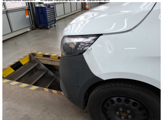
Beschädigung #18: Kotflügel links: Kotflügel links - verformt - erneuern
