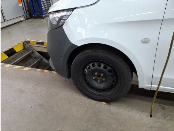
Beschädigung #1: Rad/Reifen: Radblende vorn links - fehlt - erneuern
