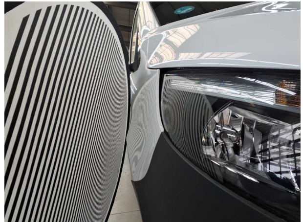
Beschädigung #19: Kotflügel rechts: Kotflügel rechts - verformt - erneuern
