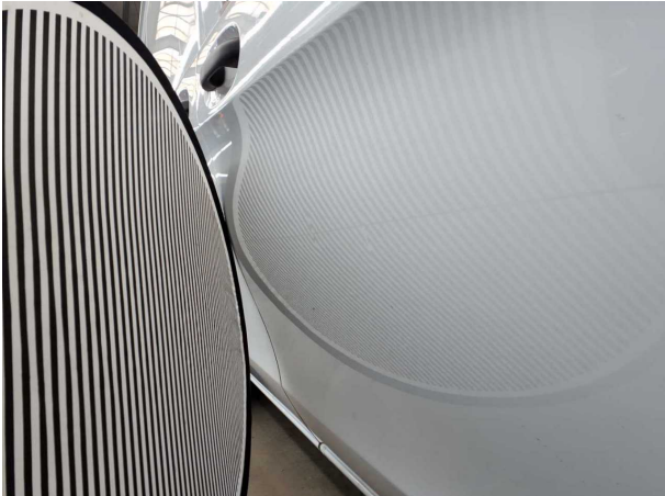
Beschädigung #8: Tür vorn rechts: Tür - Delle / Lackschaden - Smart Repair
