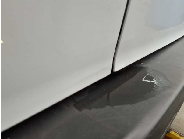
Beschädigung #15: Heckklappe/-tür: Hecktür rechts (und links) - Delle / Lackschaden - Smart Repair
