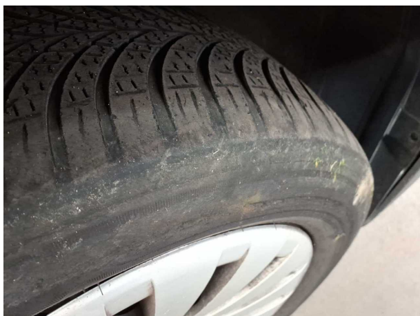
Beschädigung #10: Rad/Reifen: Reifen vorn rechts - verschlissen - erneuern
