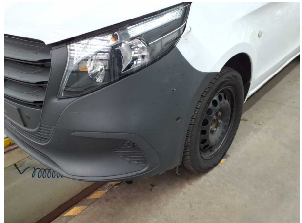
Beschädigung #22: Stossfänger vorn: Stossfänger vorn - gebrochen / gerissen - erneuern
