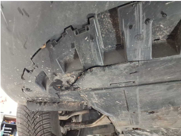
Beschädigung #3: Motor: Motorverkleidung unten vorn - gebrochen / gerissen - erneuern
