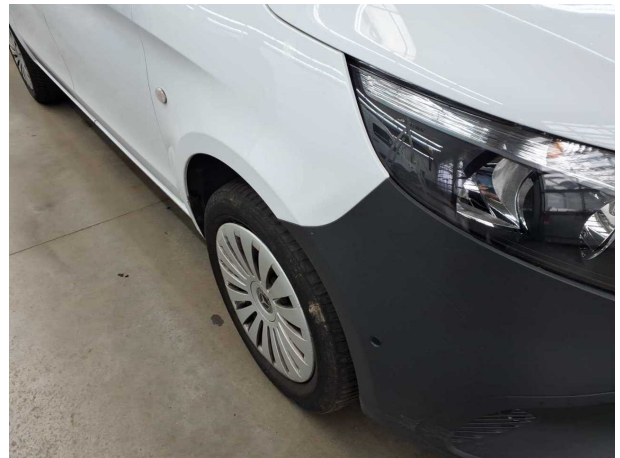
Beschädigung #19: Kotflügel rechts: Kotflügel rechts - verformt - erneuern
