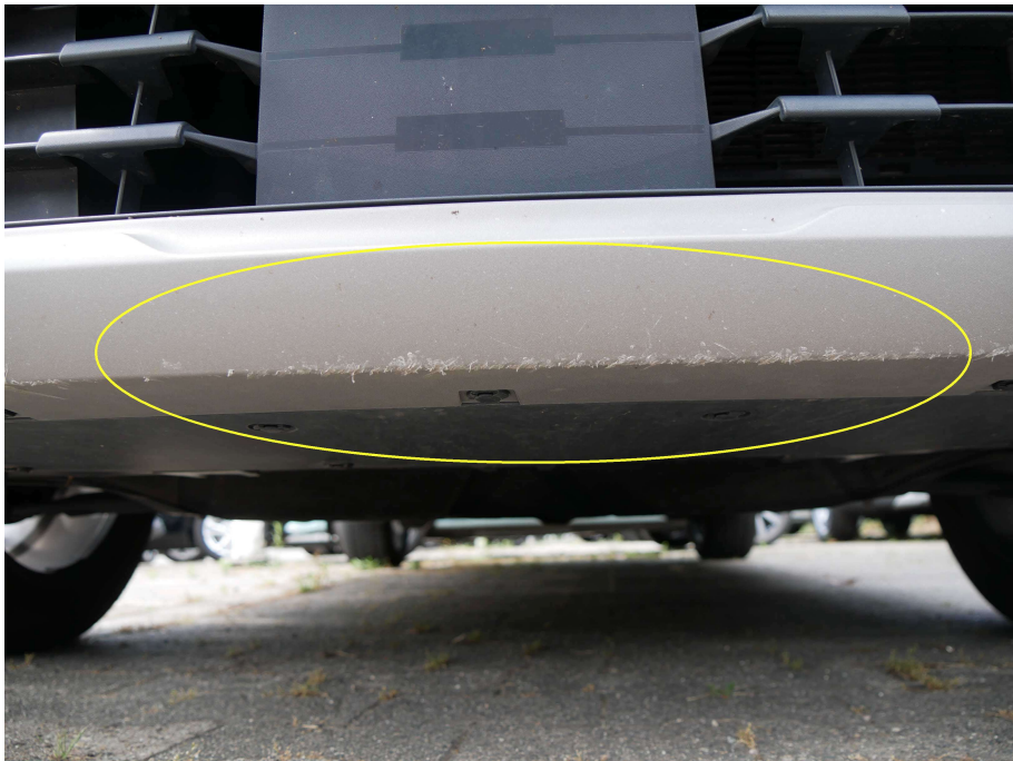
Bild 22 Stoßfänger VU verschrammt.
