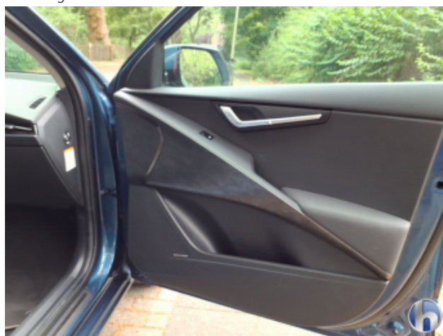
1. Verkleidung Beschädigt - Erneuern
